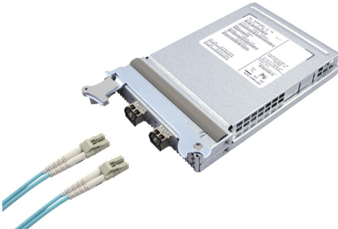
2. Connectez l'autre extrémité du câble ou des câbles au commutateur FCoE.
