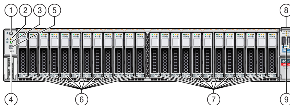
Figura 3.2. Configuración del panel frontal con veinticuatro unidades de 2,5 pulgadas
