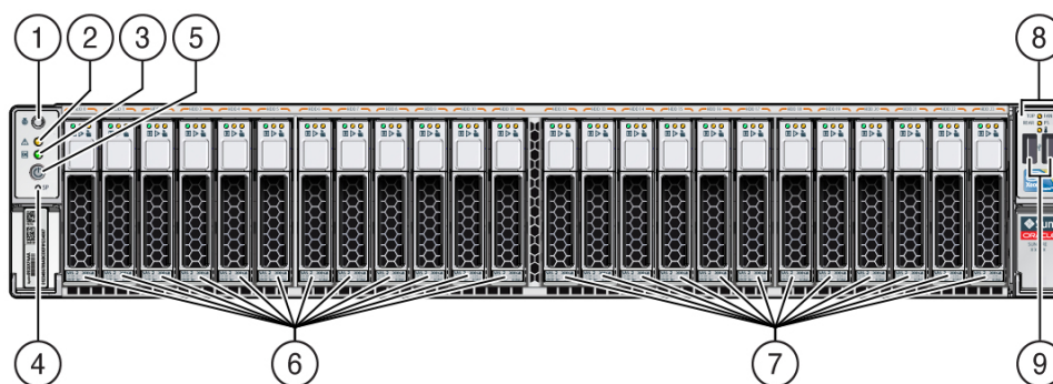
Figure 3.2. Panneau avant de serveur configuré avec vingt-quatre unités 2,5 pouces
