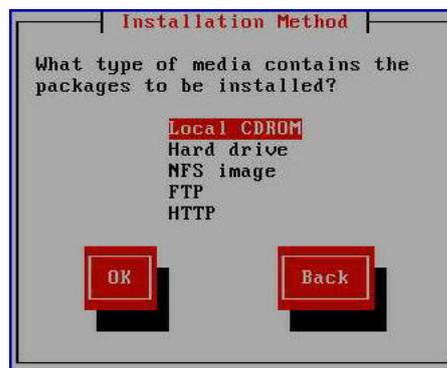
8. 「Installation Method」画面で、適切なインストール方法（「Local CDROM」または「NFS image」）を選択し、「OK」をクリックします。「Disc Found」画面が表示されます。
