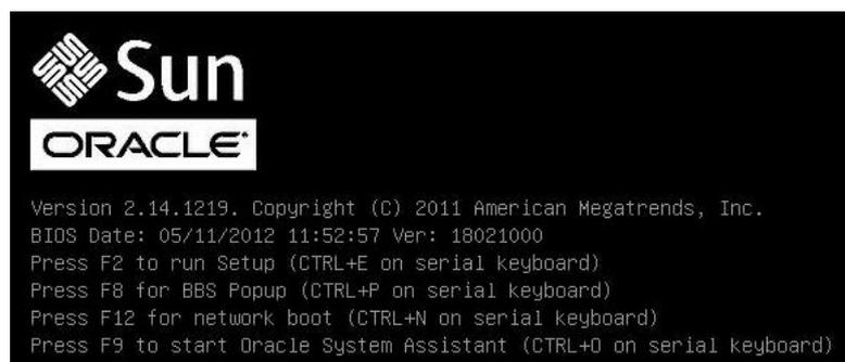
2. BIOS 画面でプロンプトが表示されたら、F2 を押して BIOS 設定ユーティリティにアクセスします。
