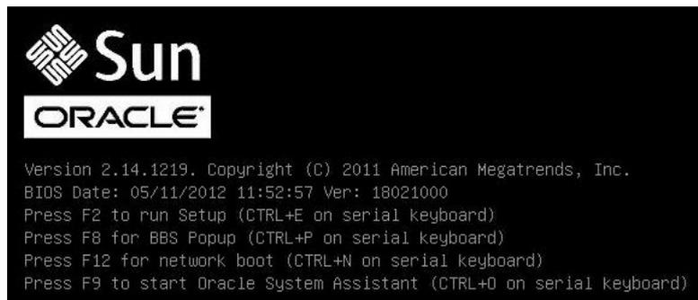
3. BIOS 画面で、F8 キーを押して、Linux OS のインストールで使用する一時ブートデバイスを指定します。
