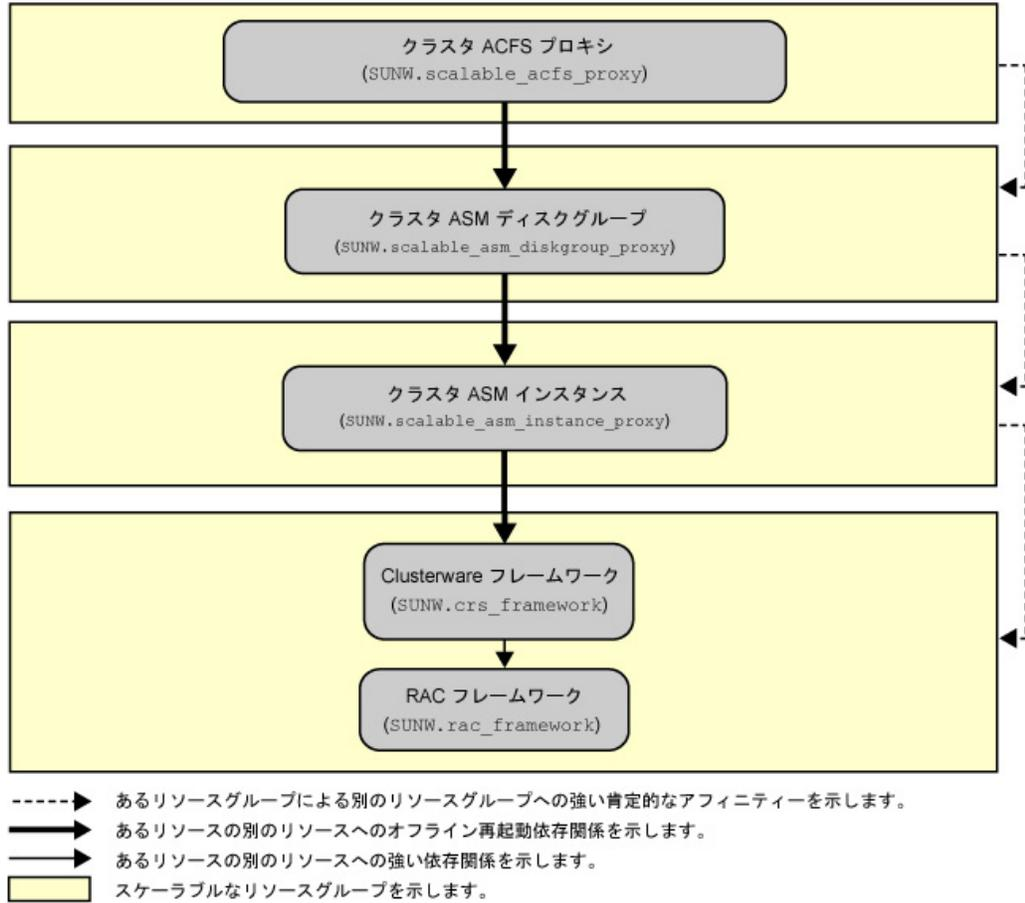
図 5-3 Solaris Volume Manager を使用したゾーンクラスタでの Oracle ACFS の構成
