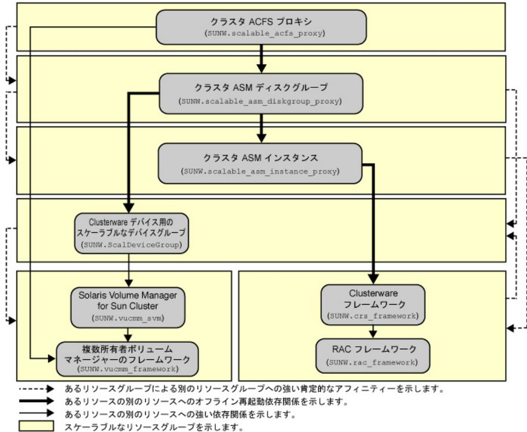
図 5-2 ハードウェア RAID を使用した大域ゾーンでの Oracle ACFS の構成
