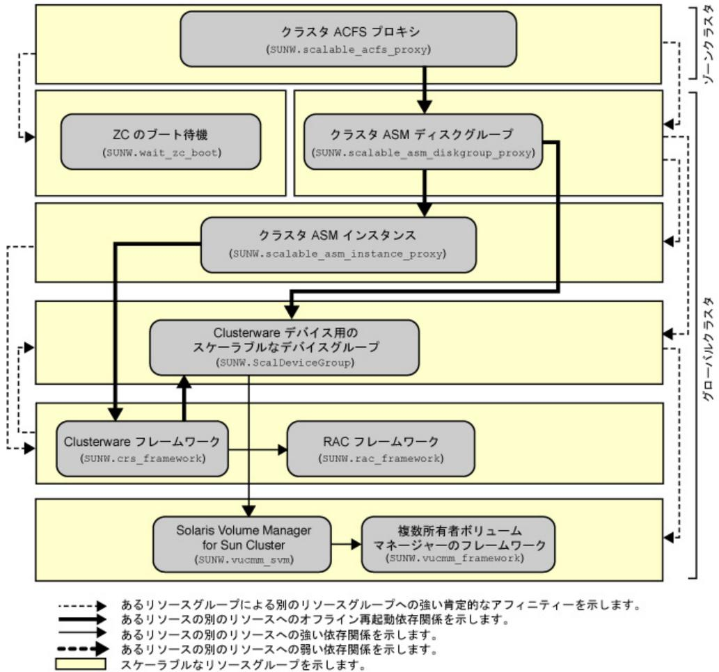
図 5-4 ハードウェア RAID を使用したゾーンクラスタでの Oracle ACFS の構成
