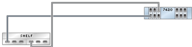
fig. 4 Contrôleur autonome avec six HBA et une étagère de disques dans une chaîne unique.
