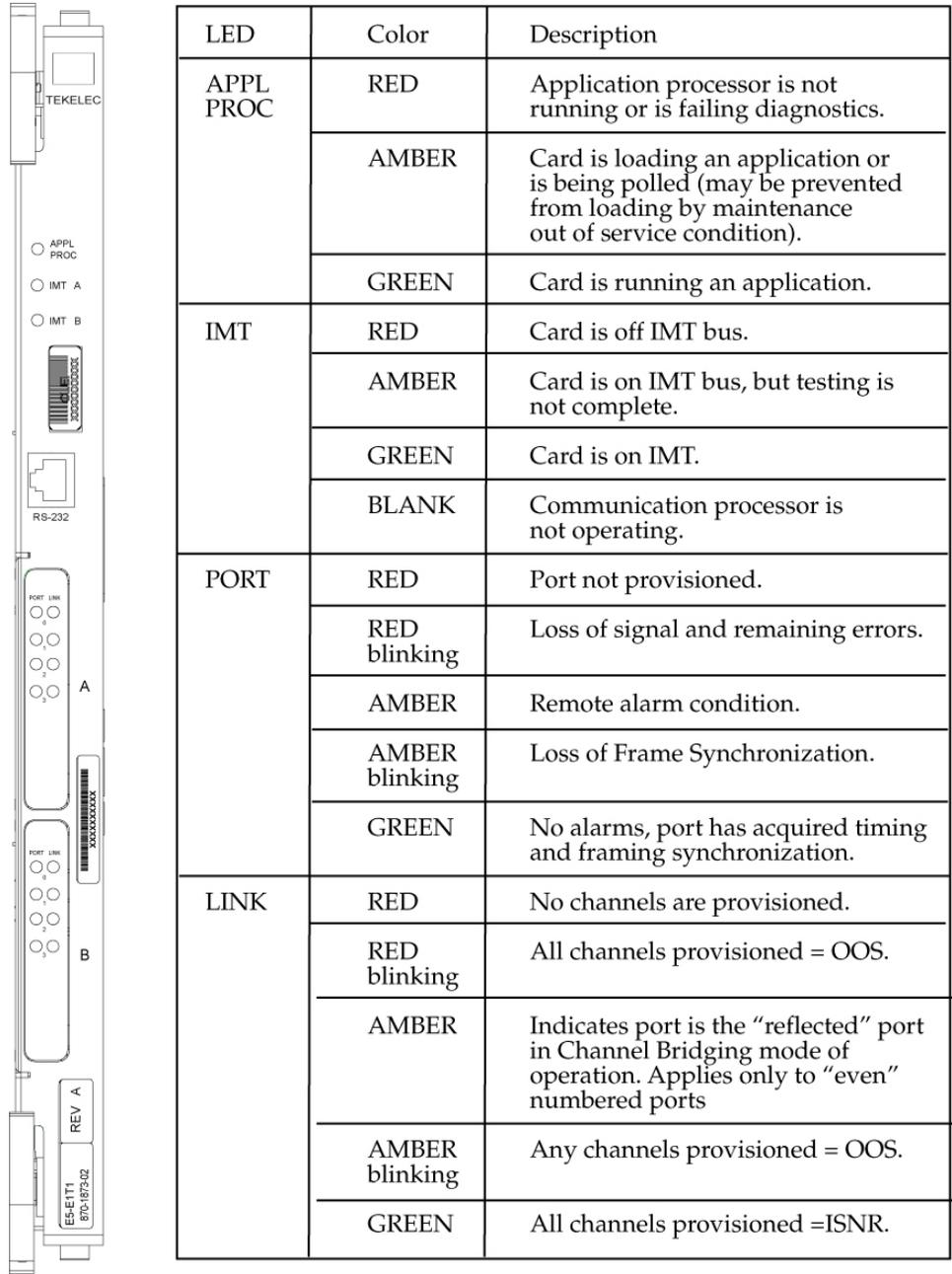
Figure 138: E5-E1T1 Interface Module
