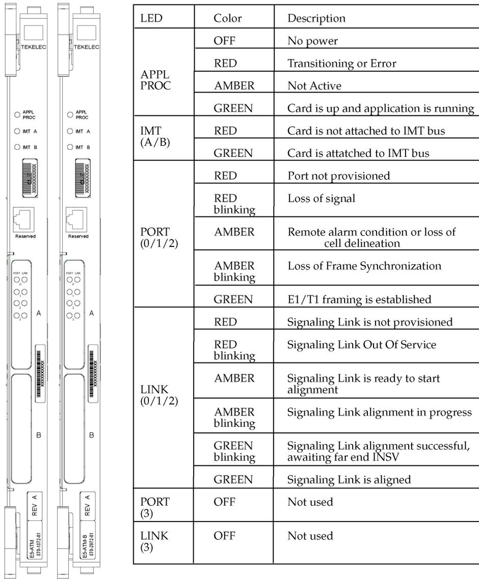
Figure 137: E5-ATM/E5-ATM-B Interface Module
