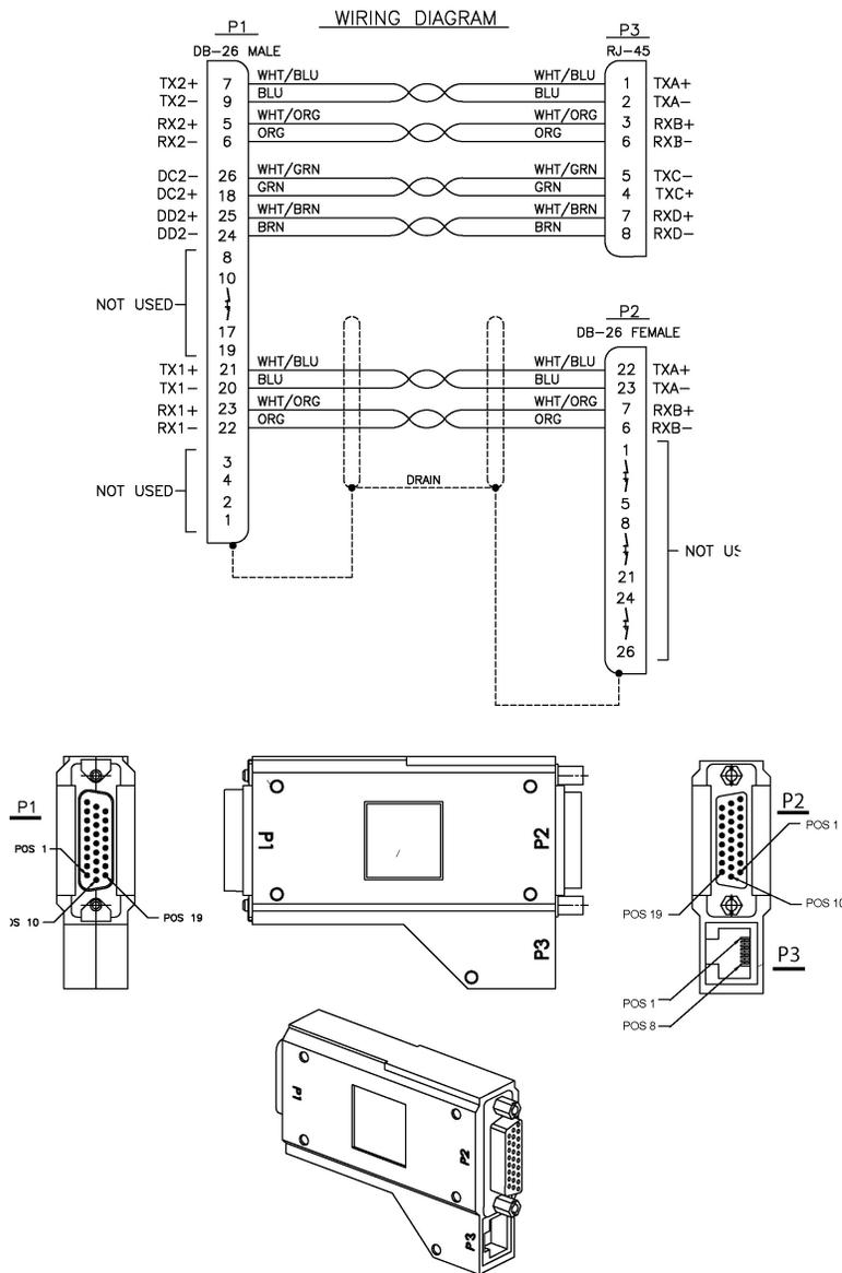
Figure 215: E5-ENET FAST COPY ADAPTER, LOWER, P/N 830-1343-02
