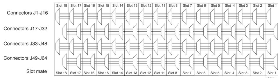
**Figure 125: E1/T1 Interface Backplane Connector Diagram**
