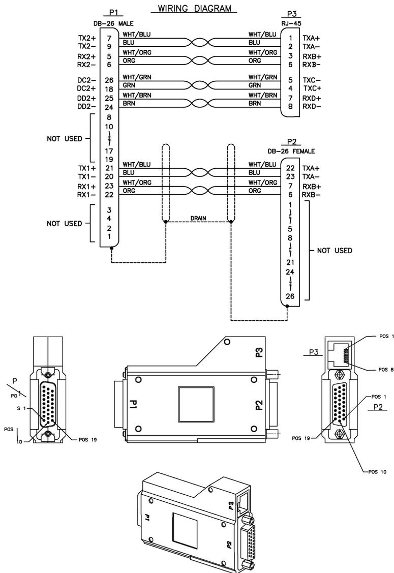
Figure 216: E5-ENET FAST COPY ADAPTER, UPPER, P/N 830-1343-01
