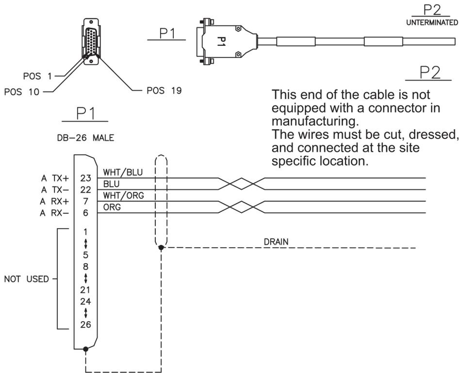
**Figure 207: DCM, 100-BASE TX Interface**
