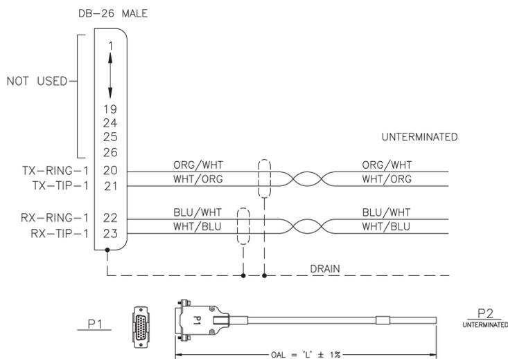
Figure 209: DS1 Cable DS1 Cable
