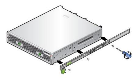
5. Si utiliza un armario universal de 19 pulgadas, coloque una tuerca prisionera M6 cuadrada en el orificio superior e inferior de la ubicación en la que instalará la placa de las guías, como se muestra en el gráfico.
