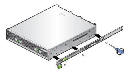
3. En el siguiente gráfico, se muestra cómo fijar los soportes de montaje 7420.
