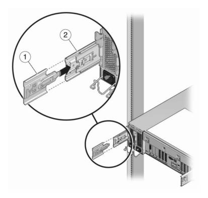
2. Inserte el conector del soporte de montaje del organizador de cables en la guía deslizante derecha hasta que el conector encaje en su sitio.
