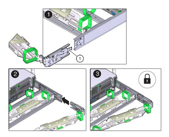
11. Para preparar el conector D para la instalación, quite la cinta que sujeta el soporte de ajuste de la guía deslizante al conector D y asegúrese de que el soporte de ajuste esté correctamente alineado con el conector D (cuadros 1 y 2).
