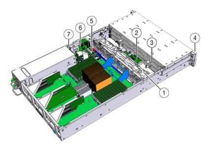
FIGURA 1-34 Componentes de distribución de energía
