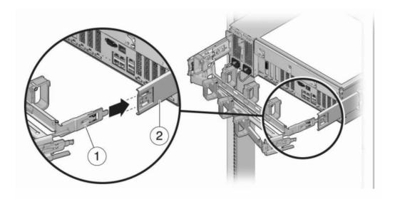
3. Inserte el conector derecho de la guía deslizante del organizador de cables (1) en el conjunto de la guía deslizante derecha (2) hasta que el conector encaje en su sitio.
