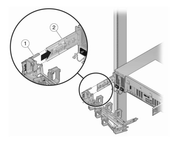
5. Tras instalar y colocar los cables en el conjunto, conecte las correas de enganche (1) para fijar los cables. Luego, fije los pasadores externos derecho e izquierdo para sostener el conjunto.
