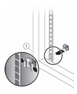
2. Coloque un conjunto de guías deslizantes en el bastidor de manera que los soportes ubicados en cada extremo del conjunto de guías deslizantes queden en la parte exterior de los postes delantero y trasero del bastidor. En el siguiente gráfico, se muestran los soportes del conjunto de guías.
