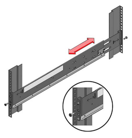
3. Si utiliza un armario universal de 19 pulgadas roscado: a) Utilice el destornillador Torx T20 para quitar los tornillos de fijación de la parte frontal y posterior de las guías. b) Utilice la llave inglesa suministrada para insertar dos clavijas en cada extremo de las guías, en la misma ubicación en que se
