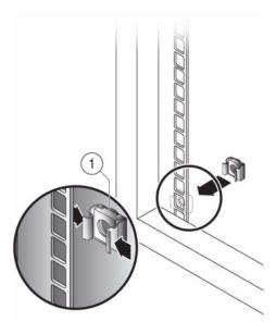
6. Coloque un conjunto de guías deslizantes en el bastidor de manera que los soportes ubicados en cada extremo del conjunto de guías deslizantes queden en la parte exterior de los postes delantero y trasero del bastidor. En el siguiente gráfico, se muestran los soportes del conjunto de guías.
