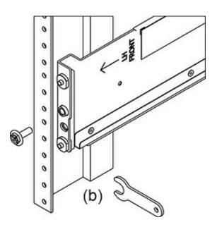
4. Con la ayuda de un dispositivo de elevación mecánico o de *dos* personas, una en cada lado del estante de discos, levante con cuidado el estante y apóyelo en el reborde inferior de las guías izquierda y derecha. No lo levante con las manillas de la fuente de alimentación con módulo de ventiladores.
