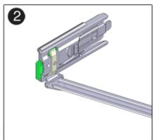
12. Sostenga el soporte de ajuste de la guía deslizante en su lugar e inserte el conector D y el soporte de ajuste de la guía deslizante asociado en la guía deslizante izquierda hasta que el conector D se acople en su lugar con un chasquido (cuadros 1 y 2). Al insertar el conector D en la guía deslizante, el método preferido y más sencillo es instalar el conector D y el soporte de ajuste como una pieza en la guía deslizante.
