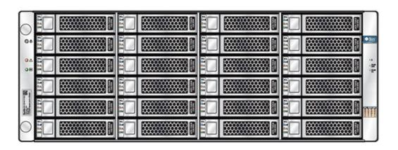
Sun Disk Shelf es un chasis 4U que admite 24 unidades SAS-2 de 3,5". Las SSD ofrecen operaciones de escritura aceleradas, y las HDD de alta capacidad proporcionan un almacenamiento fiable. Este estante de discos incluye placas de módulo de interfaz SAS (SIM) redundantes dobles y una fuente de alimentación doble con módulos de ventiladores.
