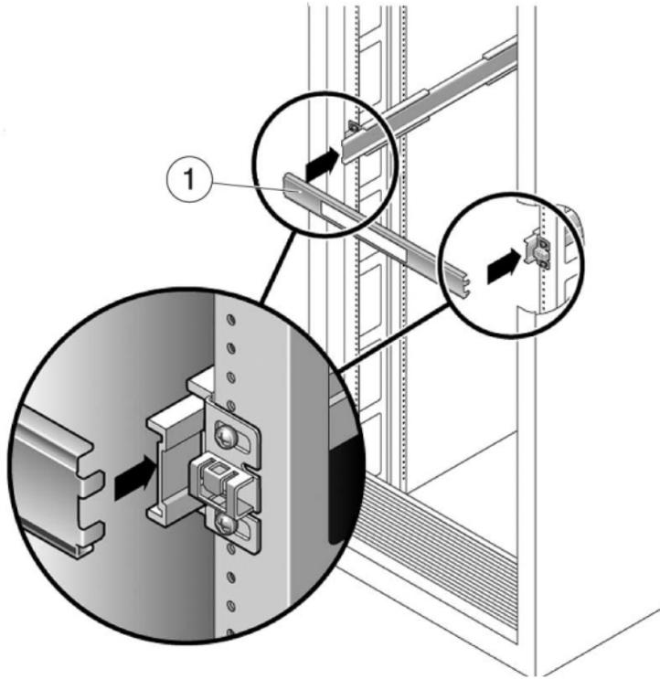
5. **Serrez les vis sur les crochets.**
