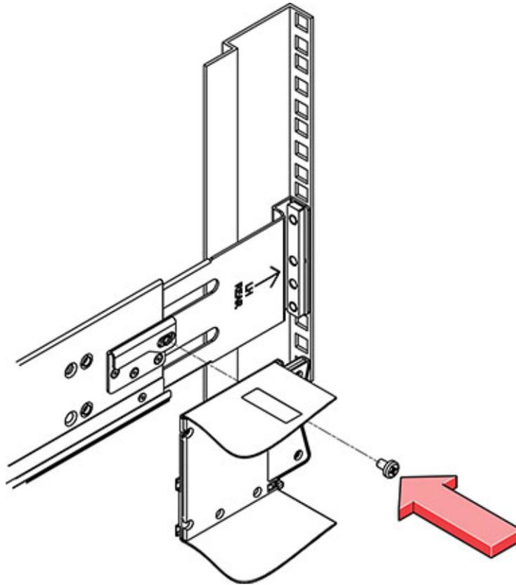
7. Retirez les capuchons latéraux avant, installez une vis de chaque côté et remplacez les capuchons.
