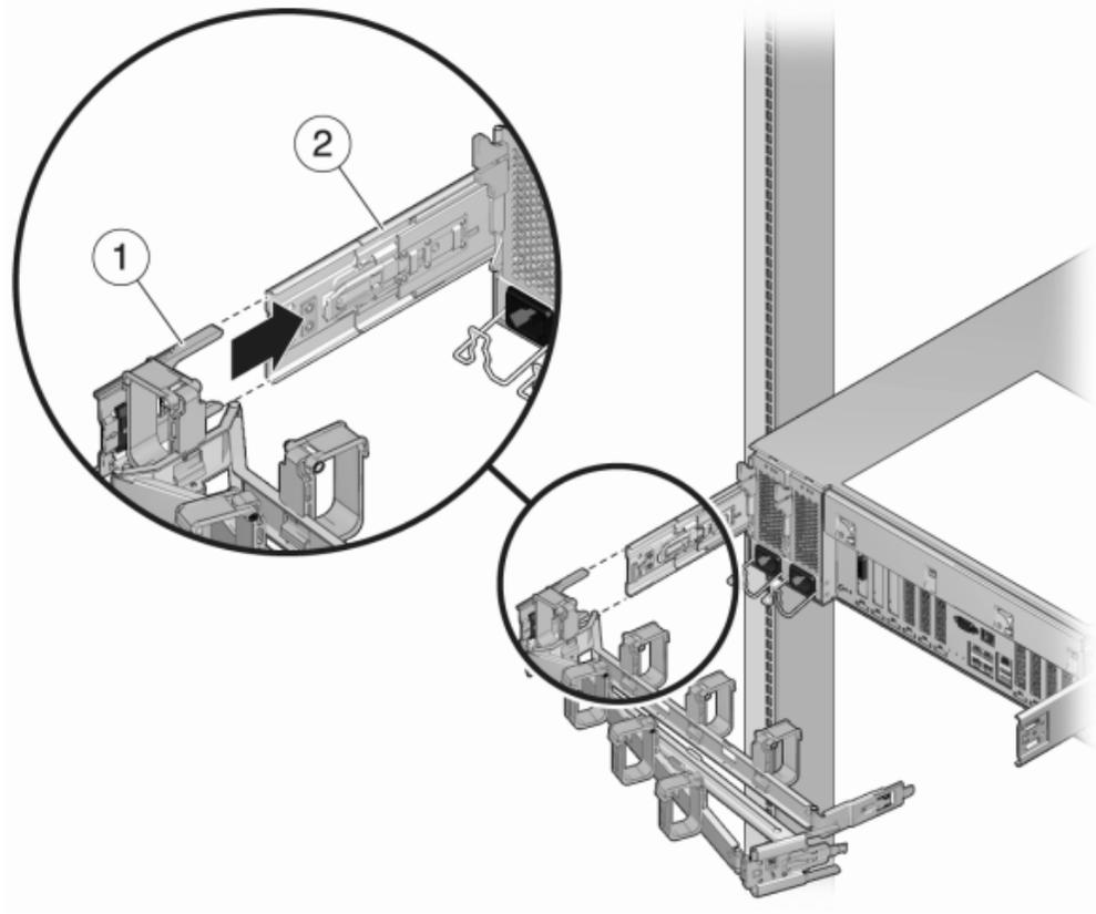
5. **Après avoir installé et guidé les câbles dans le module, fixez le crochet et les brides (1) pour maintenir les câbles. Puis fixez les bascules externes droite et gauche pour supporter le module.**
