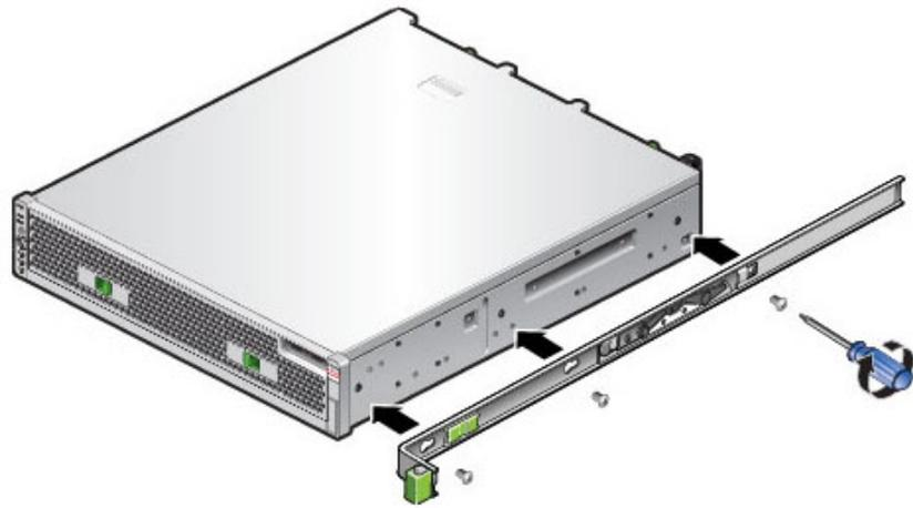
3. L'illustration suivante présente la fixation des supports de montage de l'appareil 7420.
