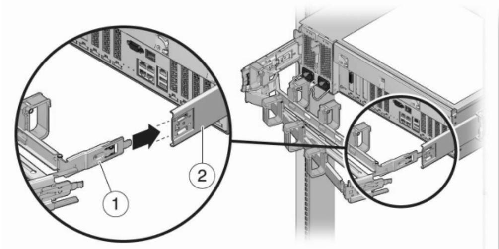
3. **Insérez le connecteur de glissière droit du module de fixation des câbles (1) dans l'ensemble glissière droit (2) jusqu'à ce que le connecteur s'enclenche.**
