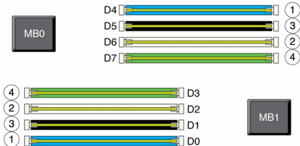
Les noms des modules DIMM dans les journaux de l'appareil et la vue Maintenance > Matériel sont affichés avec un nom complet, par exemple /SYS/MB/P0/D7.
