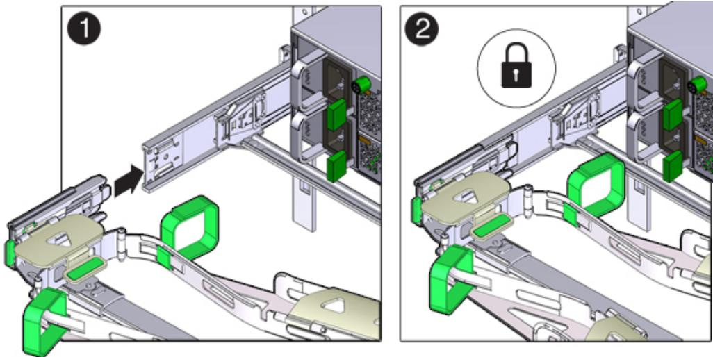
13. Tirez doucement sur le côté gauche de la barre coulissante arrière du CMA afin de vérifier que le connecteur D est correctement inséré.
