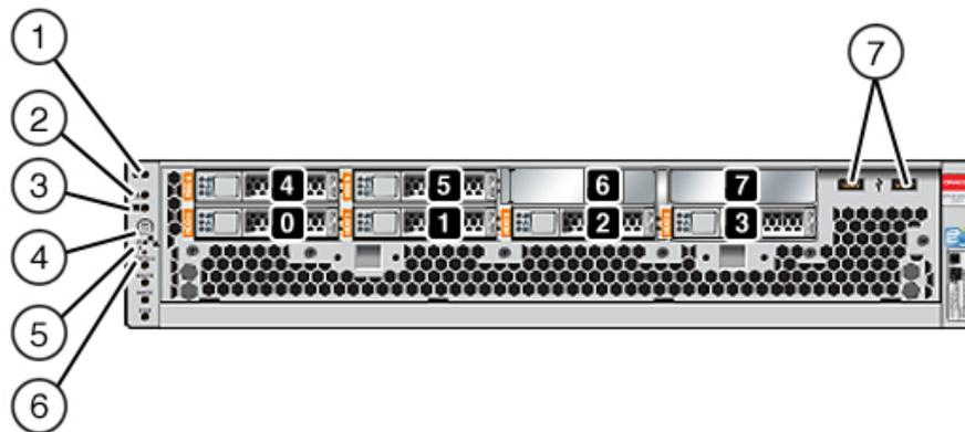
Les emplacements des unités de disque 0 et 1 sont équipés de deux unités d'initialisation SAS-2 de 900 Go . Jusqu'à quatre disques durs électroniques (SSD) de 1,6 To optimisés pour la lecture
