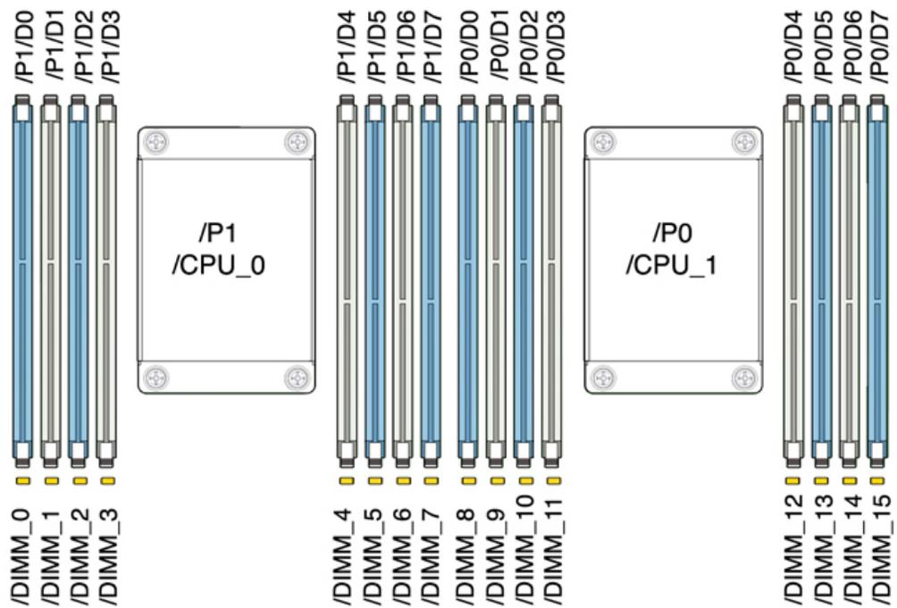
**Remarque** - Tous les sockets doivent être occupés par des modules DIMM DDR3 identiques.
