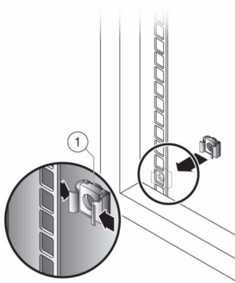
2. Positionnez un ensemble glissière sur votre rack en faisant ressortir les crochets placés à chaque extrémité de l'ensemble glissière à l'extérieur des montants avant et arrière du rack. L'illustration suivante présente les crochets de l'ensemble glissière.
