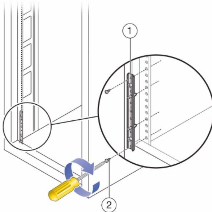
5. **Installez chaque rail en alignant tout d'abord les broches avant des adaptateurs pour rack avec les trous correspondants à l'avant du rail, puis ajustez le rail au rack et insérez les broches des adaptateurs pour rack arrière dans les trous correspondants du rail.**
