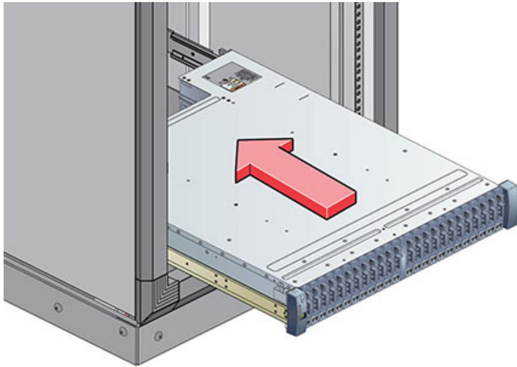
5. **Faites glisser l'étagère avec précaution dans les rails jusqu'à sa mise en place complète dans l'armoire. La personne qui observe doit s'assurer que l'étagère est complètement en place dans les rails à l'aide d'une lampe torche. Si vous retirez l'étagère pour la remettre en place, soutenez-la en permanence.**
