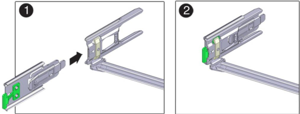
12. Tout en maintenant le crochet de bascule de la glissière en place, insérez le connecteur D et le crochet de bascule de glissière qui lui est associé dans la glissière gauche jusqu'à ce que le connecteur D s'enclenche en émettant un clic (images 1 et 2). Lorsque vous insérez le connecteur D dans la glissière, la méthode la plus simple et privilégiée est d'installer le connecteur D et le crochet de bascule en un ensemble dans la glissière.
