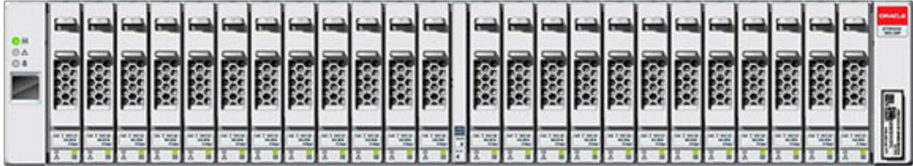
Le boîtier Oracle Storage Drive Enclosure DE2-24P est un châssis 2U prenant en charge 24 unités SAS-2 2,5". Les unités de disque dur hautes performances assurent un stockage fiable et les disques durs électroniques permettent des opérations d'écriture accélérées. Cette étagère de disques est équipée de modules d'E/S (IOM) doubles et redondants et d'une double alimentation avec modules de ventilateur.
