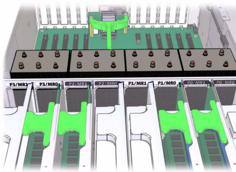
Reportez-vous à l'étiquette de maintenance sur le capot pour obtenir des informations relatives à la position des DIMM. Sur chaque carte riser de mémoire, les emplacements D0, D2, D4 et D6 doivent être remplis ; les emplacements D1, D3, D5 et D7 peuvent également être remplis de manière groupée sur **all** les cartes riser de mémoire installées. Tous les modules DIMM du système **must be identical**.
