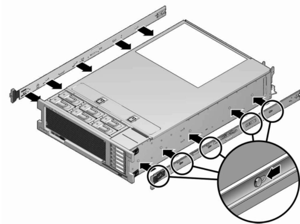
4. **Quand les extrémités des quatre broches du châssis ressortent des quatre ouvertures à encoches du support de montage, tirez le support de montage vers l'avant du châssis de manière à ce que l'agrafe du support de montage se verrouille avec un clic audible.**
