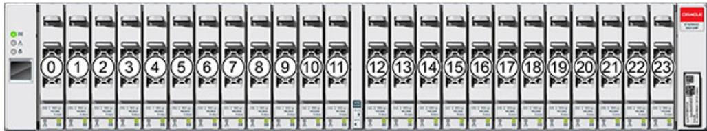
Jusqu'à quatre disques durs électroniques (SSD) Logzilla sont pris en charge par étagère de disques.
