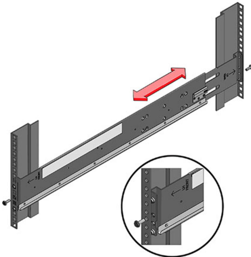
3. Si votre rack est une armoire taraudée universelle de 48,3 cm : a) Utilisez un tournevis Torx T20 afin de retirer les chevilles de repère de l'avant et de l'arrière des rails. b) Utilisez la clé anglaise fournie pour insérer deux broches dans chaque extrémité des rails, à la même place où les chevilles ont été retirées. c) Positionnez l'avant des rails dans l'armoire, en plaçant la bride des rails à l'intérieur de la bride de l'armoire, l'étiquette des rails étant orientée vers
