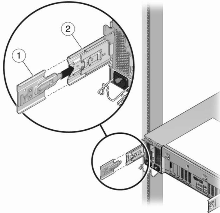
2. **Insérez le connecteur du support de montage du module de fixation des câbles dans la glissière droite jusqu'à ce que le connecteur s'enclenche.**
