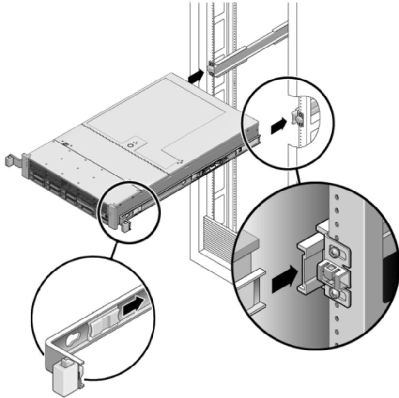
12. L'illustration suivante présente l'insertion du châssis de l'appareil 7420.
