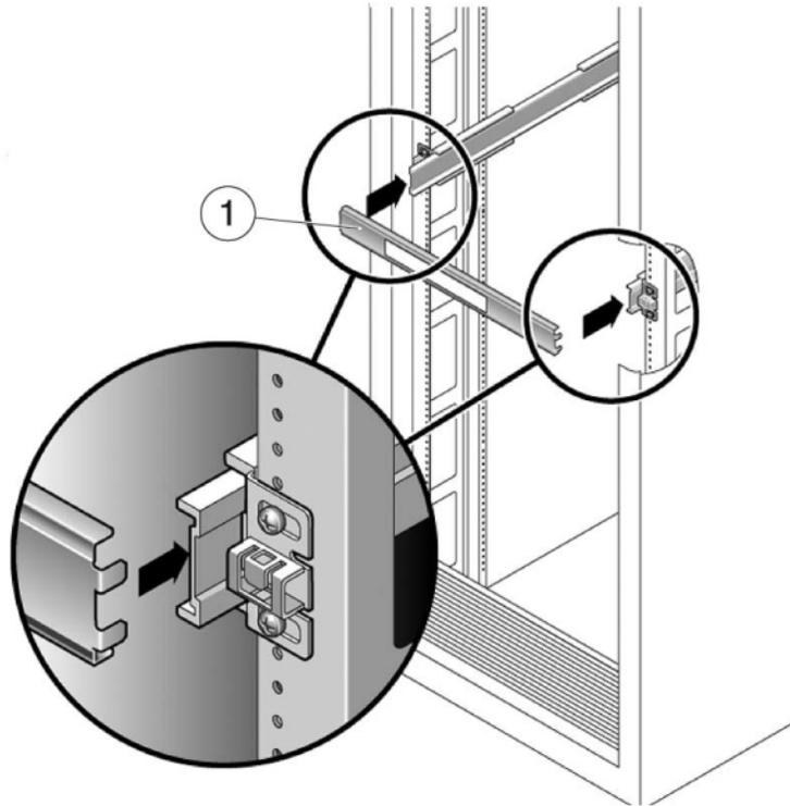
5. **Serrez les vis sur les crochets.**
