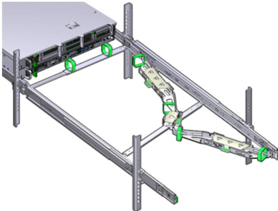
16. Remplacez le contrôleur de stockage dans le rack. Lorsque vous poussez le contrôleur de stockage à l'intérieur du rack, vérifiez que le CMA rentre sans plier.
