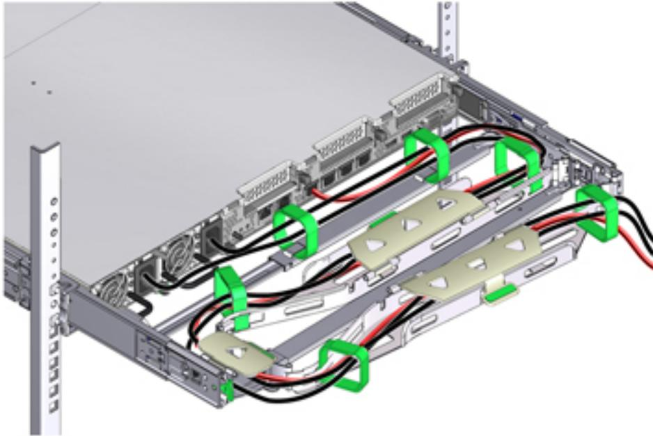
18. Lorsque vous fixez les câbles avec les bandes Velcro situées sur la barre coulissante avant, assurez-vous que les bandes Velcro ne s'enroulent pas autour de la partie inférieure de la barre coulissante ; autrement, l'extension et la contraction de la barre coulissante pourraient être entravées lorsque le serveur est sorti hors du rack et lorsqu'il est inséré à nouveau dans le rack.
