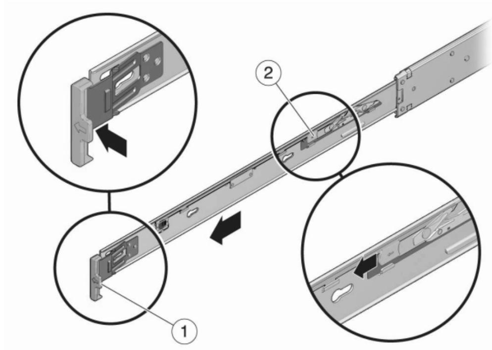
1. **Positionnez un support de montage contre le châssis de manière à ce que le verrou de la glissière se trouve à l'avant et que les ouvertures à encoches du support de montage soient alignées sur les broches de repère sur le côté du châssis.**
