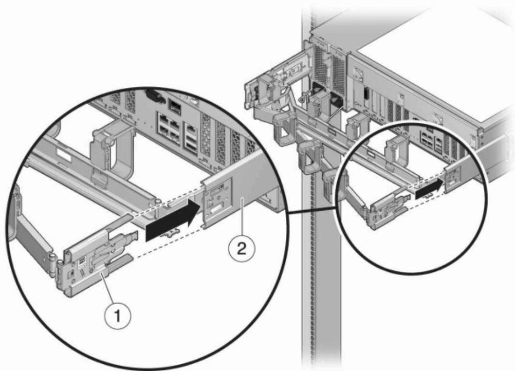
4. **Insérez le connecteur de glissière gauche du module de fixation des câbles (1) dans l'ensemble glissière gauche (2) jusqu'à ce que le connecteur s'enclenche.**
