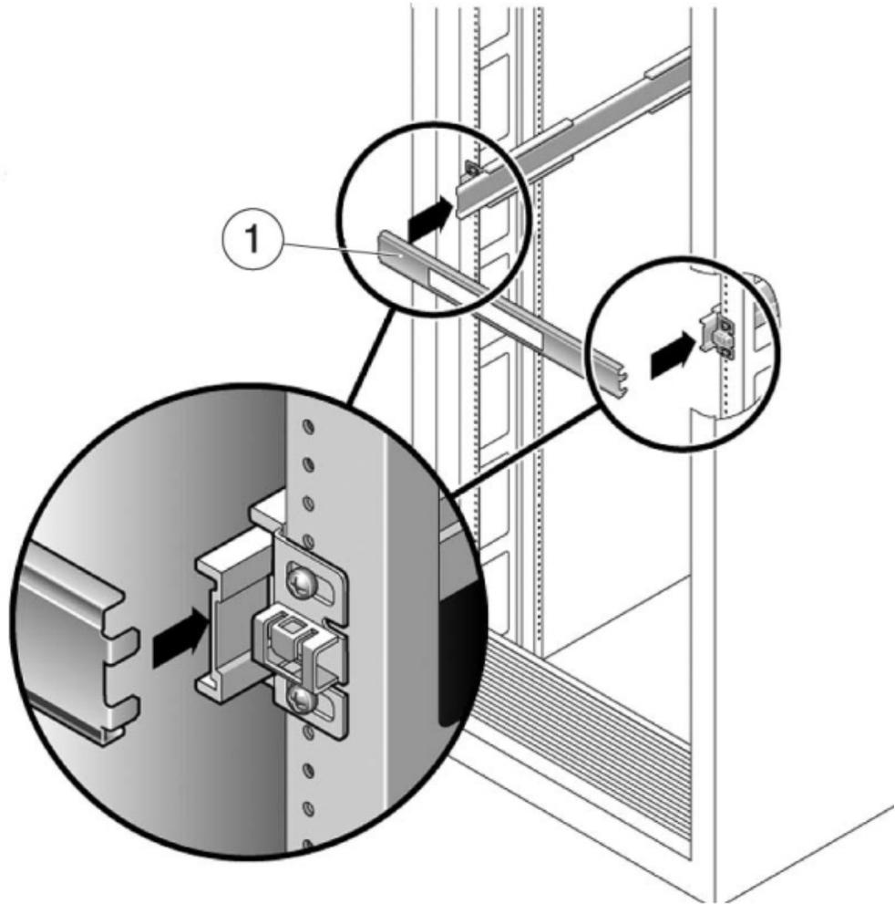
9. Serrez les vis sur les crochets. (couple de 30 lb.)
