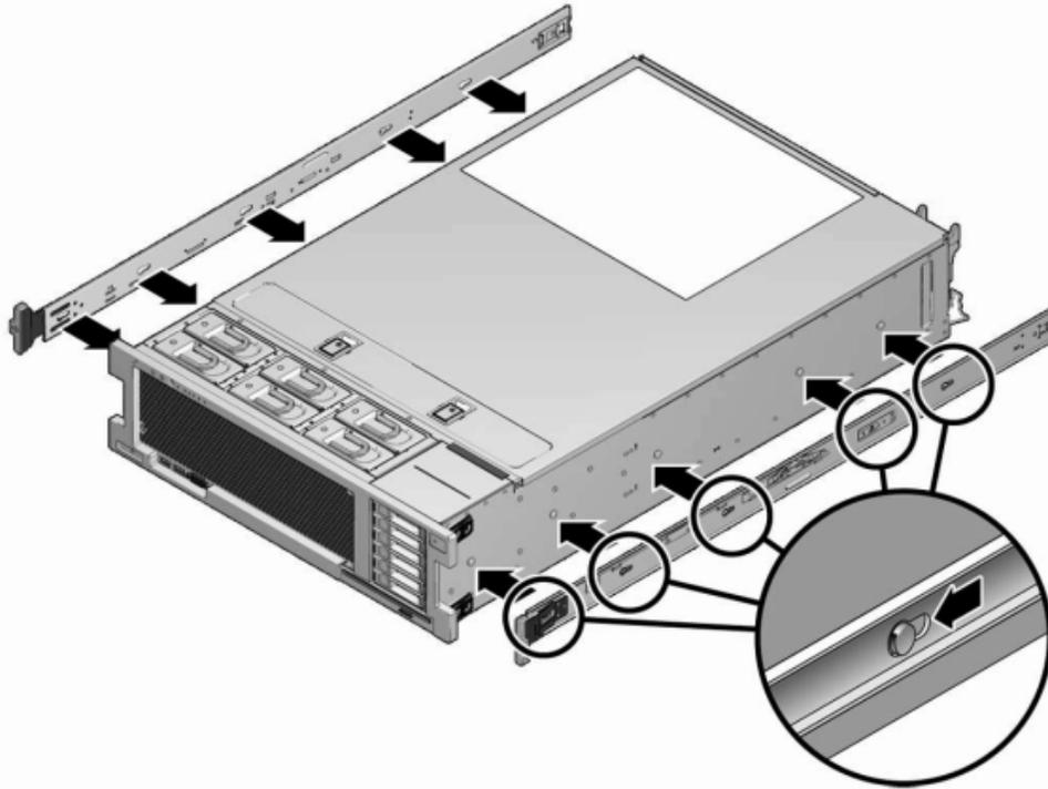
3. **Quand les extrémités des quatre broches du châssis ressortent des quatre ouvertures à encoches du support de montage, tirez le support de montage vers l'avant du châssis de manière à ce que l'agrafe du support de montage se verrouille avec un clic audible.**
