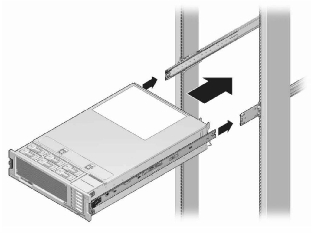
▼ **Installation du module de fixation des câbles.**
