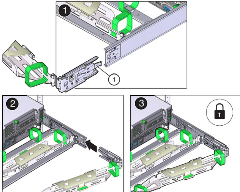
11. Pour préparer l'installation du connecteur D du CMA, retirez la bande fixant le crochet de bascule de la glissière au connecteur D et assurez-vous que le crochet de bascule est aligné correctement avec le connecteur D (images 1 et 2).
