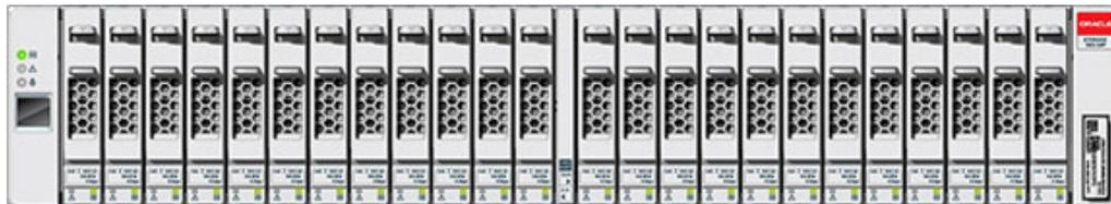
Oracle Storage Drive Enclosure DE2-24P est un châssis 2U prenant en charge 24 disques SAS-2 de 2,5". Les unités de disque dur hautes performances assurent un stockage fiable et les disques durs électroniques permettent des opérations d'écriture accélérées. Cette étagère de disques est équipée de modules d'E/S (IOM) doubles et redondants et d'une double alimentation avec modules de ventilateur.
