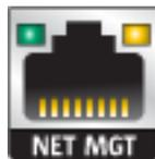
マザーボードには、10/100/1000Mbps で動作する 4 つの RJ-45 ギガビット Ethernet コネクタ (NET0、NET1、NET2、NET3) があります。これらのネットワークインタフェースは、使用前に構成しておく必要があります。
