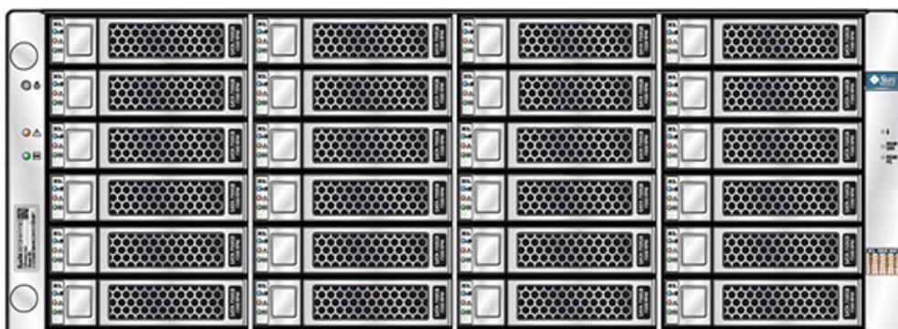
Sun Disk Shelf は、3.5 インチの SAS-2 ドライブを 24 台収容できる 4U シャーシです。SSD は書き込み操作の高速化を実現し、大容量の HDD は信頼できるストレージを実現します。このディスクシェルフは、デュアルの冗長な SAS インタフェースモジュール (SIM) ボードとファンモジュール付きデュアル電源装置を備えています。
