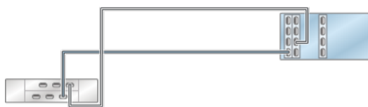
図 3-13 2つのチェーン内で DE2-24 ディスクシェルフ 2 台に接続された HBA 3 基を搭載する 7420 スタンドアロンコントローラ
