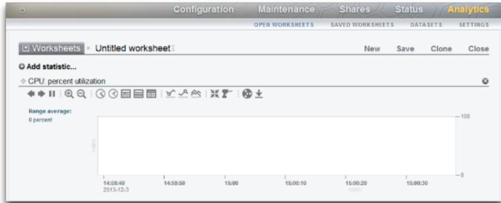
设备 CPU 可以达到 100% 的利用率，这可能是一个问题，也可能不是。对于某些性能测试，会有意将设备驱动到 100% 的 CPU 利用率，以便在峰值性能时进行测量。
