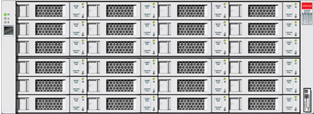
Oracle Storage Drive Enclosure DE2-24C 是支持 24 个 3.5" SAS-2 驱动器的 4U 机箱。SSD 提供加速的写入操作，大容量 HDD 提供可靠的存储。此磁盘机框的主要特征为双冗余 I/O 模块 (I/O Module, IOM) 和具有风扇模块的双电源。
