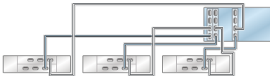
图 3-15 具有三个 HBA 且通过四个链连接到四个 DE2-24 磁盘机框的 7420 单机控制器
