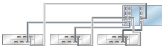
图 3-75 具有三个 HBA 且通过四个链连接到四个 DE2-24 磁盘机框的 ZS3-4 单机控制器
