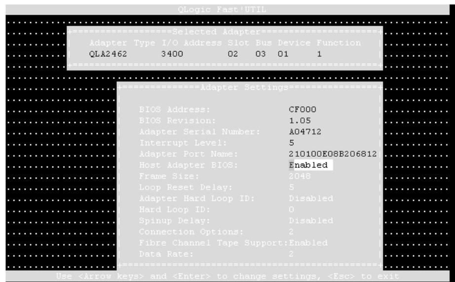
**FIGURE 9-3** Ecran du BIOS d'un adaptateur de bus hôte dans lequel activer l'initialisation à partir du LUN FC
