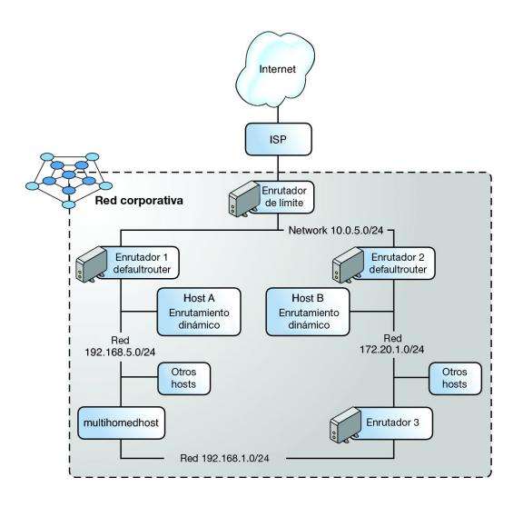
FIGURA 1-3 Sistema autónomo con varios enrutadores IPv4
