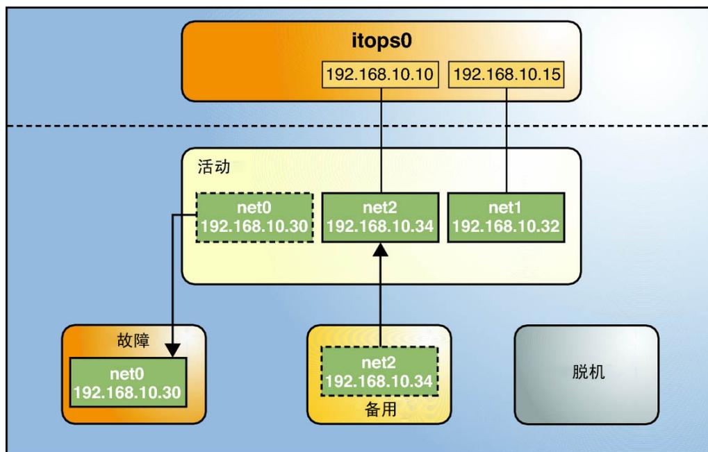
注 - 图 2-2 “IPMP 中的接口故障” 中数据地址与活动接口存在一对一对应关系，这仅是为了简化示意图。IP 内核模块可以随机指定数据地址，数据地址和接口之间不一定符合一对一关系。
