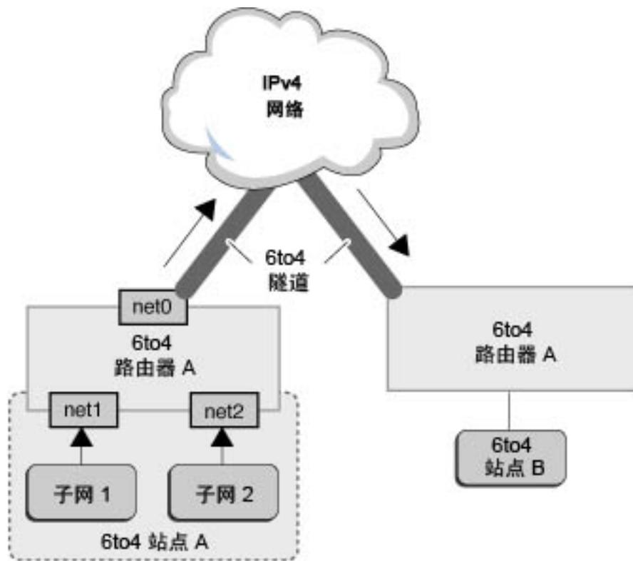
上图描述了两个隔离的 6to4 网络，即站点 A 和站点 B。每个站点都配置了具有到 IPv4 网络的外部连接的路由器。跨 IPv4 网络的 6to4 隧道可以连接两个 6to4 站点。
