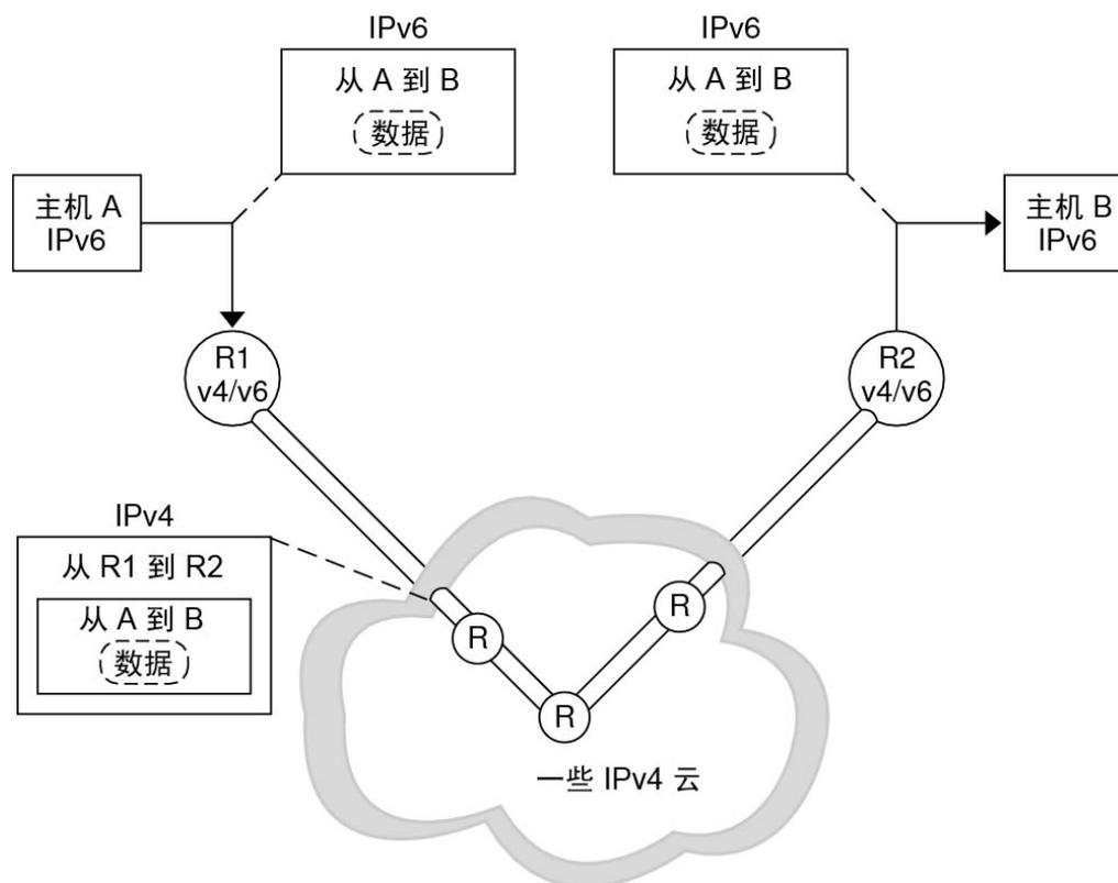
在上图中，隧道由两个路由器组成，这两个路由器之间配置了通过 IPv4 网络建立的虚拟的点对点链路。
