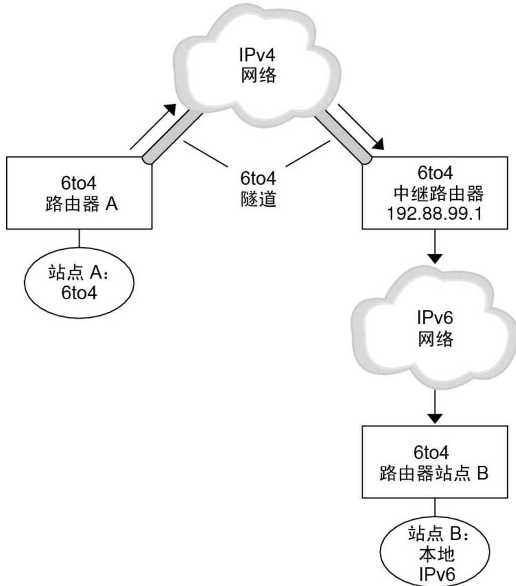
在图 4-3 “从 6to4 站点到 6to4 中继路由器的隧道”中，6to4 站点 A 需要与本地 IPv6 站点 B 上的节点通信。该图说明了从站点 A 到 IPv4 网络上 6to4 隧道的通信路径。该隧道
