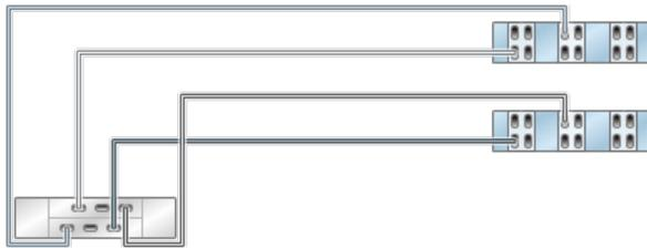
**FIGURA 63** Controladores en clusters con seis HBA conectados a dos estantes de discos DE2-24 en dos cadenas
