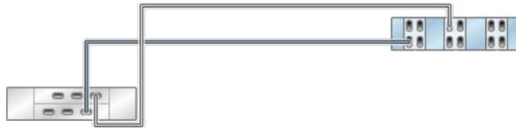
**FIGURA 28** Controlador independiente con seis HBA conectado a dos estantes de discos DE2-24 en dos cadenas
