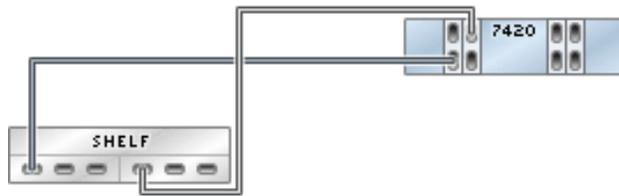
**FIGURA 218** Controlador independiente con cuatro HBA conectado a dos estantes de discos Sun Disk Shelf en dos cadenas
