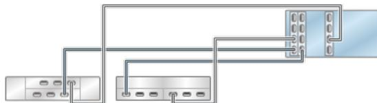
**FIGURA 283** Controladores independientes con tres HBA conectados a tres estantes de discos combinados en tres cadenas (DE2-24 está a la izquierda)
