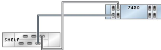
**FIGURA 13** Controlador independiente con cuatro HBA conectado a dos estantes de discos DE2-24 en dos cadenas
