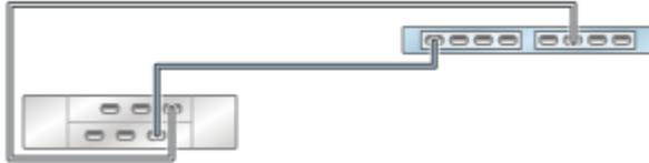
**FIGURA 135** Controlador independiente con dos HBA conectado a dos estantes de discos DE2-24 en dos cadenas
