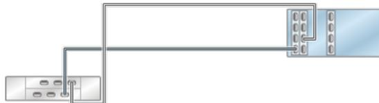
**FIGURA 159** Controlador independiente con tres HBA conectado a dos estantes de discos DE2-24 en dos cadenas
