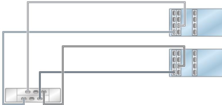
**FIGURA 183** Controladores en clusters con tres HBA conectados a dos estantes de discos DE2-24 en dos cadenas
