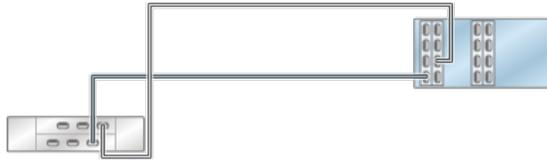
**FIGURA 97** Controlador independiente con cuatro HBA conectado a dos estantes de discos DE2-24 en dos cadenas
