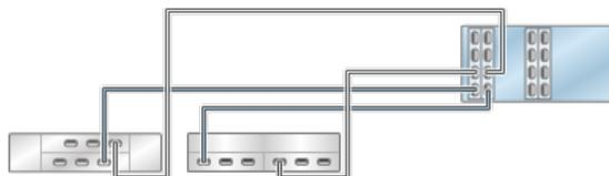
**FIGURA 359** Controladores independientes con cuatro HBA conectados a tres estantes de discos combinados en tres cadenas (DE2-24 está a la izquierda)
