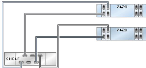
**FIGURA 48** Controladores en clusters con cuatro HBA conectados a dos estantes de discos DE2-24 en dos cadenas
