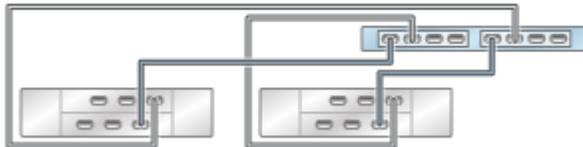
**FIGURA 136** Controlador independiente con dos HBA conectado a tres estantes de discos DE2-24 en tres cadenas
