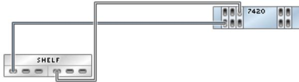
**FIGURA 224** Controlador independiente con cinco HBA conectado a dos estantes de discos Sun Disk Shelf en dos cadenas
