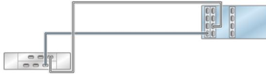
**FIGURA 89** Controlador independiente con tres HBA conectado a dos estantes de discos DE2-24 en dos cadenas
