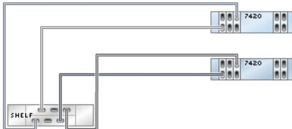
**FIGURA 55** Controladores en clusters con cinco HBA conectados a dos estantes de discos DE2-24 en dos cadenas
