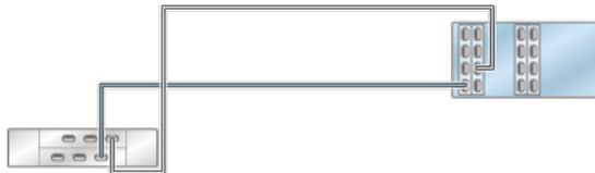
**FIGURA 167** Controlador independiente con cuatro HBA conectado a dos estantes de discos DE2-24 en dos cadenas
