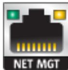
Existen cuatro puertos Gigabit Ethernet RJ-45 (NET0, NET1, NET2, NET3) situados en la placa base que funcionan a 10/100/1000 Mbit/s. Estas interfaces de red se deben configurar antes de usarse.
