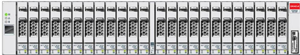
Oracle Storage Drive Enclosure DE2-24P es un chasis 2U que admite 24 unidades SAS-2 de 2,5". Las HDD de alto rendimiento proporcionan un almacenamiento fiable, y las SSD ofrecen operaciones de escritura aceleradas. Este estante de discos incluye módulos de E/S (IOM) redundantes dobles y una fuente de alimentación doble con módulos de ventiladores.
