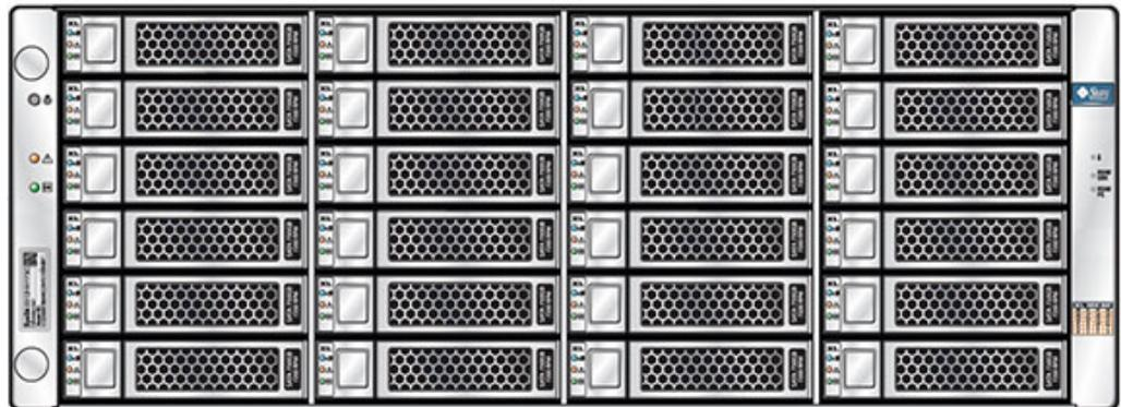
Sun Disk Shelf es un chasis 4U que admite 24 unidades SAS-2 de 3,5". Las SSD ofrecen operaciones de escritura aceleradas, y las HDD de alta capacidad proporcionan un almacenamiento fiable. Este estante de discos incluye placas de módulo de interfaz SAS (SIM) redundantes dobles y una fuente de alimentación doble con módulos de ventiladores.
