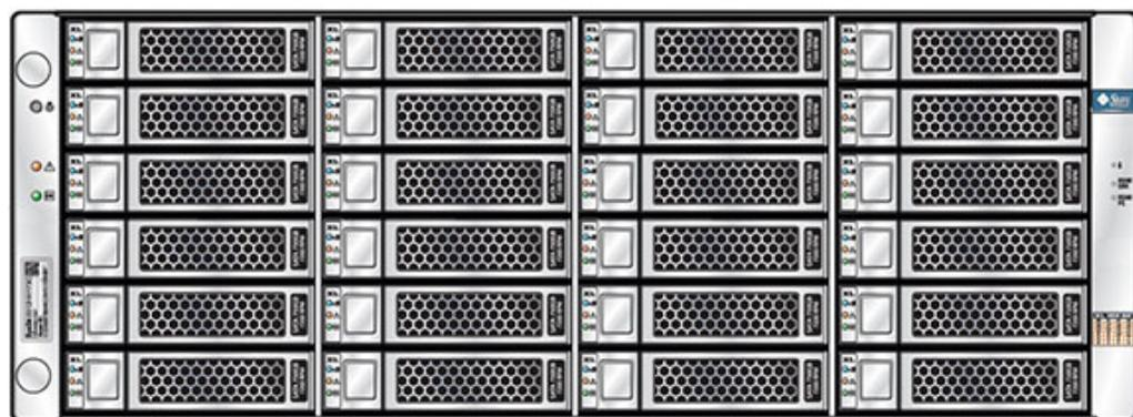
L'étagère de disques Sun Disk Shelf est un châssis 4U prenant en charge 24 disques SAS-2 de 3,5". Les disques durs électroniques permettent des opérations d'écriture accélérées et les unités de disque dur à haute capacité assurent un stockage fiable. L'étagère de disques est équipée de
