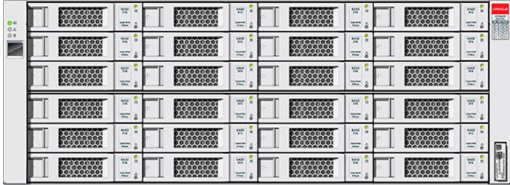
Oracle Storage Drive Enclosure DE2-24C est un châssis 4U prenant en charge 24 disques SAS-2 de 3,5". Les disques durs électroniques permettent des opérations d'écriture accélérées et les unités de disque dur à haute capacité assurent un stockage fiable. Cette étagère de disques est équipée de modules d'E/S (IOM) doubles et redondants et d'une double alimentation avec modules de ventilateur.
