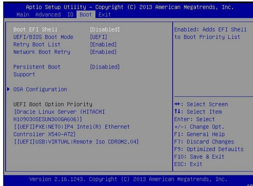
**Note** - Le menu BIOS Boot qui apparaît dans votre installation peut différer selon le type de contrôleur de disque ou d'autre matériel (cartes réseau PCIe par exemple) installé dans votre serveur.
