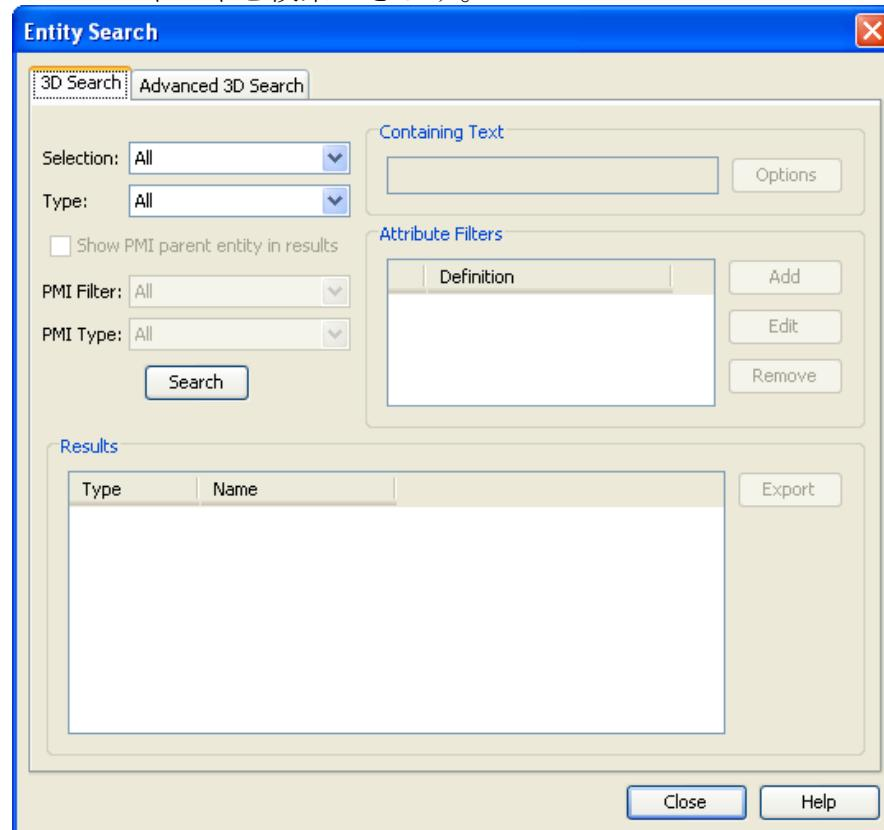
モデル全体またはモデル内で選択したエンティティを検索でき、3D テキスト検索を実行できます。また、エンティティをフィルタする検索基準として、属性、エンティティ・タイプまたは PMI フィルタを適用できます。さらに、エンティティのサイズや場所でエンティティを検索したり、結果リストからエンティティを選択してワークスペースやモデル・ツリーで強調表示することができます。
