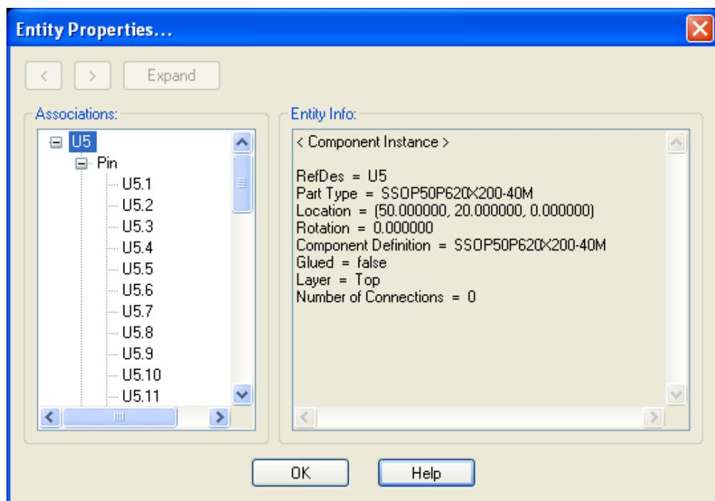
「エンティティ・プロパティ」ダイアログの左側にあるツリーには、選択したエンティティに関するすべてのエンティティが表示されます。選択したエンティティはツリーのルートになり、関連するすべてのエンティティ（タイプ別にグループ化）がその子として表示されます。
