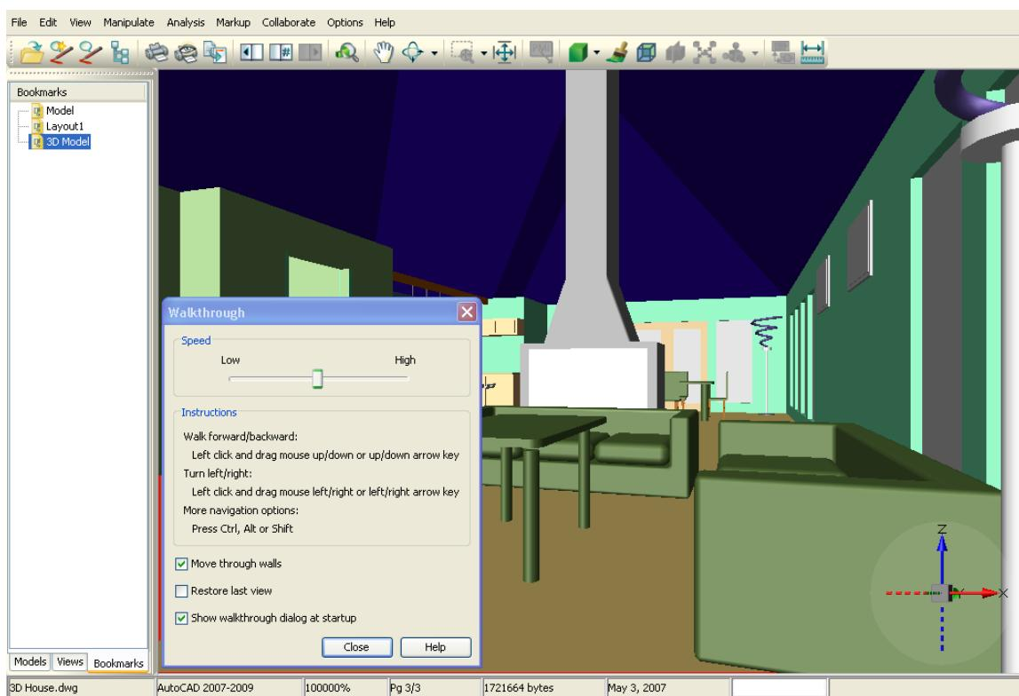
ウォークスルー・モードでは、モデル内を歩き回ったり、飛び回るようにして 3D モデルのビューを操作し、モデルを測定したり、カメラの位置や方向を変更できます。たとえば、家の 3D モデルの表示では、玄関から入り、複数の部屋と階の間を移動できます。その間は、周囲を 360 度にわたって表示し、マークアップを追加できます。
