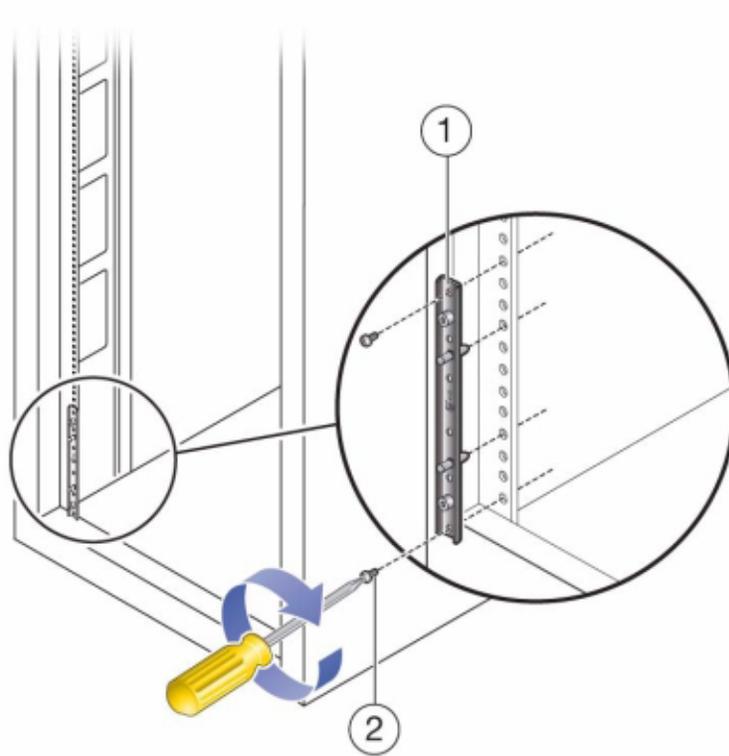
4. 安装每个滑轨，方法是，先将机架转接板的正面定位销与滑轨正面相应的孔对齐，然后调整滑轨使其适合机架尺寸，再将机架转接板上的背面定位销插入到滑轨相应的孔中。
