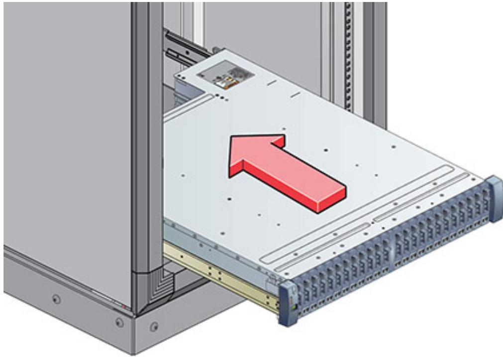
4. 小心地将机框滑入滑轨，直至该机框完全固定在机柜中。观察员应使用手电筒，确保该机框完全固定在滑轨中。如果要卸下机框，以便于重新安放，请始终托住它。
