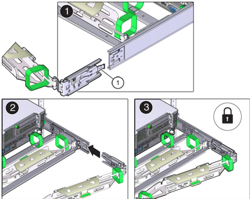
10. 要准备安装 CMA 的连接器 D，请解开将滑轨锁定托架固定到连接器 D 的胶带，并确保该锁定托架与连接器 D 正确对齐（方框 1 和 2）。
