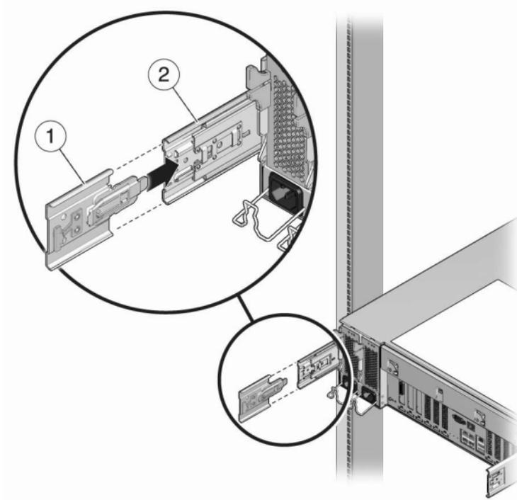
2. 将 CMA 装配托架连接器插入右侧滑轨，直到连接器锁定到位。
