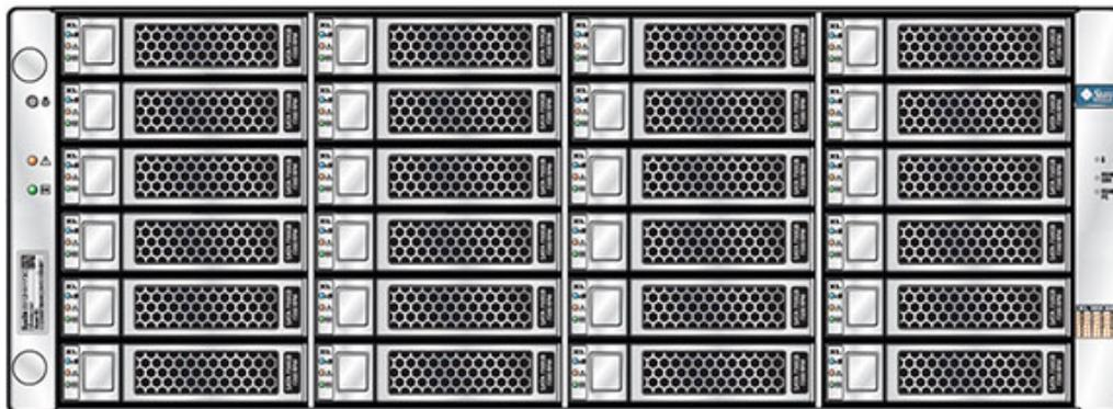
Sun Disk Shelf 是支持 24 个 3.5" SAS-2 驱动器的 4U 机箱。SSD 提供加速的写入操作，大容量 HDD 提供可靠的存储。此磁盘机框的主要特征为双冗余 SAS 接口模块 (SAS Interface Module, SIM) 板和具有风扇模块的双电源。
