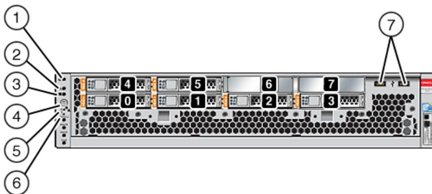
驱动器插槽 0 和 1 有两个已镜像的 1.2TB 或 900GB SAS-2 引导驱动器。最多可以有四个 1.6TB 闪存读取优化 (Readzilla) 固态驱动器 (solid state drive, SSD) 按顺序安装在插槽 2 到插槽 5 中。插槽 6 和插槽 7 为空，且必须包含驱动器填充面板。
