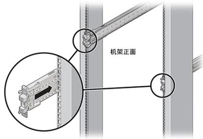
注 - 滑轨装置安装销适合 9.5 毫米的方安装孔。不支持其他安装孔大小。
