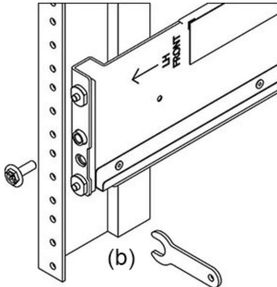
3. 使用机械式升降装置或由两个人（磁盘机框的每一侧各一人）小心地向上提起机框，并将该机框安放在左右滑轨的底部边缘。请勿使用带有风扇模块的电源手柄向上提起机框。
