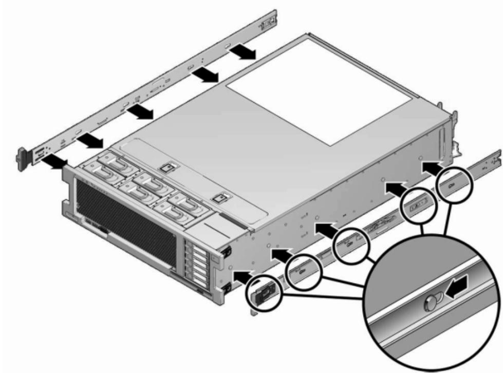
2. 下图显示了如何连接 7420 装配托架。
