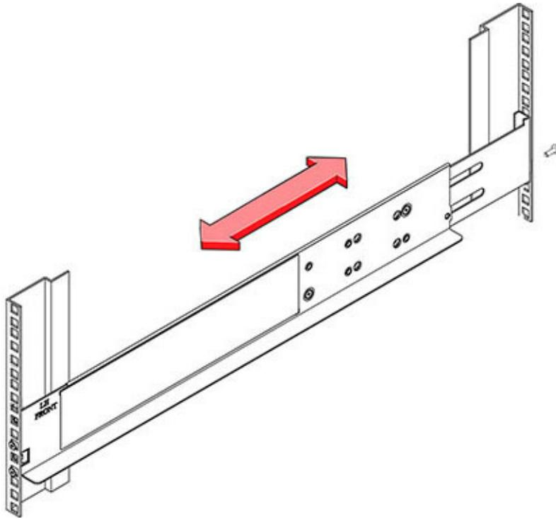
5. 将一颗螺丝穿过机架，安装到每个滑轨的背面。
