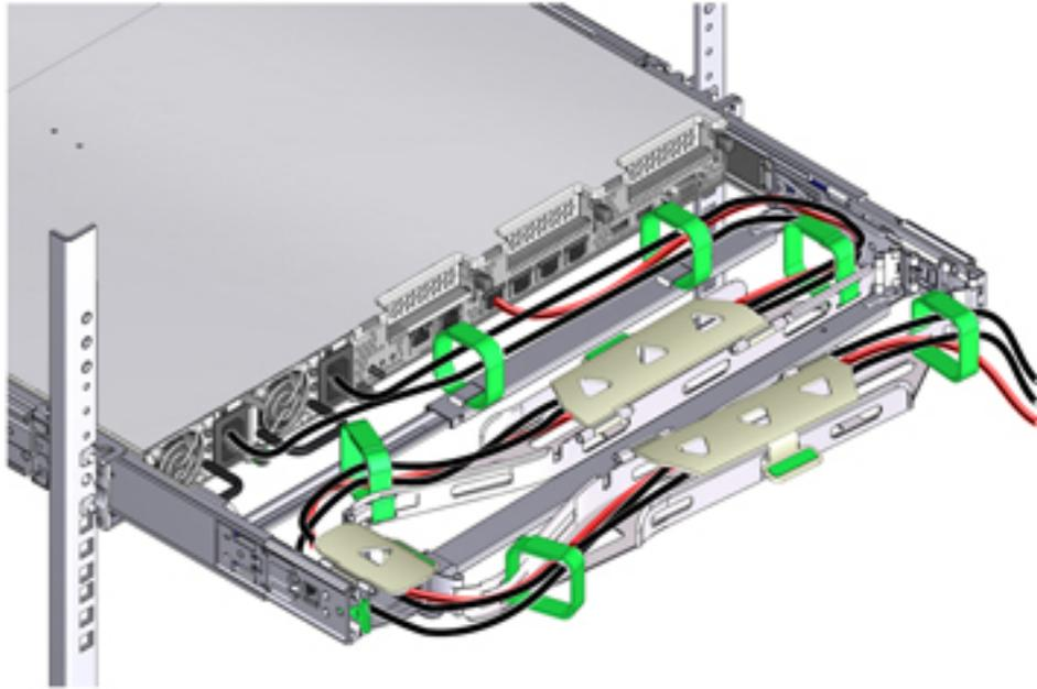
17. 使用前滑杆上的维可牢 (Velcro) 绑带固定电缆时，确保维可牢 (Velcro) 绑带没有缠绕在滑杆底部。
