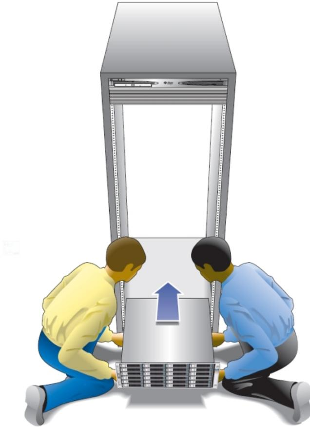
7. 小心地将机框滑入机柜，直到机框的正面外缘接触到机架的垂直面。
