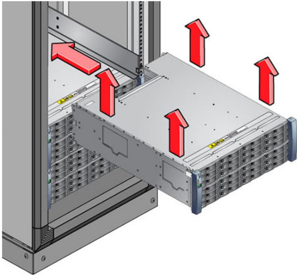
8. 小心地将机框滑入机柜。请确保该机框完全固定在滑轨中。如果要卸下机框，以便于重新安放，请始终托住它。
