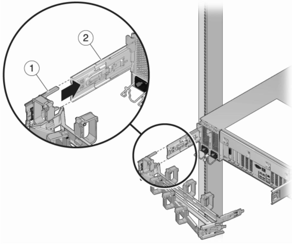
5. 安装并将电缆穿过整个装置后，请安装环扣带 (1) 以固定电缆。然后安装右侧和左侧的外部锁销以支撑装置。
