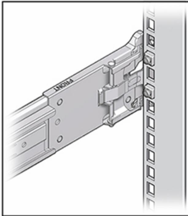
3. (可选) 如果使用卡式螺母和装配螺丝安装装置, 请在所需位置将卡式螺母插入前后机架支柱。然后, 将装配螺丝插过前后滑轨托架和机架支柱。
