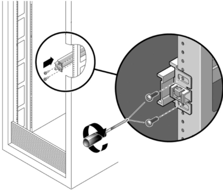
3. 将每个滑轨装置安装到机架支柱上，但请勿完全拧紧螺丝。
