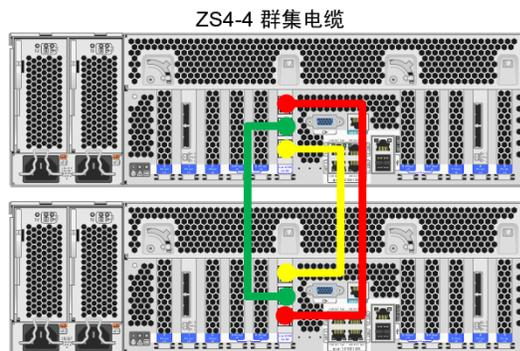
下图显示了两个群集 Oracle ZFS Storage ZS3-2 控制器之间的群集电缆连接。
