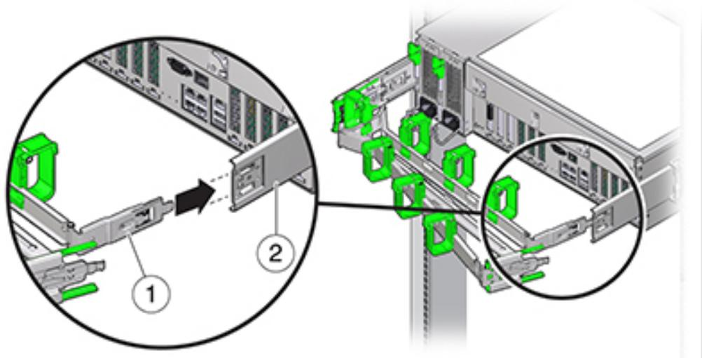
2. 将右侧的 CMA 滑轨连接器 (1) 插入右侧滑轨装置 (2)，直到连接器发出“咔嚓”一声后锁定到位。
