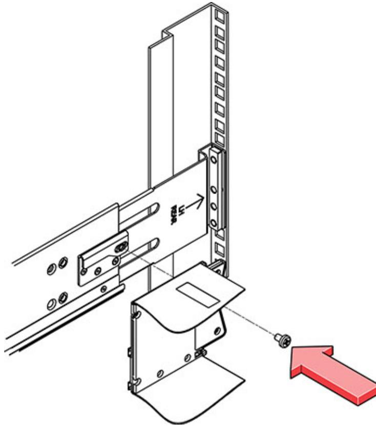
6. 卸下前侧保护套，分别将一颗螺丝安装到前侧每一端，然后重新装上保护套。
