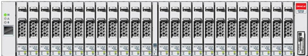
Oracle Storage Drive Enclosure DE2-24P 是支持 24 个 2.5" SAS-2 驱动器的 2U 机箱。高性能 HDD 提供可靠的存储，SSD 提供加速的写入操作。此磁盘机框的主要特征为双冗余 I/O 模块 (I/O Module, IOM) 和具有风扇模块的双电源。
