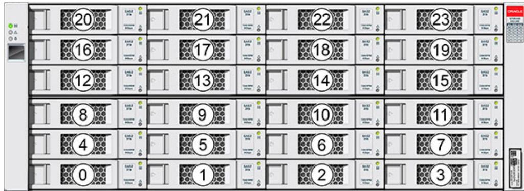
Jusqu'à quatre disques durs électroniques (SSD) Logzilla sont pris en charge par étagère de disques.
