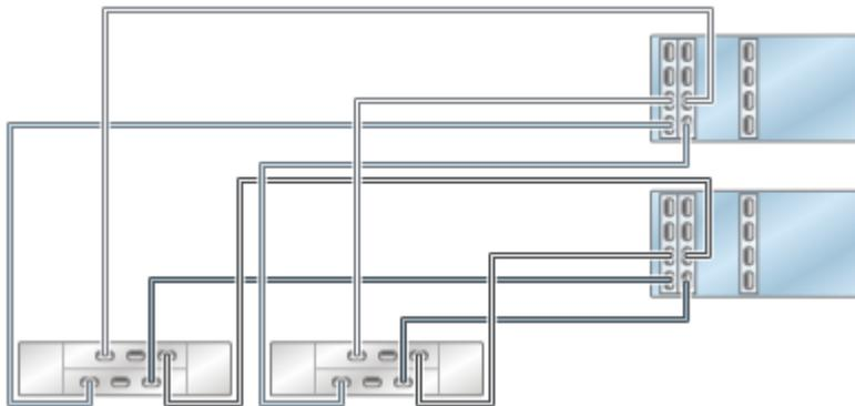
**FIGURE 107** Contrôleurs 7420 en cluster avec trois HBA connectés à trois étagères de disques DE2-24 dans trois chaînes
