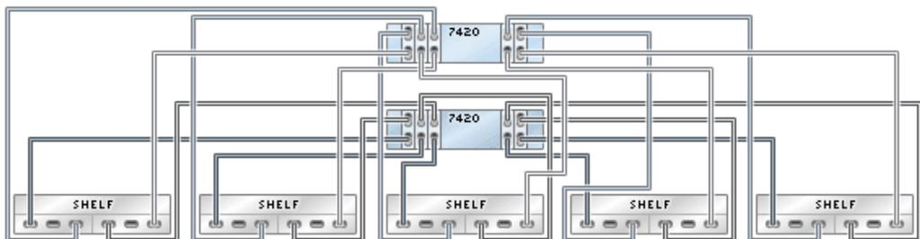
**FIGURE 261** Contrôleurs 7420 en cluster avec cinq HBA connectés à dix étagères de disques Sun Disk Shelf dans cinq chaînes
