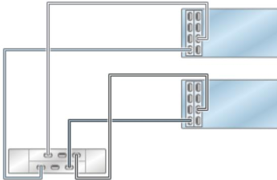
**FIGURE 30** Contrôleurs ZS4-4/ZS3-4 en cluster avec deux HBA connectés à deux étagères de disques DE2-24 dans deux chaînes
