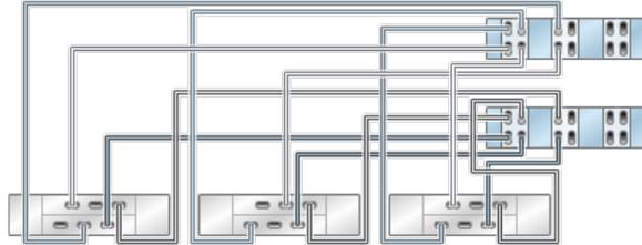
**FIGURE 195** Contrôleurs 7420 en cluster avec six HBA connectés à quatre étagères de disques DE2-24 dans quatre chaînes
