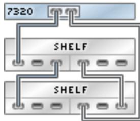
**FIGURE 273** Contrôleur 7320 autonome avec un HBA connecté à six étagères de disques Sun Disk Shelf dans une chaîne unique
