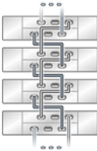
**FIGURE 340** Plusieurs étagères de disques Sun Disk Shelf dans une chaîne unique
