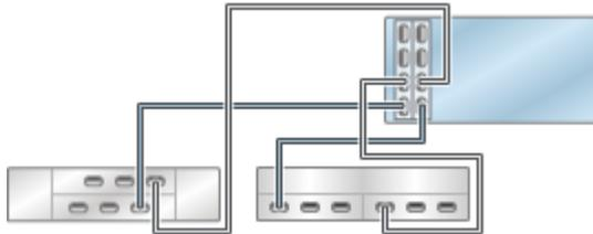
**FIGURE 348** Contrôleurs 7420 autonomes avec deux HBA connectés à trois étagères de disques mixtes dans trois chaînes (DE2-24 affiché à gauche)
