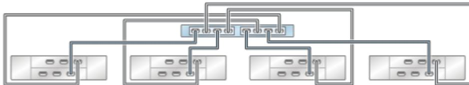
**FIGURE 61** Contrôleur ZS3-2 autonome avec deux HBA connectés à huit étagères de disques DE2-24 dans quatre chaînes
