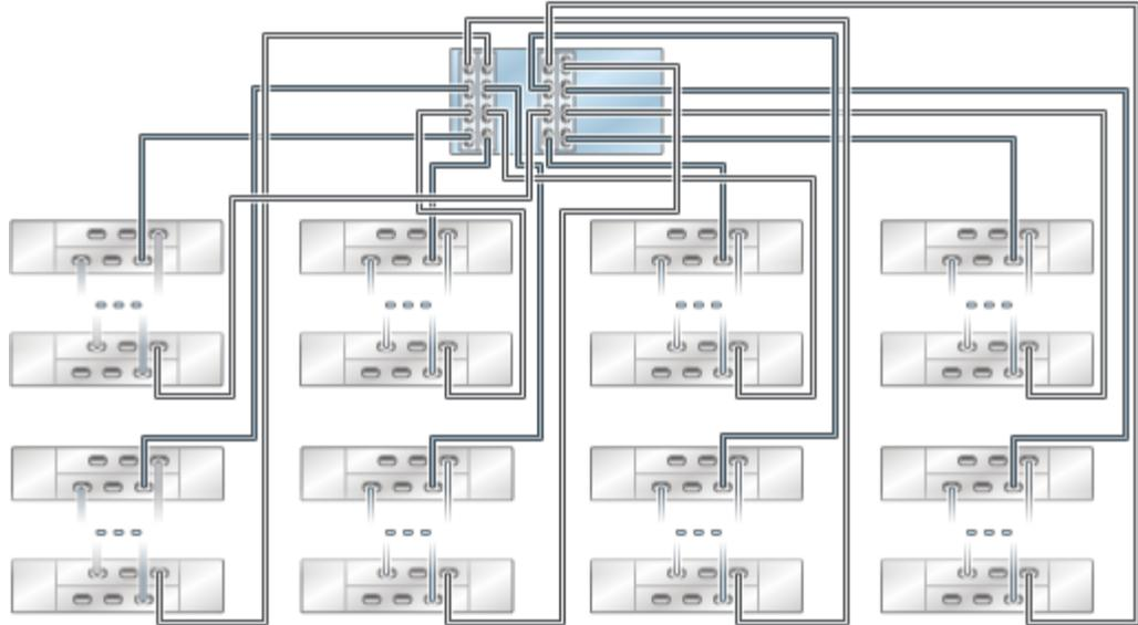
**FIGURE 28** Plusieurs étagères de disques dans une chaîne unique
