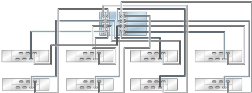
**FIGURE 97** Contrôleur 7420 autonome avec quatre HBA connectés à plusieurs étagères de disques DE2-24 dans huit chaînes
