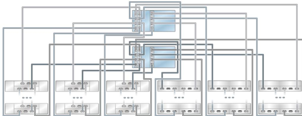
**FIGURE 315** Plusieurs étagères de disques DE2-24 dans une chaîne unique
