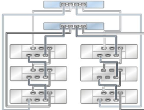
**FIGURE 130** Plusieurs étagères de disques dans une chaîne unique
