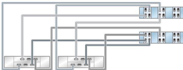
**FIGURE 194** Contrôleurs 7420 en cluster avec six HBA connectés à trois étagères de disques DE2-24 dans trois chaînes
