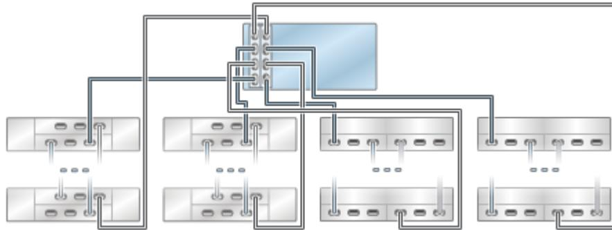
**FIGURE 283** Plusieurs étagères de disques DE2-24 dans une chaîne unique
