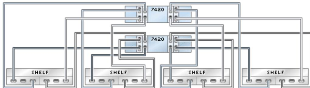
**FIGURE 254** Contrôleurs 7420 en cluster avec quatre HBA connectés à huit étagères de disques Sun Disk Shelf dans quatre chaînes
