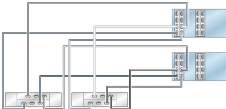
**FIGURE 45** Contrôleurs ZS4-4/ZS3-4 en cluster avec quatre HBA connectés à trois étagères de disques DE2-24 dans trois chaînes
