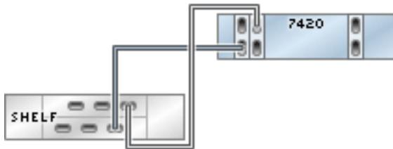
**FIGURE 137** Contrôleur 7420 autonome avec trois HBA connectés à deux étagères de disques DE2-24 dans deux chaînes
