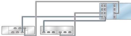
**FIGURE 354** Contrôleurs 7420 autonomes avec trois HBA connectés à trois étagères de disques mixtes dans trois chaînes (DE2-24 affiché à gauche)
