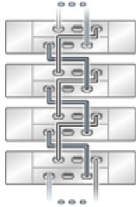
**FIGURE 402** Plusieurs étagères de disques Sun Disk Shelf dans une chaîne unique
