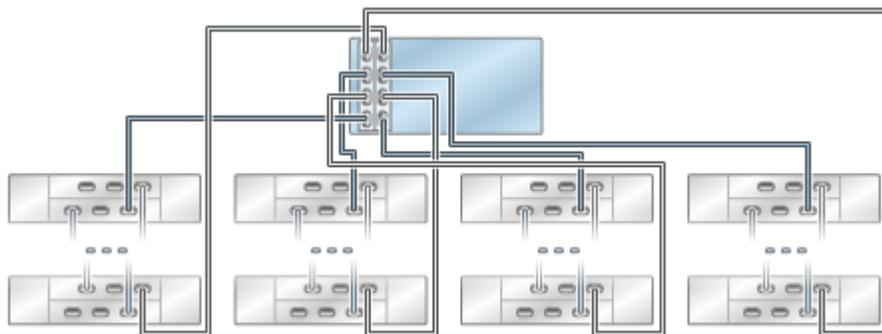
**FIGURE 10** Plusieurs étagères de disques dans une chaîne unique
