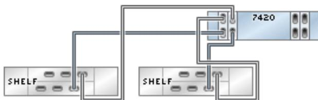
**FIGURE 144** Contrôleur 7420 autonome avec quatre HBA connectés à trois étagères de disques DE2-24 dans trois chaînes
