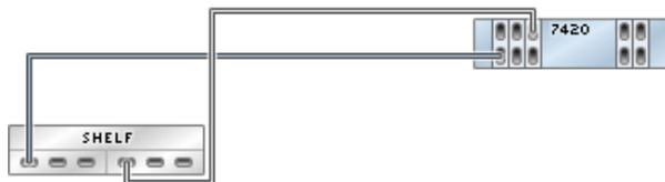
**FIGURE 227** Contrôleur 7420 autonome avec cinq HBA connectés à deux étagères de disques Sun Disk Shelf dans deux chaînes
