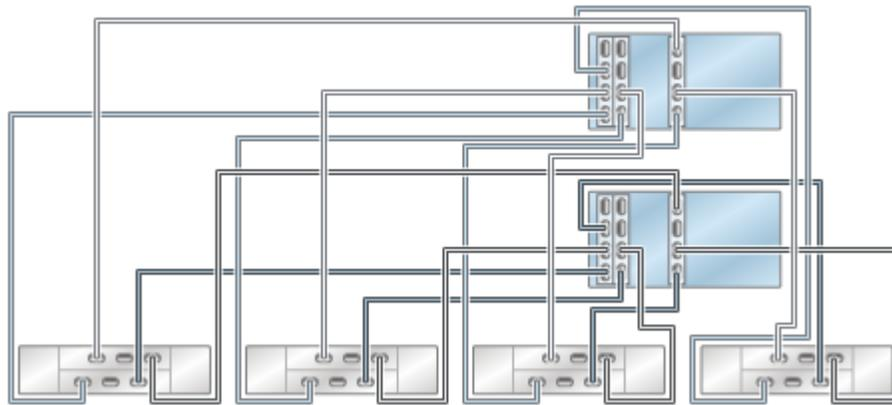
**FIGURE 39** Contrôleurs ZS4-4/ZS3-4 en cluster avec trois HBA connectés à cinq étagères de disques DE2-24 dans cinq chaînes
