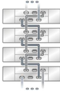
**FIGURE 346** Plusieurs étagères de disques Sun Disk Shelf dans une chaîne unique
