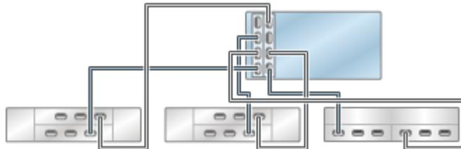
**FIGURE 349** Contrôleurs 7420 autonomes avec deux HBA connectés à quatre étagères de disques mixtes dans quatre chaînes (DE2-24 affiché à gauche)
