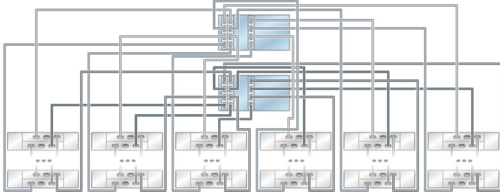
**FIGURE 42** Plusieurs étagères de disques dans une chaîne unique
