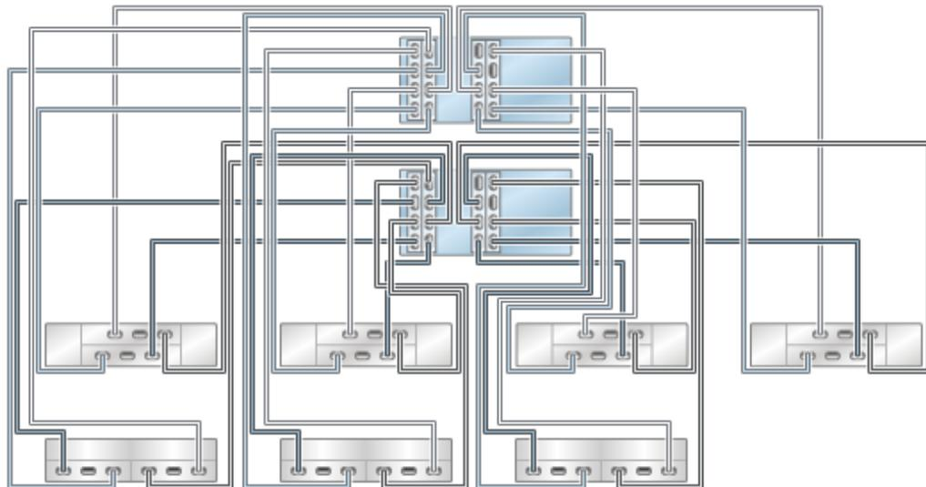
**FIGURE 323** Contrôleurs ZS4-4/ZS3-4 en cluster avec quatre HBA connectés à huit étagères de disques mixtes dans huit chaînes (DE2-24 affiché en haut)
