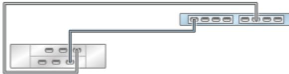
**FIGURE 58** Contrôleur ZS3-2 autonome avec deux HBA connectés à deux étagères de disques DE2-24 dans deux chaînes
