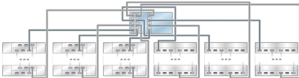
**FIGURE 291** Plusieurs étagères de disques DE2-24 dans une chaîne unique
