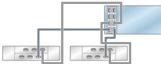
**FIGURE 7** Contrôleur ZS4-4/ZS3-4 autonome avec deux HBA connectés à trois étagères de disques DE2-24 dans trois chaînes
