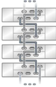
**FIGURE 370** Plusieurs étagères de disques Sun Disk Shelf dans une chaîne unique
