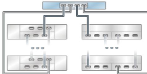
**FIGURE 397** Plusieurs étagères de disques DE2-24 dans une chaîne unique
