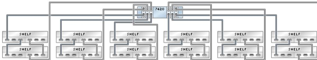
**FIGURE 240** Contrôleur 7420 autonome avec six HBA connectés à 36 étagères de disques Sun Disk Shelf dans six chaînes
