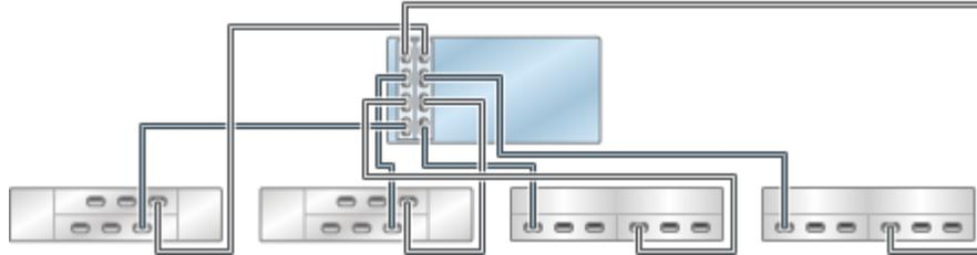
**FIGURE 350** Contrôleurs 7420 autonomes avec deux HBA connectés à plusieurs étagères de disques mixtes dans quatre chaînes (DE2-24 affiché à gauche)
