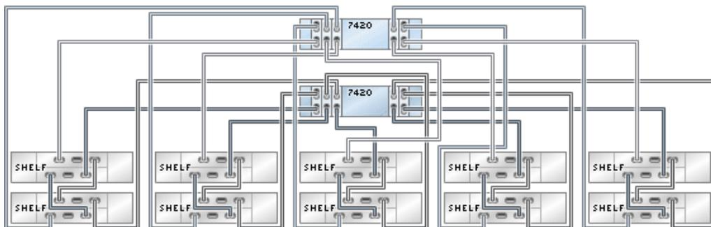
**FIGURE 190** Contrôleurs 7420 en cluster avec cinq HBA connectés à 30 étagères de disques DE2-24 dans cinq chaînes
