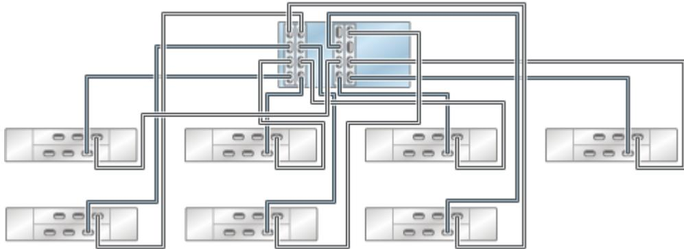
**FIGURE 96** Contrôleur 7420 autonome avec quatre HBA connectés à huit étagères de disques DE2-24 dans huit chaînes
