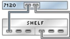
**FIGURE 278** Contrôleur 7120 autonome avec un HBA connecté à deux étagères de disques Sun Disk Shelf dans une chaîne unique
