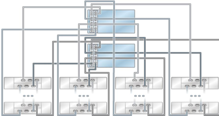
**FIGURE 104** Plusieurs étagères de disques dans une chaîne unique
