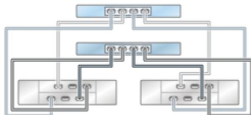
**FIGURE 129** Contrôleurs 7320 en cluster avec un HBA connecté à six étagères de disques DE2-24 dans deux chaînes
