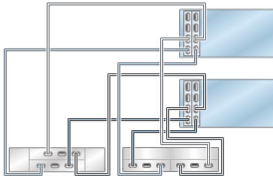
**FIGURE 304** Contrôleurs ZS4-4/ZS3-4 en cluster avec deux HBA connectés à trois étagères de disques mixtes dans deux chaînes (DE2-24 affiché à gauche)
