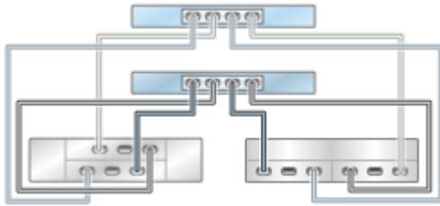
**FIGURE 400** Contrôleurs 7320 en cluster avec un HBA connecté à plusieurs étagères de disques mixtes dans deux chaînes (DE2-24 affiché à gauche)
