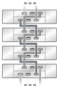
**FIGURE 398** Plusieurs étagères de disques Sun Disk Shelf dans une chaîne unique
