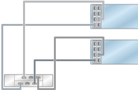
**FIGURE 100** Contrôleurs 7420 en cluster avec deux HBA connectés à deux étagères de disques DE2-24 dans deux chaînes
