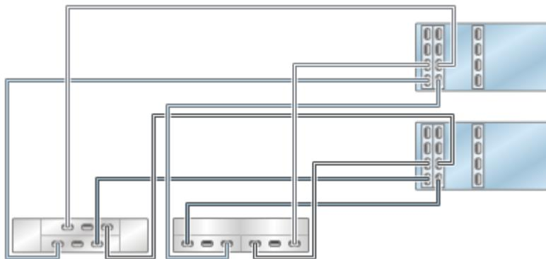
**FIGURE 378** Contrôleurs 7420 en cluster avec trois HBA connectés à trois étagères de disques mixtes dans trois chaînes (DE2-24 affiché à gauche)
