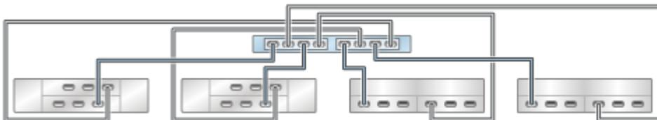
**FIGURE 334** Contrôleur ZS3-2 autonome avec deux HBA connectés à huit étagères de disques mixtes dans quatre chaînes (DE2-24 affiché à gauche)
