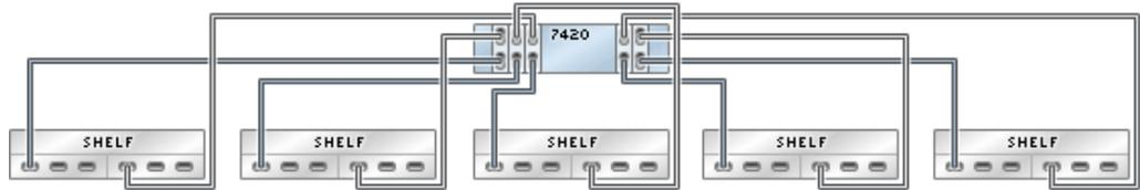
**FIGURE 231** Contrôleur 7420 autonome avec cinq HBA connectés à dix étagères de disques Sun Disk Shelf dans cinq chaînes
