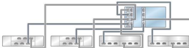
**FIGURE 356** Contrôleurs 7420 autonomes avec trois HBA connectés à cinq étagères de disques mixtes dans cinq chaînes (DE2-24 affiché à gauche)
