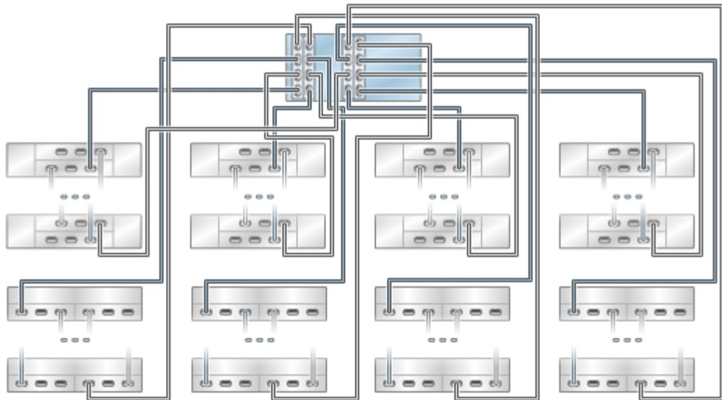
**FIGURE 301** Plusieurs étagères de disques DE2-24 dans une chaîne unique
