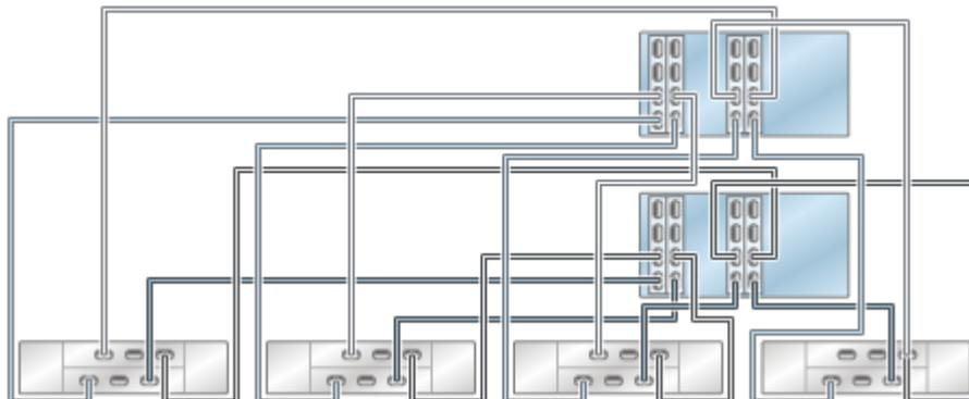
**FIGURE 117** Contrôleurs 7420 en cluster avec quatre HBA connectés à cinq étagères de disques DE2-24 dans cinq chaînes
