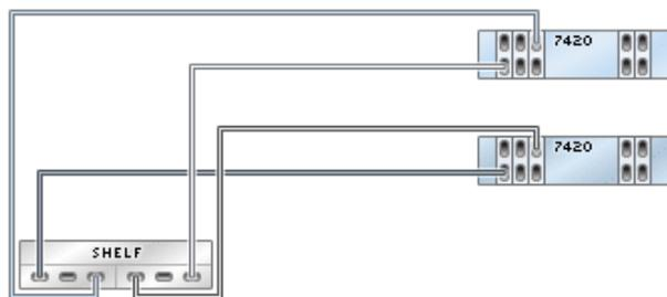
**FIGURE 257** Contrôleurs 7420 en cluster avec cinq HBA connectés à deux étagères de disques Sun Disk Shelf dans deux chaînes
