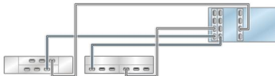
**FIGURE 286** Contrôleurs ZS4-4/ZS3-4 autonomes avec trois HBA connectés à trois étagères de disques mixtes dans trois chaînes (DE2-24 affiché à gauche)
