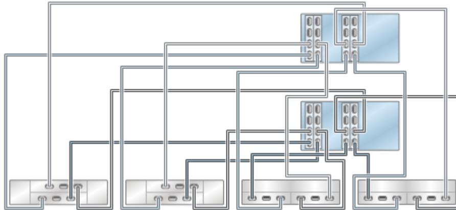
**FIGURE 388** Contrôleurs 7420 en cluster avec quatre HBA connectés à cinq étagères de disques mixtes dans cinq chaînes (DE2-24 affiché à gauche)
