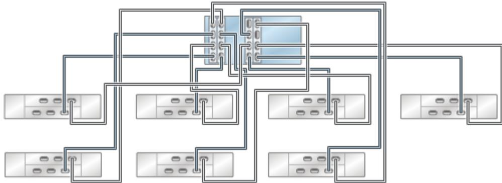
**FIGURE 26** Contrôleur ZS4-4/ZS3-4 autonome avec quatre HBA connectés à huit étagères de disques DE2-24 dans huit chaînes
