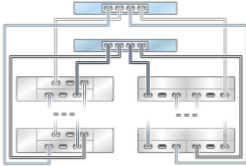
**FIGURE 339** Plusieurs étagères de disques DE2-24 dans une chaîne unique
