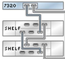
**FIGURE 203** Contrôleur 7320 autonome avec un HBA connecté à six étagères de disques DE2-24 dans une chaîne unique
