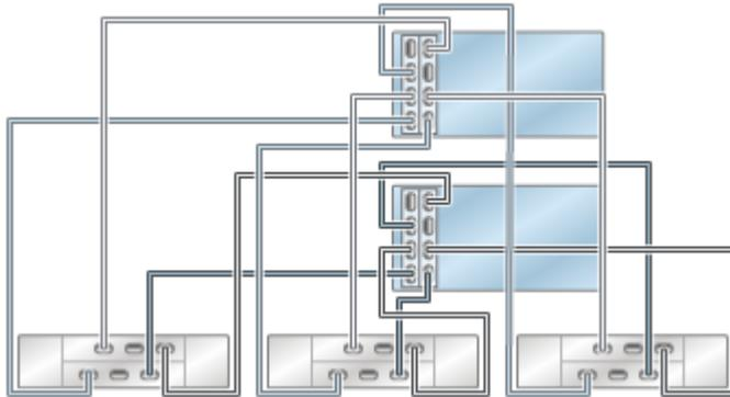
**FIGURE 32** Contrôleurs ZS4-4/ZS3-4 en cluster avec deux HBA connectés à quatre étagères de disques DE2-24 dans quatre chaînes
