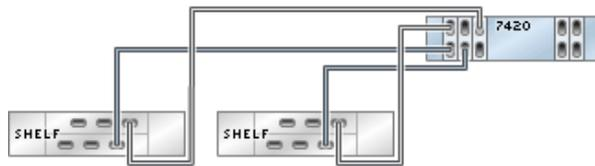
**FIGURE 151** Contrôleur 7420 autonome avec cinq HBA connectés à trois étagères de disques DE2-24 dans trois chaînes
