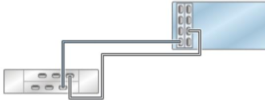
**FIGURE 76** Contrôleur 7420 autonome avec deux HBA connectés à deux étagères de disques DE2-24 dans deux chaînes
