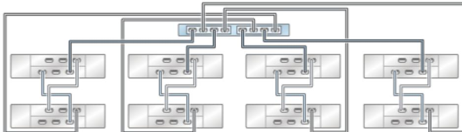
**FIGURE 62** Contrôleur ZS3-2 autonome avec deux HBA connectés à seize étagères de disques DE2-24 dans quatre chaînes
