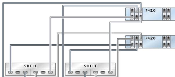
**FIGURE 258** Contrôleurs 7420 en cluster avec cinq HBA connectés à trois étagères de disques Sun Disk Shelf dans trois chaînes
