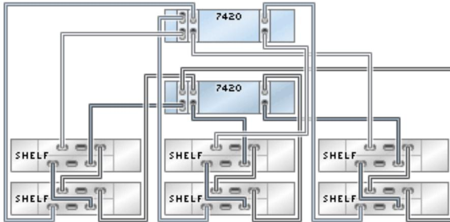
**FIGURE 175** Contrôleurs 7420 en cluster avec trois HBA connectés à 18 étagères de disques DE2-24 dans trois chaînes
