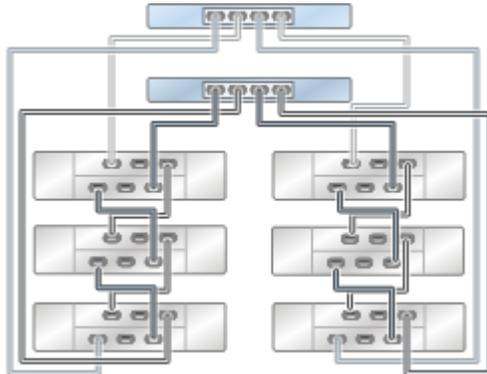
**FIGURE 67** Plusieurs étagères de disques dans une chaîne unique
