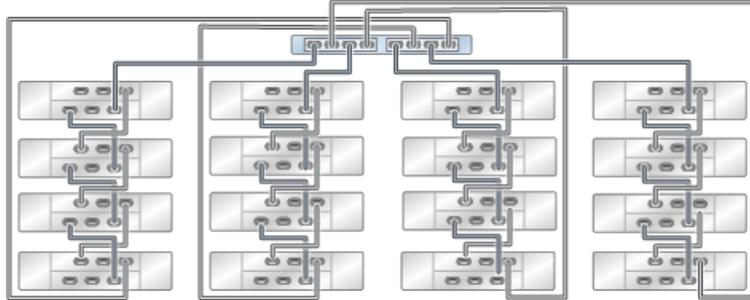
**FIGURE 63** Plusieurs étagères de disques dans une chaîne unique
