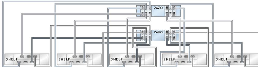
**FIGURE 197** Contrôleurs 7420 en cluster avec six HBA connectés à six étagères de disques DE2-24 dans six chaînes
