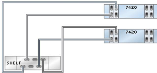
**FIGURE 178** Contrôleurs 7420 en cluster avec quatre HBA connectés à deux étagères de disques DE2-24 dans deux chaînes
