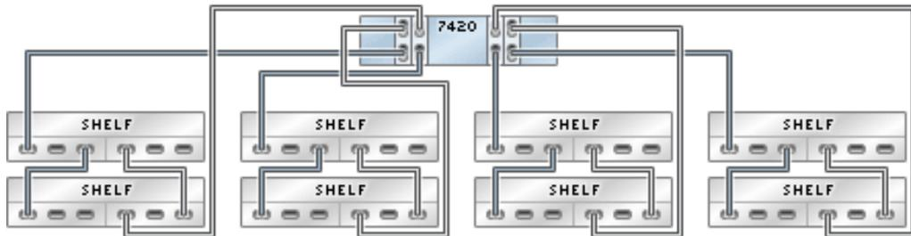
**FIGURE 225** Contrôleur 7420 autonome avec quatre HBA connectés à 24 étagères de disques Sun Disk Shelf dans quatre chaînes
