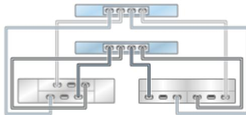
**FIGURE 338** Contrôleurs ZS3-2 en cluster avec un HBA connecté à plusieurs étagères de disques mixtes dans deux chaînes (DE2-24 affiché à gauche)
