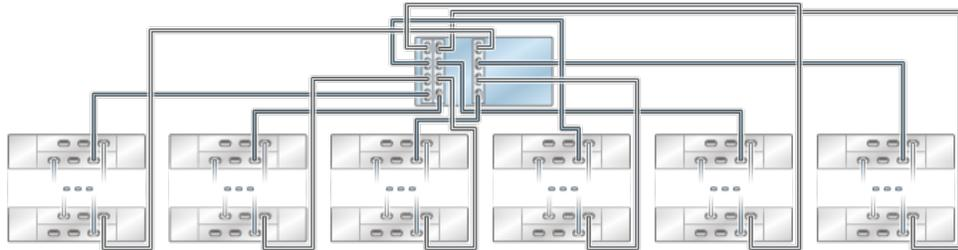
**FIGURE 18** Plusieurs étagères de disques dans une chaîne unique
