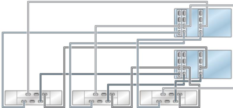
**FIGURE 108** Contrôleurs 7420 en cluster avec trois HBA connectés à quatre étagères de disques DE2-24 dans quatre chaînes
