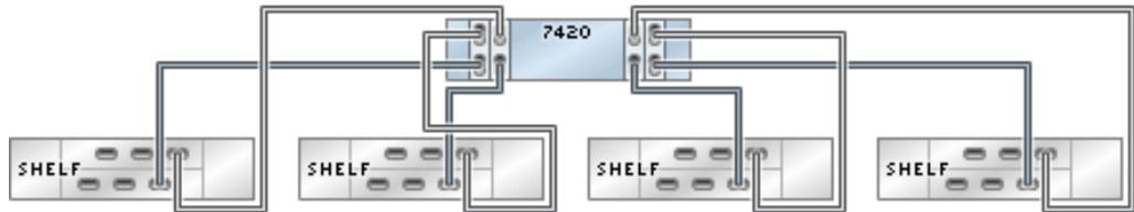
**FIGURE 146** Contrôleur 7420 autonome avec quatre HBA connectés à huit étagères de disques DE2-24 dans quatre chaînes
