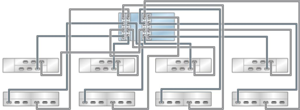
**FIGURE 300** Contrôleurs ZS4-4/ZS3-4 autonomes avec quatre HBA connectés à plusieurs étagères de disques mixtes dans huit chaînes (DE2-24 affiché en haut)
