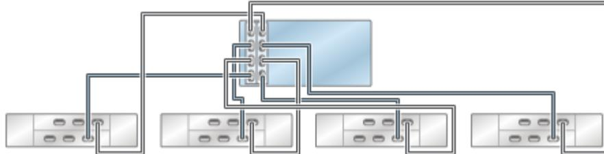
**FIGURE 9** Contrôleur ZS4-4/ZS3-4 autonome avec deux HBA connectés à plusieurs étagères de disques DE2-24 dans quatre chaînes
