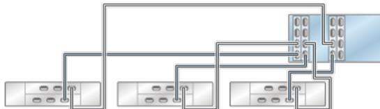
**FIGURE 22** Contrôleur ZS4-4/ZS3-4 autonome avec quatre HBA connectés à quatre étagères de disques DE2-24 dans quatre chaînes
