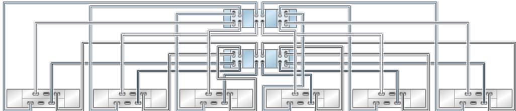
**FIGURE 198** Contrôleurs 7420 en cluster avec six HBA connectés à 12 étagères de disques DE2-24 dans six chaînes
