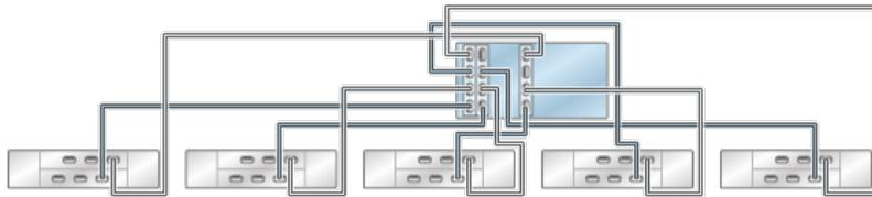
**FIGURE 16** Contrôleur ZS4-4/ZS3-4 autonome avec trois HBA connectés à six étagères de disques DE2-24 dans six chaînes
