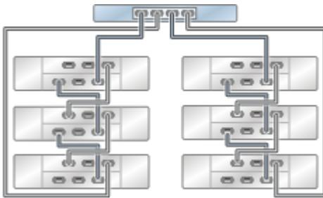
**FIGURE 56** Plusieurs étagères de disques dans une chaîne unique
