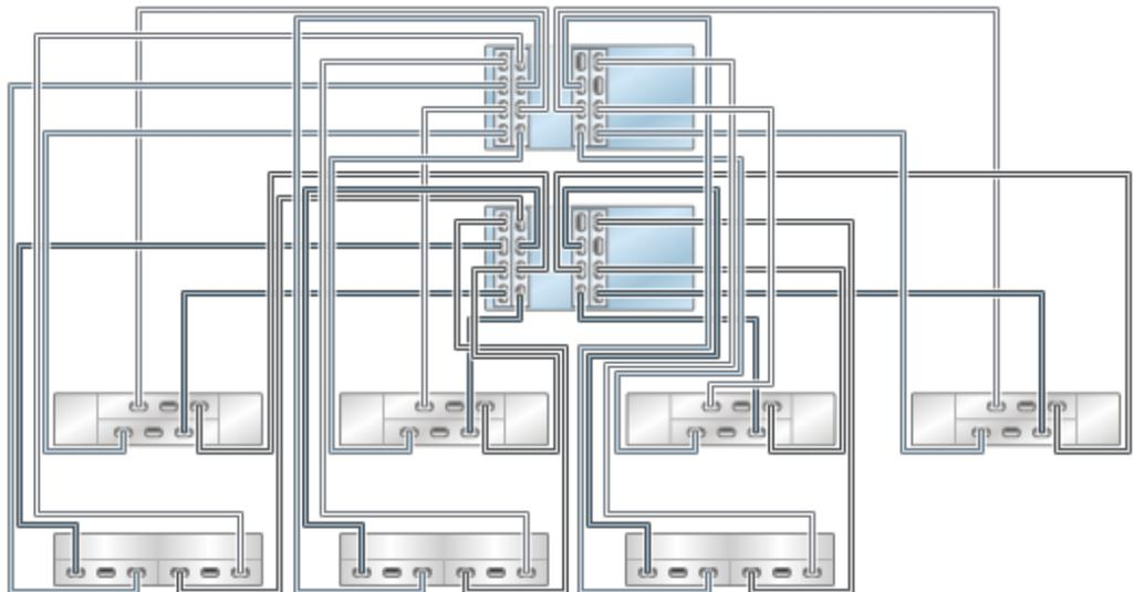
**FIGURE 391** Contrôleurs 7420 en cluster avec quatre HBA connectés à huit étagères de disques mixtes dans huit chaînes (DE2-24 affiché en haut)
