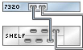
**FIGURE 202** Contrôleur 7320 autonome avec un HBA connecté à deux étagères de disques DE2-24 dans une chaîne unique
