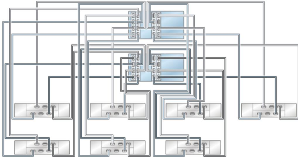
**FIGURE 50** Contrôleurs ZS4-4/ZS3-4 en cluster avec quatre HBA connectés à huit étagères de disques DE2-24 dans huit chaînes
