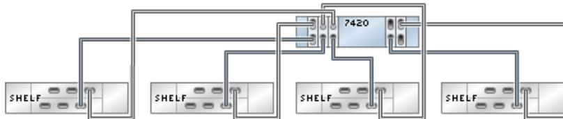
**FIGURE 153** Contrôleur 7420 autonome avec cinq HBA connectés à cinq étagères de disques DE2-24 dans cinq chaînes
