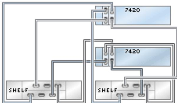
**FIGURE 168** Contrôleurs 7420 en cluster avec deux HBA connectés à quatre étagères de disques DE2-24 dans deux chaînes
