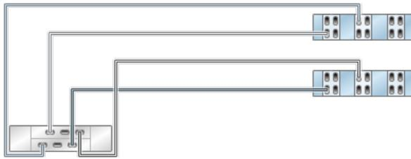
**FIGURE 193** Contrôleurs 7420 en cluster avec six HBA connectés à deux étagères de disques DE2-24 dans deux chaînes
