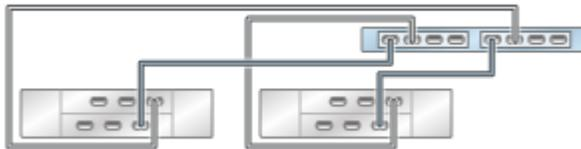
**FIGURE 59** Contrôleur ZS3-2 autonome avec deux HBA connectés à trois étagères de disques DE2-24 dans trois chaînes
