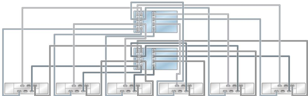
**FIGURE 111** Contrôleurs 7420 en cluster avec trois HBA connectés à plusieurs étagères de disques DE2-24 dans six chaînes
