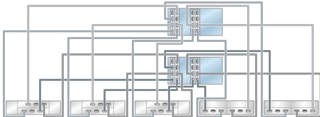
**FIGURE 389** Contrôleurs 7420 en cluster avec quatre HBA connectés à six étagères de disques mixtes dans six chaînes (DE2-24 affiché à gauche)
