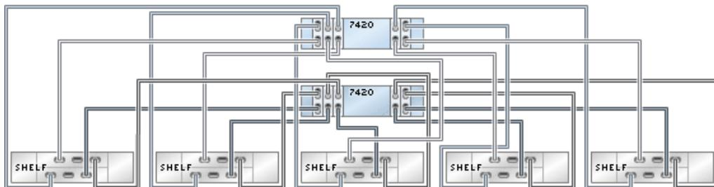
**FIGURE 189** Contrôleurs 7420 en cluster avec cinq HBA connectés à dix étagères de disques DE2-24 dans cinq chaînes
