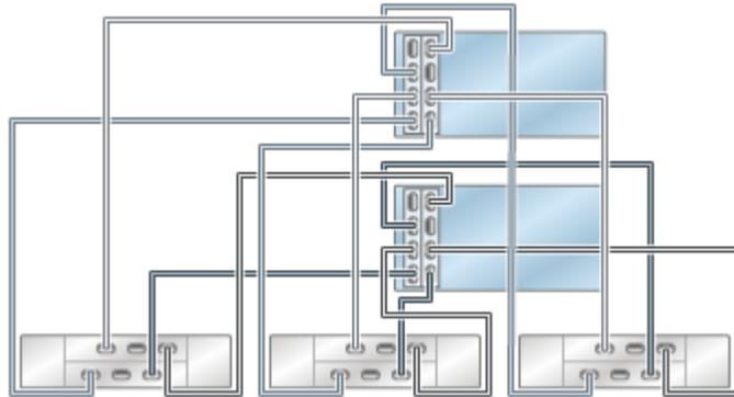
**FIGURE 102** Contrôleurs 7420 en cluster avec deux HBA connectés à quatre étagères de disques DE2-24 dans quatre chaînes
