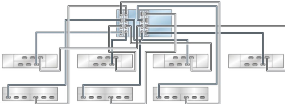
**FIGURE 367** Contrôleurs 7420 autonomes avec quatre HBA connectés à huit étagères de disques mixtes dans huit chaînes (DE2-24 affiché en haut)
