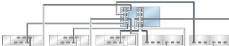
**FIGURE 297** Contrôleurs ZS4-4/ZS3-4 autonomes avec quatre HBA connectés à six étagères de disques mixtes dans six chaînes (DE2-24 affiché à gauche)
