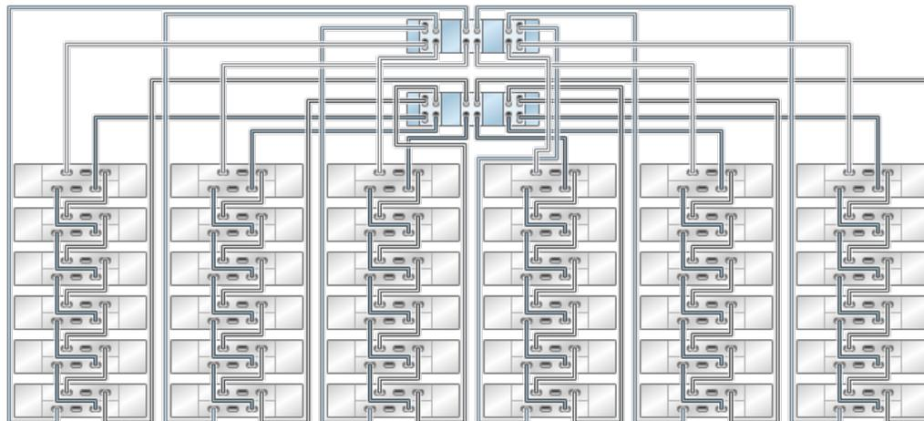
**FIGURE 200** Plusieurs étagères de disques dans une chaîne unique
