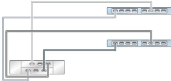
**FIGURE 69** Contrôleurs ZS3-2 en cluster avec deux HBA connectés à deux étagères de disques DE2-24 dans deux chaînes
