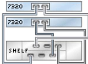
**FIGURE 206** Contrôleurs 7320 en cluster avec un HBA connecté à deux étagères de disques DE2-24 dans une chaîne unique
