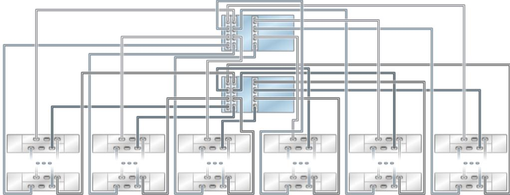
**FIGURE 112** Plusieurs étagères de disques dans une chaîne unique
