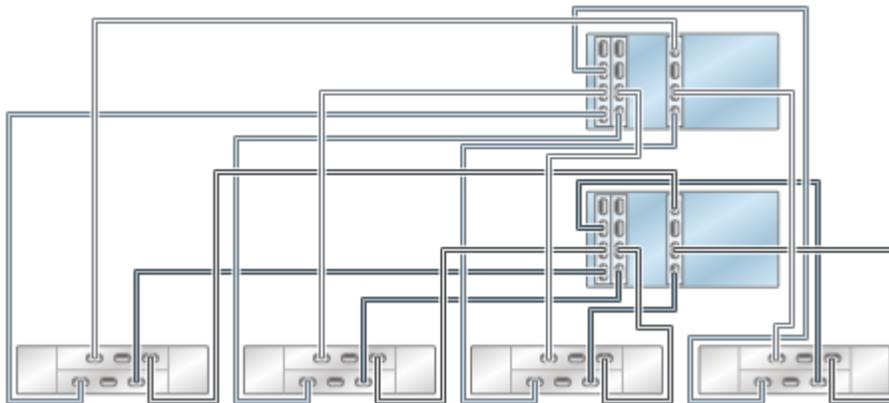
**FIGURE 109** Contrôleurs 7420 en cluster avec trois HBA connectés à cinq étagères de disques DE2-24 dans cinq chaînes
