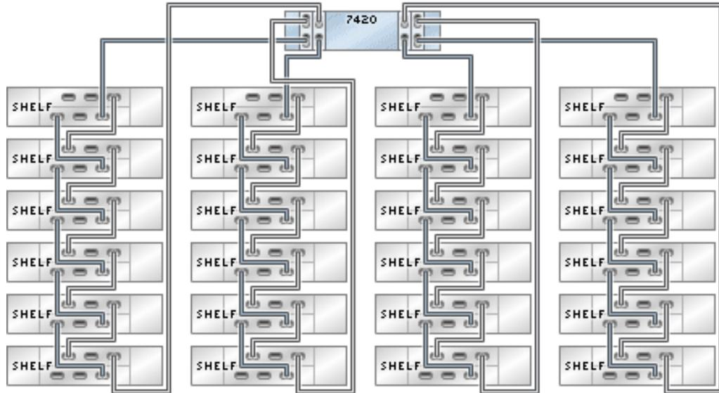
**FIGURE 148** Plusieurs étagères de disques dans une chaîne unique
