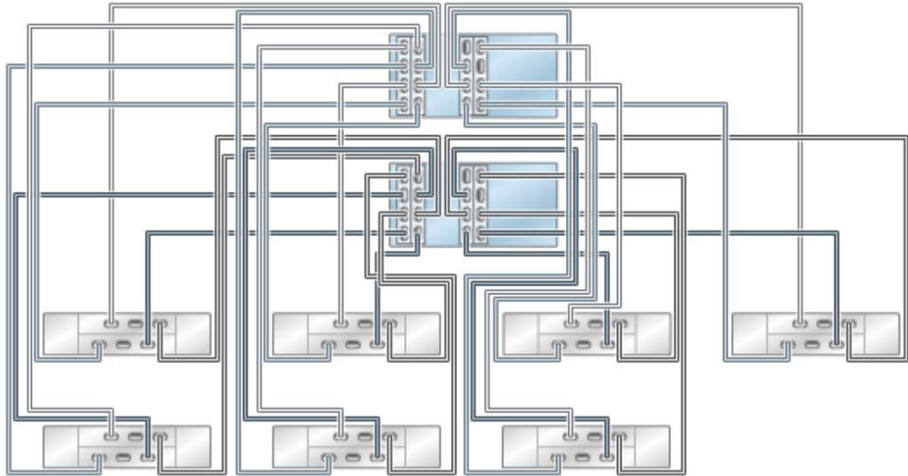
**FIGURE 120** Contrôleurs 7420 en cluster avec quatre HBA connectés à huit étagères de disques DE2-24 dans huit chaînes
