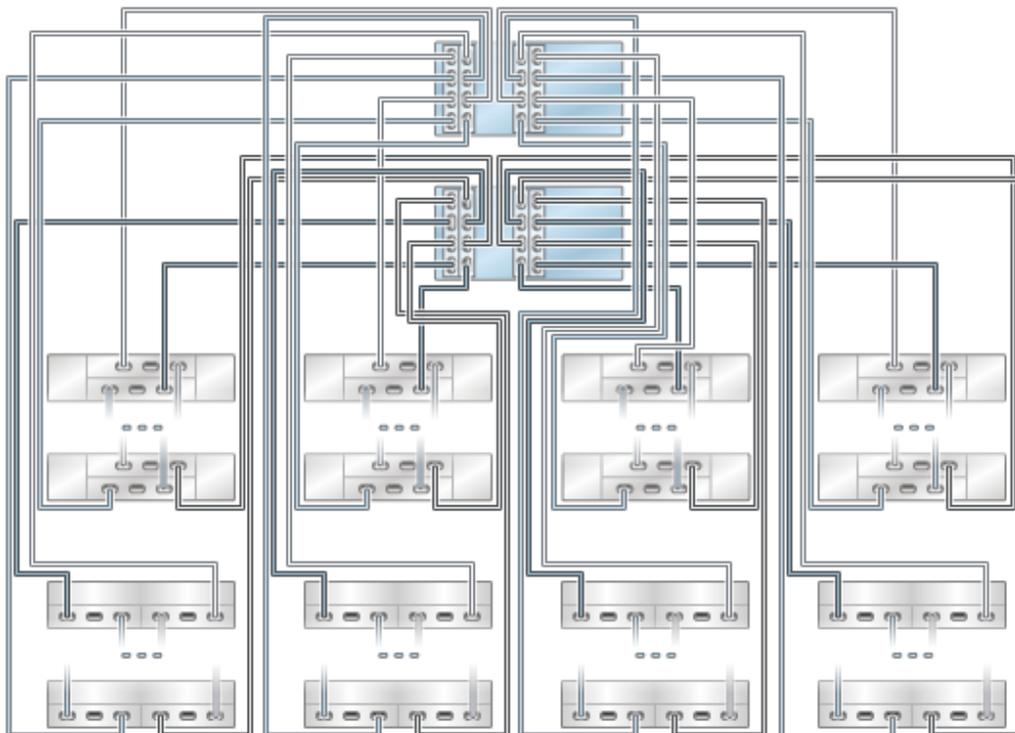
**FIGURE 393** Plusieurs étagères de disques DE2-24 dans une chaîne unique
