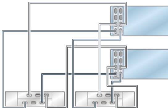
**FIGURE 101** Contrôleurs 7420 en cluster avec deux HBA connectés à trois étagères de disques DE2-24 dans trois chaînes
