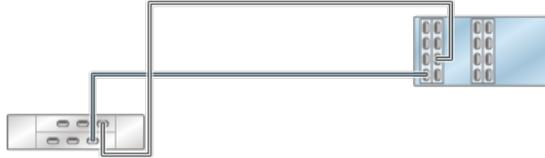
**FIGURE 20** Contrôleur ZS4-4/ZS3-4 autonome avec quatre HBA connectés à deux étagères de disques DE2-24 dans deux chaînes
