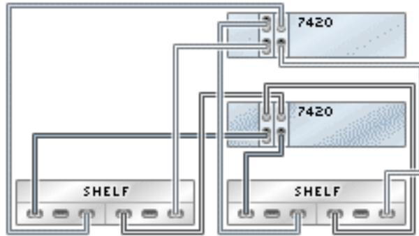
**FIGURE 243** Contrôleurs 7420 en cluster avec deux HBA connectés à quatre étagères de disques Sun Disk Shelf dans deux chaînes
