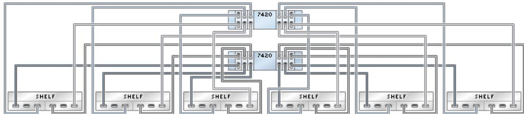
**FIGURE 269** Contrôleurs 7420 en cluster avec six HBA connectés à 12 étagères de disques Sun Disk Shelf dans six chaînes
