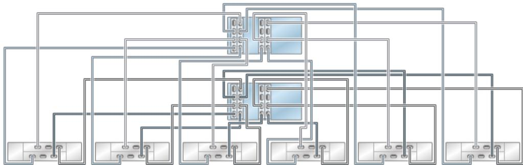
**FIGURE 49** Contrôleurs ZS4-4/ZS3-4 en cluster avec quatre HBA connectés à sept étagères de disques DE2-24 dans sept chaînes
