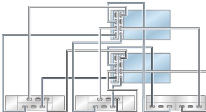
**FIGURE 305** Contrôleurs ZS4-4/ZS3-4 en cluster avec deux HBA connectés à quatre étagères de disques mixtes dans quatre chaînes (DE2-24 affiché à gauche)
