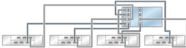
**FIGURE 85** Contrôleur 7420 autonome avec trois HBA connectés à cinq étagères de disques DE2-24 dans cinq chaînes
