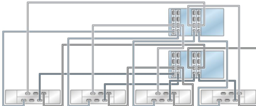
**FIGURE 47** Contrôleurs ZS4-4/ZS3-4 en cluster avec quatre HBA connectés à cinq étagères de disques DE2-24 dans cinq chaînes
