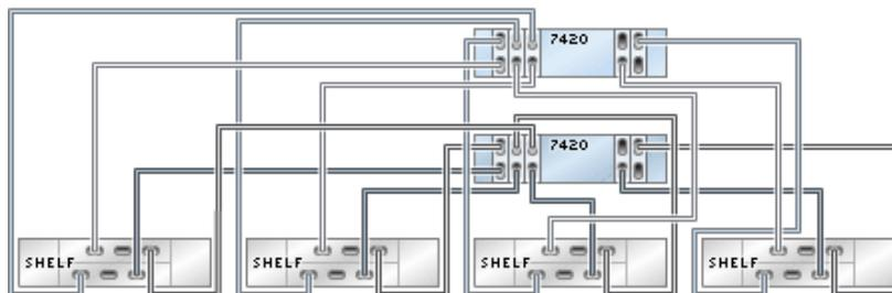
**FIGURE 188** Contrôleurs 7420 en cluster avec cinq HBA connectés à dix étagères de disques DE2-24 dans cinq chaînes
