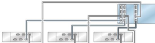
**FIGURE 84** Contrôleur 7420 autonome avec trois HBA connectés à quatre étagères de disques DE2-24 dans quatre chaînes
