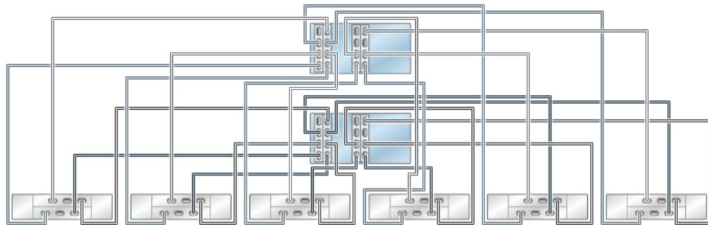
**FIGURE 119** Contrôleurs 7420 en cluster avec quatre HBA connectés à sept étagères de disques DE2-24 dans sept chaînes
