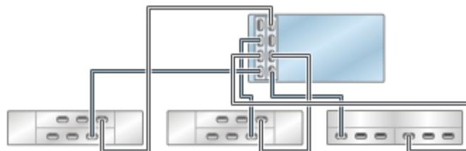
**FIGURE 8** Contrôleur ZS4-4/ZS3-4 autonome avec deux HBA connectés à quatre étagères de disques DE2-24 dans quatre chaînes
