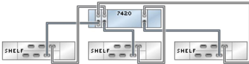
**FIGURE 139** Contrôleur 7420 autonome avec trois HBA connectés à six étagères de disques DE2-24 dans trois chaînes
