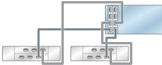
**FIGURE 77** Contrôleur 7420 autonome avec deux HBA connectés à trois étagères de disques DE2-24 dans trois chaînes
