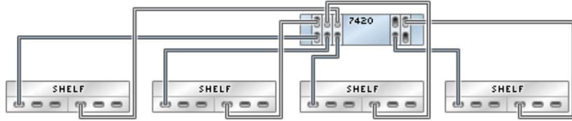
**FIGURE 230** Contrôleur 7420 autonome avec cinq HBA connectés à cinq étagères de disques Sun Disk Shelf dans cinq chaînes
