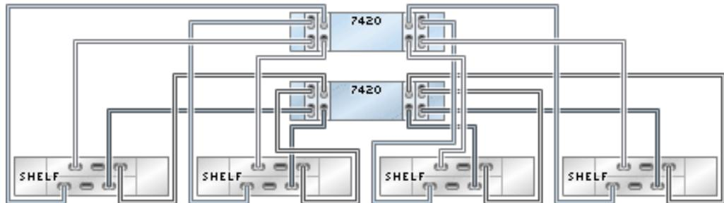
**FIGURE 181** Contrôleurs 7420 en cluster avec quatre HBA connectés à huit étagères de disques DE2-24 dans quatre chaînes
