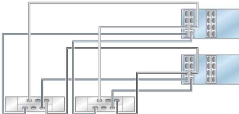
**FIGURE 115** Contrôleurs 7420 en cluster avec quatre HBA connectés à trois étagères de disques DE2-24 dans trois chaînes
