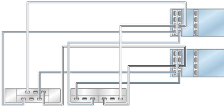
**FIGURE 310** Contrôleurs ZS4-4/ZS3-4 en cluster avec trois HBA connectés à trois étagères de disques mixtes dans trois chaînes (DE2-24 affiché à gauche)
