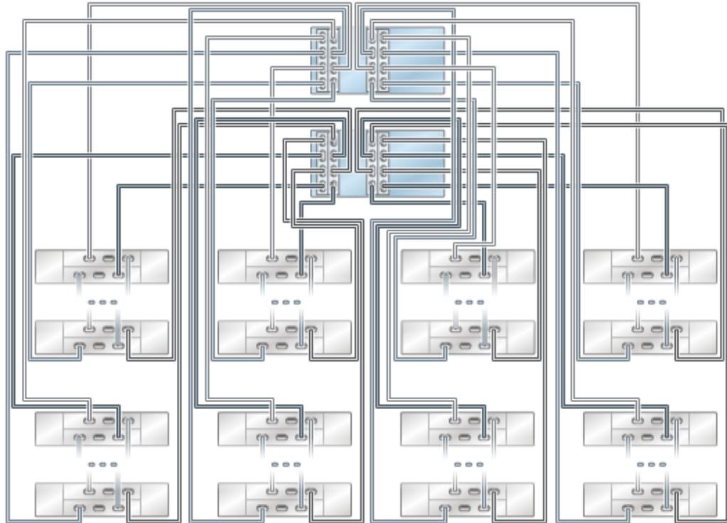
**FIGURE 52** Plusieurs étagères de disques dans une chaîne unique
