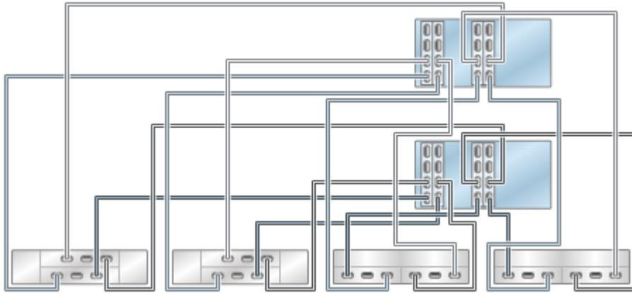
**FIGURE 320** Contrôleurs ZS4-4/ZS3-4 en cluster avec quatre HBA connectés à cinq étagères de disques mixtes dans cinq chaînes (DE2-24 affiché à gauche)
