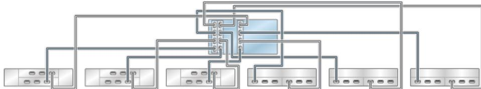
**FIGURE 290** Contrôleurs ZS4-4/ZS3-4 autonomes avec trois HBA connectés à plusieurs étagères de disques mixtes dans six chaînes (DE2-24 affiché à gauche)
