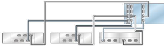
**FIGURE 355** Contrôleurs 7420 autonomes avec trois HBA connectés à quatre étagères de disques mixtes dans quatre chaînes (DE2-24 affiché à gauche)
