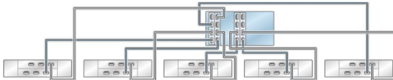
**FIGURE 94** Contrôleur 7420 autonome avec quatre HBA connectés à six étagères de disques DE2-24 dans six chaînes
