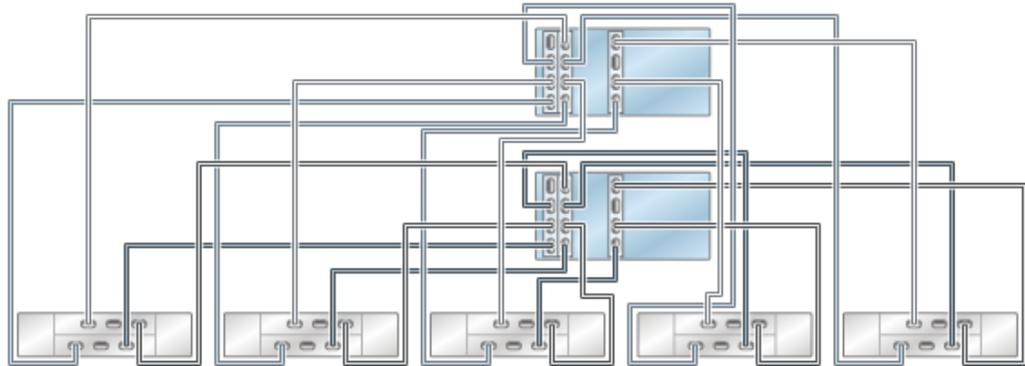
**FIGURE 110** Contrôleurs 7420 en cluster avec trois HBA connectés à six étagères de disques DE2-24 dans six chaînes
