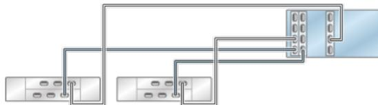
**FIGURE 13** Contrôleur ZS4-4/ZS3-4 autonome avec trois HBA connectés à trois étagères de disques DE2-24 dans trois chaînes
