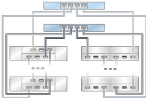
**FIGURE 401** Plusieurs étagères de disques DE2-24 dans une chaîne unique
