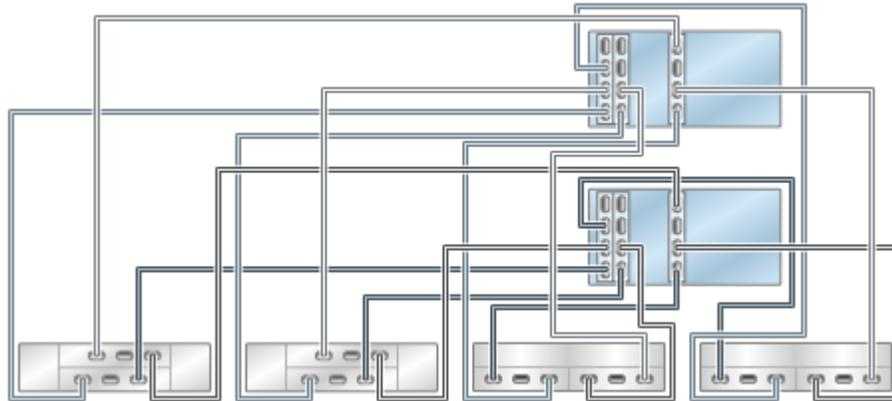
**FIGURE 380** Contrôleurs 7420 en cluster avec trois HBA connectés à cinq étagères de disques mixtes dans cinq chaînes (DE2-24 affiché à gauche)
