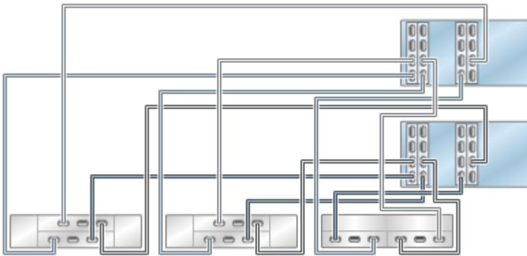
**FIGURE 319** Contrôleurs ZS4-4/ZS3-4 en cluster avec quatre HBA connectés à quatre étagères de disques mixtes dans quatre chaînes (DE2-24 affiché à gauche)
