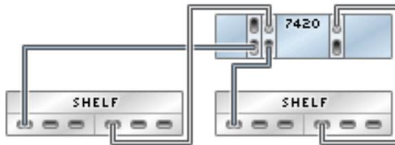
**FIGURE 217** Contrôleur 7420 autonome avec trois HBA connectés à trois étagères de disques Sun Disk Shelf dans trois chaînes
