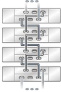
**FIGURE 302** Plusieurs étagères de disques Sun Disk Shelf dans une chaîne unique
