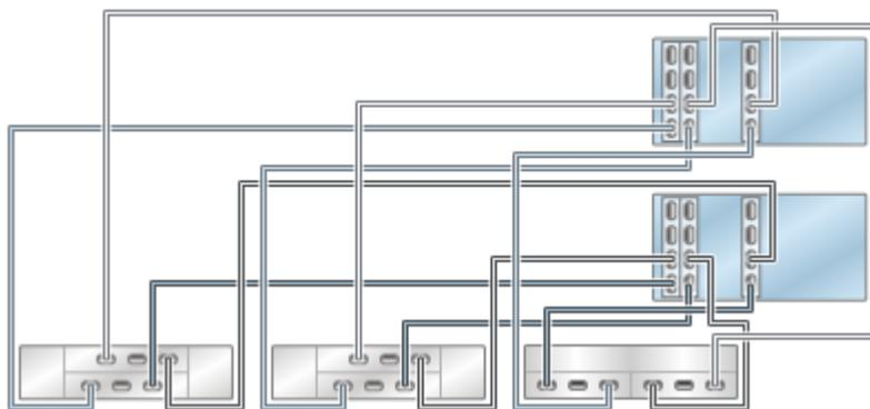
**FIGURE 379** Contrôleurs 7420 en cluster avec trois HBA connectés à quatre étagères de disques mixtes dans quatre chaînes (DE2-24 affiché à gauche)
