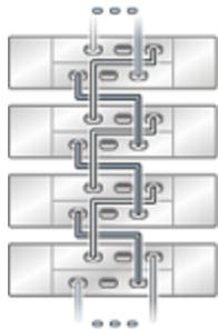
**FIGURE 360** Plusieurs étagères de disques Sun Disk Shelf dans une chaîne unique
