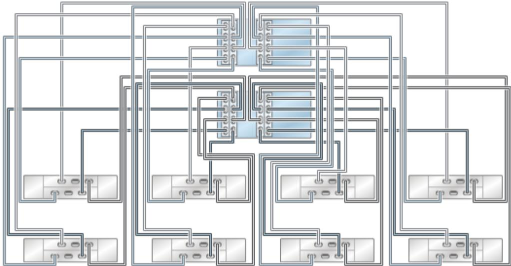
**FIGURE 51** Contrôleurs ZS4-4/ZS3-4 en cluster avec quatre HBA connectés à plusieurs étagères de disques DE2-24 dans huit chaînes
