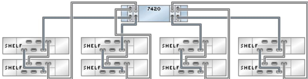
**FIGURE 147** Contrôleur 7420 autonome avec quatre HBA connectés à 24 étagères de disques DE2-24 dans quatre chaînes
