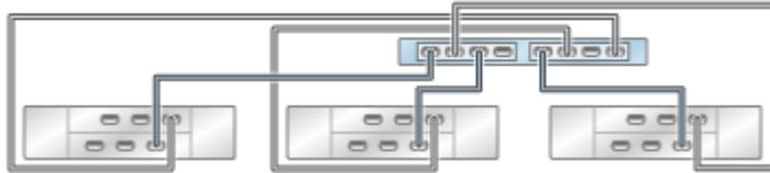
**FIGURE 60** Contrôleur ZS3-2 autonome avec deux HBA connectés à quatre étagères de disques DE2-24 dans quatre chaînes
