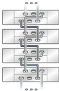
**FIGURE 284** Plusieurs étagères de disques Sun Disk Shelf dans une chaîne unique
