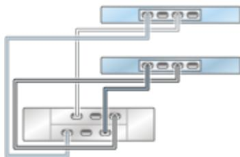
**FIGURE 128** Contrôleurs 7320 en cluster avec un HBA connecté à deux étagères de disques DE2-24 dans deux chaînes
