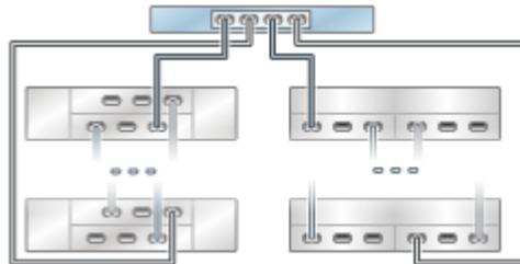
**FIGURE 329** Plusieurs étagères de disques DE2-24 dans une chaîne unique
