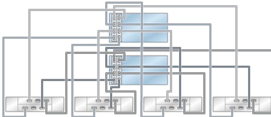
**FIGURE 103** Contrôleurs 7420 en cluster avec deux HBA connectés à plusieurs étagères de disques DE2-24 dans quatre chaînes
