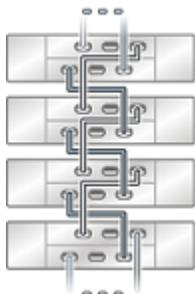
**FIGURE 394** Plusieurs étagères de disques Sun Disk Shelf dans une chaîne unique
