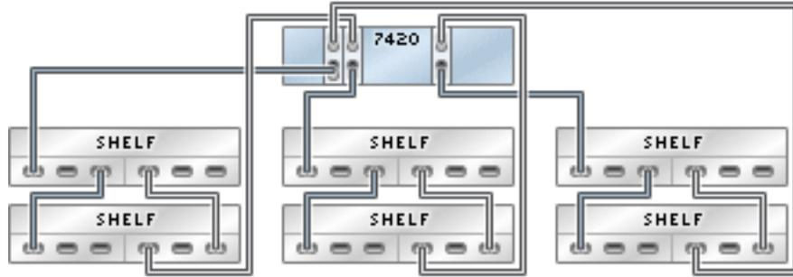
**FIGURE 219** Contrôleur 7420 autonome avec trois HBA connectés à 18 étagères de disques Sun Disk Shelf dans trois chaînes
