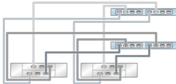
**FIGURE 70** Contrôleurs ZS3-2 en cluster avec deux HBA connectés à trois étagères de disques DE2-24 dans trois chaînes
