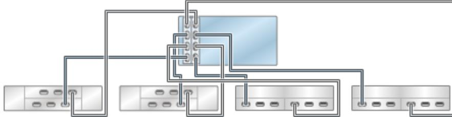
**FIGURE 282** Contrôleurs ZS4-4/ZS3-4 autonomes avec deux HBA connectés à plusieurs étagères de disques mixtes dans quatre chaînes (DE2-24 affiché à gauche)
