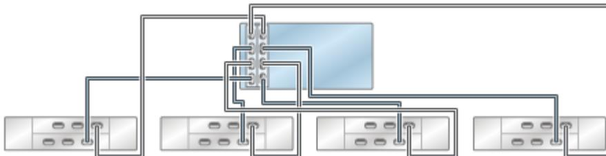
**FIGURE 79** Contrôleur 7420 autonome avec deux HBA connectés à plusieurs étagères de disques DE2-24 dans quatre chaînes
