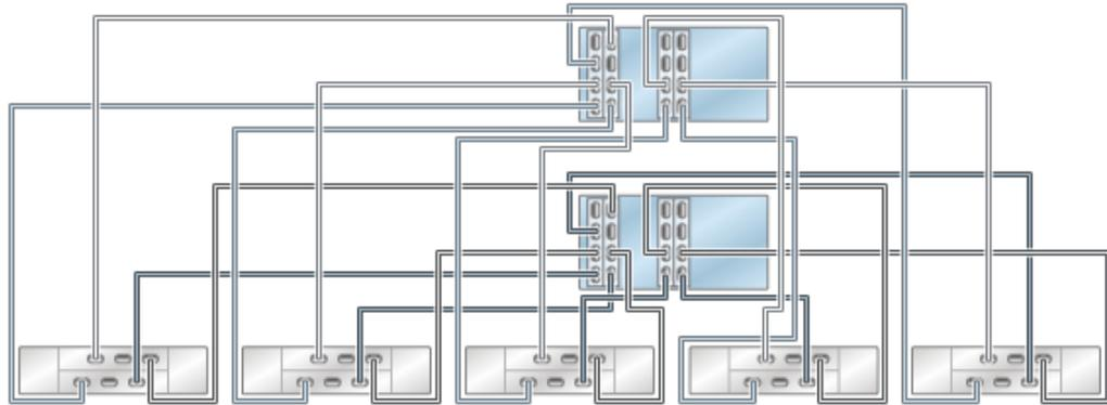
**FIGURE 118** Contrôleurs 7420 en cluster avec quatre HBA connectés à six étagères de disques DE2-24 dans six chaînes
