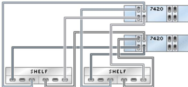
**FIGURE 252** Contrôleurs 7420 en cluster avec quatre HBA connectés à trois étagères de disques Sun Disk Shelf dans trois chaînes
