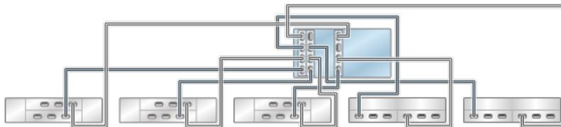
**FIGURE 289** Contrôleurs ZS4-4/ZS3-4 autonomes avec trois HBA connectés à six étagères de disques mixtes dans six chaînes (DE2-24 affiché à gauche)
