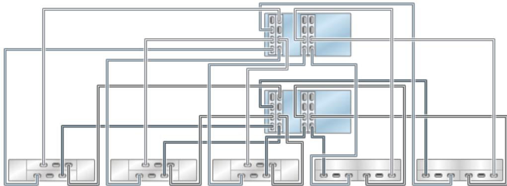
**FIGURE 321** Contrôleurs ZS4-4/ZS3-4 en cluster avec quatre HBA connectés à six étagères de disques mixtes dans six chaînes (DE2-24 affiché à gauche)
