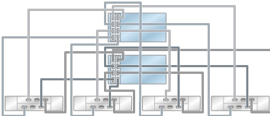
**FIGURE 33** Contrôleurs ZS4-4/ZS3-4 en cluster avec deux HBA connectés à plusieurs étagères de disques DE2-24 dans quatre chaînes
