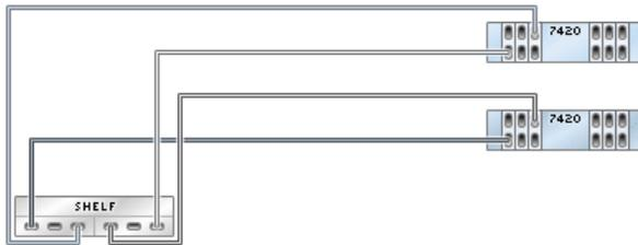
**FIGURE 264** Contrôleurs 7420 en cluster avec six HBA connectés à deux étagères de disques Sun Disk Shelf dans deux chaînes
