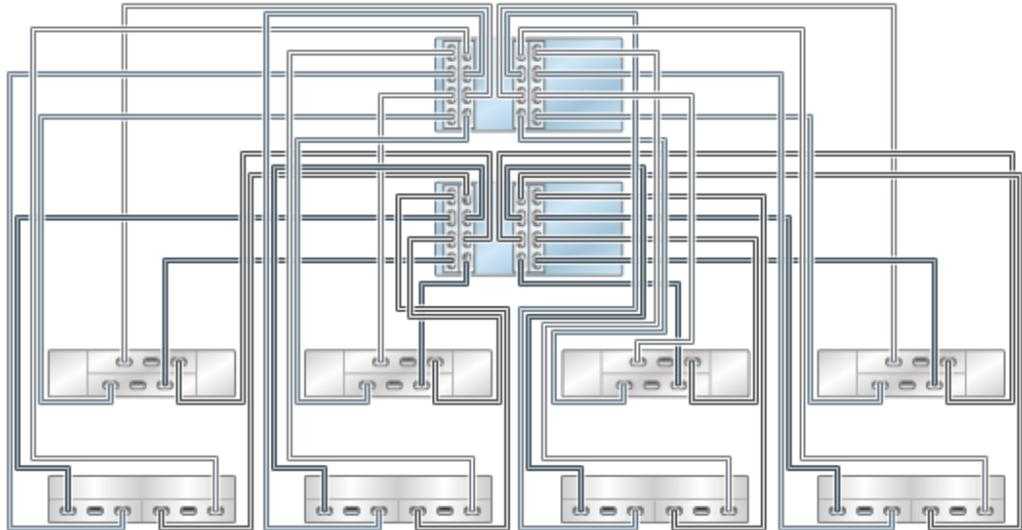
**FIGURE 324** Contrôleurs ZS4-4/ZS3-4 en cluster avec quatre HBA connectés à plusieurs étagères de disques mixtes dans huit chaînes (DE2-24 affiché en haut)
