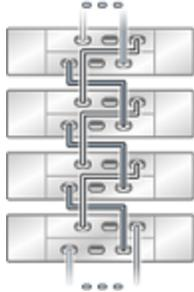
**FIGURE 376** Plusieurs étagères de disques Sun Disk Shelf dans une chaîne unique
