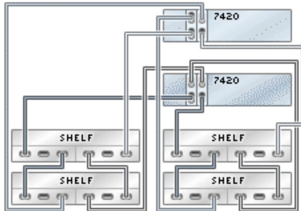
**FIGURE 244** Contrôleurs 7420 en cluster avec deux HBA connectés à 12 étagères de disques Sun Disk Shelf dans deux chaînes
