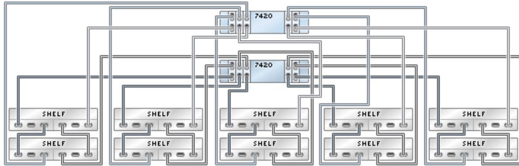
**FIGURE 262** Contrôleurs 7420 en cluster avec cinq HBA connectés à 30 étagères de disques Sun Disk Shelf dans cinq chaînes
