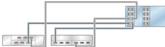
**FIGURE 362** Contrôleurs 7420 autonomes avec quatre HBA connectés à trois étagères de disques mixtes dans trois chaînes (DE2-24 affiché à gauche)
