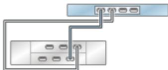
**FIGURE 124** Contrôleur 7320 autonome avec un HBA connecté à deux étagères de disques DE2-24 dans deux chaînes
