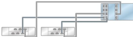
**FIGURE 83** Contrôleur 7420 autonome avec trois HBA connectés à trois étagères de disques DE2-24 dans trois chaînes
