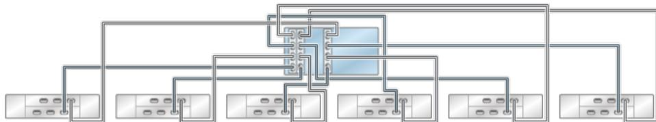
**FIGURE 87** Contrôleur 7420 autonome avec trois HBA connectés à plusieurs étagères de disques DE2-24 dans six chaînes
