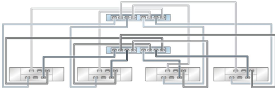
**FIGURE 72** Contrôleurs ZS3-2 en cluster avec deux HBA connectés à huit étagères de disques DE2-24 dans quatre chaînes
