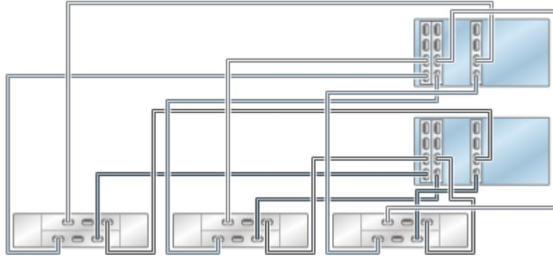
**FIGURE 38** Contrôleurs ZS4-4/ZS3-4 en cluster avec trois HBA connectés à quatre étagères de disques DE2-24 dans quatre chaînes
