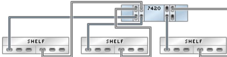
**FIGURE 223** Contrôleur 7420 autonome avec quatre HBA connectés à quatre étagères de disques Sun Disk Shelf dans quatre chaînes
