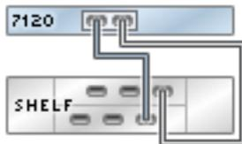
**FIGURE 210** Contrôleur 7120 autonome avec un HBA connecté à deux étagères de disques DE2-24 dans une chaîne unique
