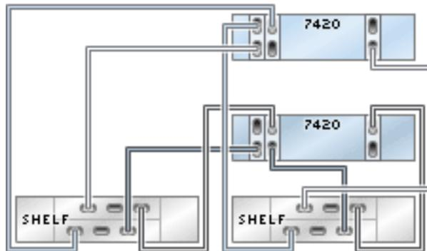
**FIGURE 173** Contrôleurs 7420 en cluster avec trois HBA connectés à trois étagères de disques DE2-24 dans trois chaînes
