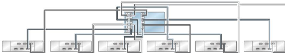
**FIGURE 17** Contrôleur ZS4-4/ZS3-4 autonome avec trois HBA connectés à plusieurs étagères de disques DE2-24 dans six chaînes
