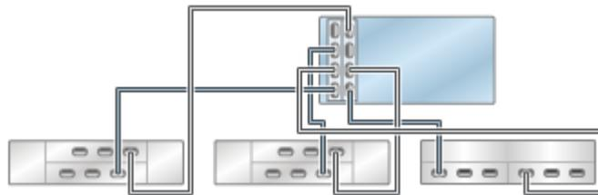
**FIGURE 78** Contrôleur 7420 autonome avec deux HBA connectés à quatre étagères de disques DE2-24 dans quatre chaînes
