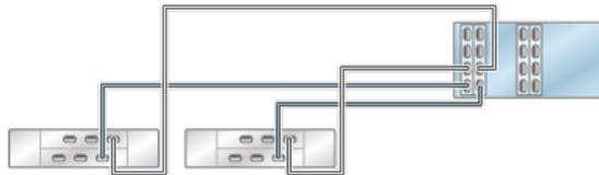
**FIGURE 91** Contrôleur 7420 autonome avec quatre HBA connectés à trois étagères de disques DE2-24 dans trois chaînes
