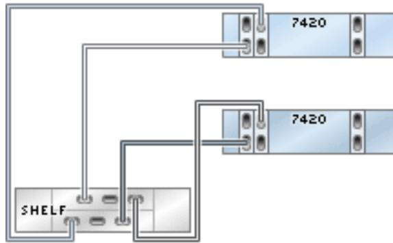
**FIGURE 172** Contrôleurs 7420 en cluster avec trois HBA connectés à deux étagères de disques DE2-24 dans deux chaînes
