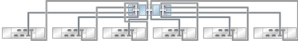
**FIGURE 163** Contrôleur 7420 autonome avec six HBA connectés à 12 étagères de disques DE2-24 dans six chaînes
