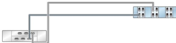
**FIGURE 158** Contrôleur 7420 autonome avec six HBA connectés à deux étagères de disques DE2-24 dans deux chaînes
