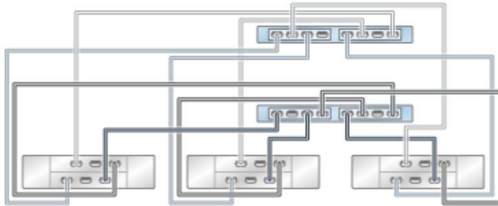
**FIGURE 71** Contrôleurs ZS3-2 en cluster avec deux HBA connectés à quatre étagères de disques DE2-24 dans quatre chaînes
