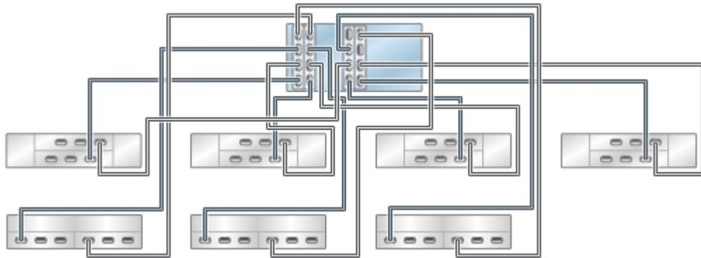
**FIGURE 299** Contrôleurs ZS4-4/ZS3-4 autonomes avec quatre HBA connectés à huit étagères de disques mixtes dans huit chaînes (DE2-24 affiché en haut)
