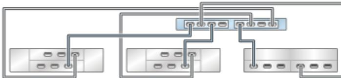
**FIGURE 333** Contrôleur ZS3-2 autonome avec deux HBA connectés à quatre étagères de disques mixtes dans quatre chaînes (DE2-24 affiché à gauche)
