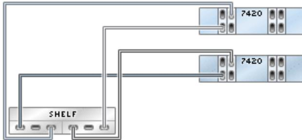
**FIGURE 251** Contrôleurs 7420 en cluster avec quatre HBA connectés à deux étagères de disques Sun Disk Shelf dans deux chaînes
