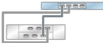
**FIGURE 54** Contrôleur ZS3-2 autonome avec un HBA connecté à deux étagères de disques DE2-24 dans deux chaînes
