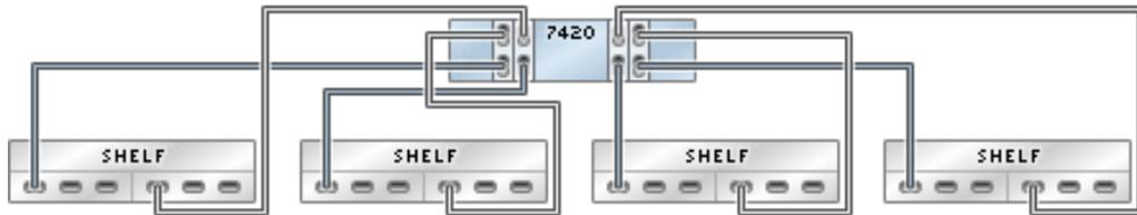
**FIGURE 224** Contrôleur 7420 autonome avec quatre HBA connectés à huit étagères de disques Sun Disk Shelf dans quatre chaînes
