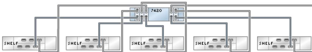
**FIGURE 154** Contrôleur 7420 autonome avec cinq HBA connectés à dix étagères de disques DE2-24 dans cinq chaînes
