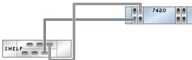
**FIGURE 143** Contrôleur 7420 autonome avec quatre HBA connectés à deux étagères de disques DE2-24 dans deux chaînes
