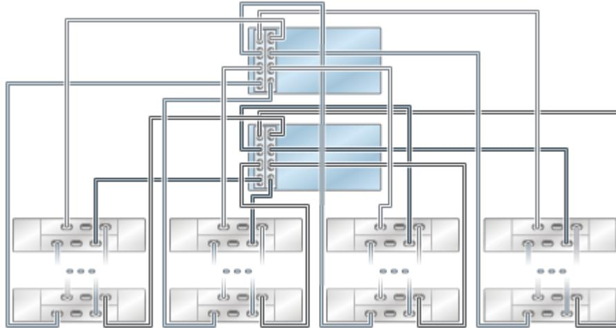
**FIGURE 34** Plusieurs étagères de disques dans une chaîne unique
