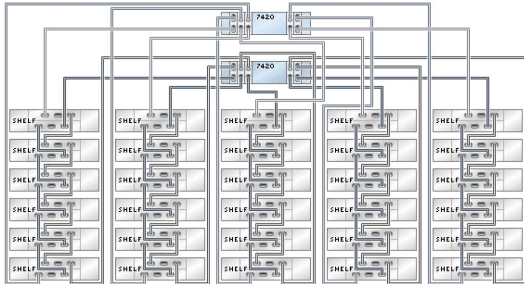
**FIGURE 191** Plusieurs étagères de disques dans une chaîne unique
