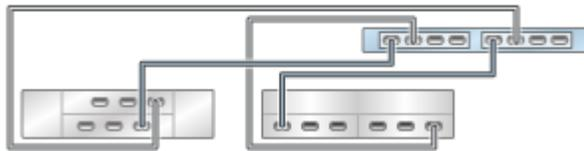
**FIGURE 332** Contrôleur ZS3-2 autonome avec deux HBA connectés à trois étagères de disques mixtes dans trois chaînes (DE2-24 affiché à gauche)
