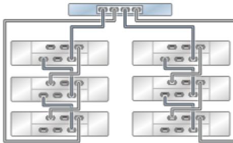
**FIGURE 126** Plusieurs étagères de disques dans une chaîne unique
