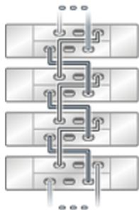
**FIGURE 384** Plusieurs étagères de disques Sun Disk Shelf dans une chaîne unique
