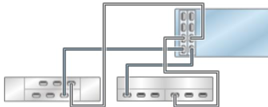
**FIGURE 280** Contrôleurs ZS4-4/ZS3-4 autonomes avec deux HBA connectés à trois étagères de disques mixtes dans trois chaînes (DE2-24 affiché à gauche)
