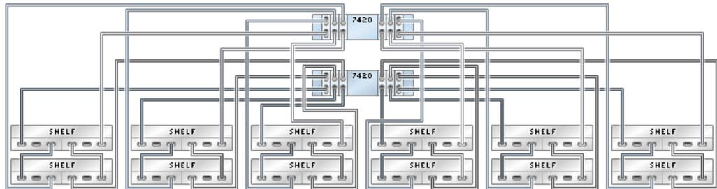
**FIGURE 270** Contrôleurs 7420 en cluster avec six HBA connectés à 36 étagères de disques Sun Disk Shelf dans six chaînes
