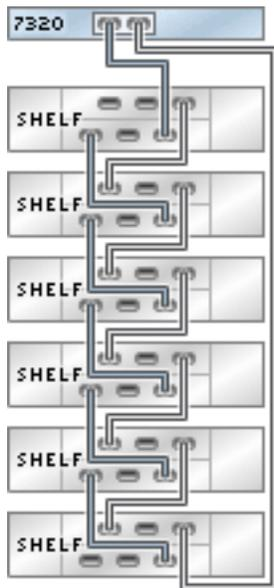
**FIGURE 204** Plusieurs étagères de disques dans une chaîne unique
