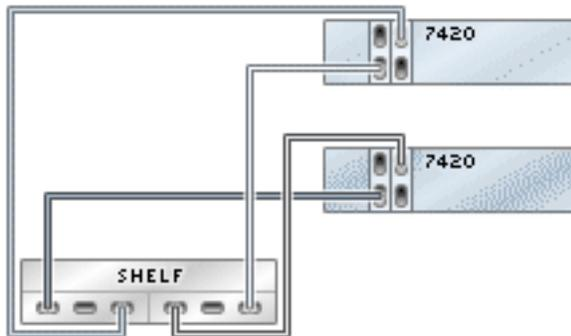
**FIGURE 242** Contrôleurs 7420 en cluster avec deux HBA connectés à deux étagères de disques Sun Disk Shelf dans deux chaînes
