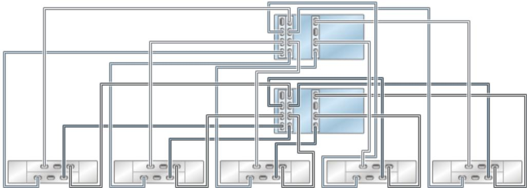
**FIGURE 40** Contrôleurs ZS4-4/ZS3-4 en cluster avec trois HBA connectés à six étagères de disques DE2-24 dans six chaînes
