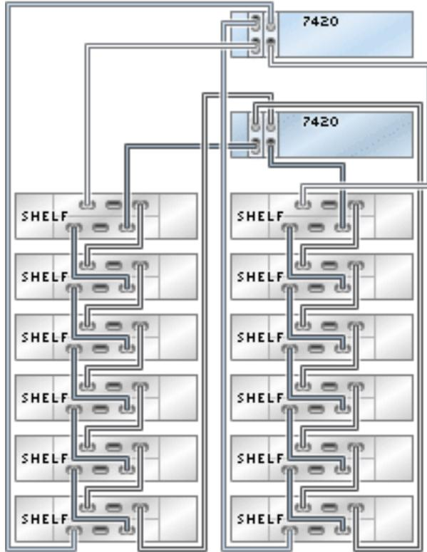
**FIGURE 170** Plusieurs étagères de disques dans une chaîne unique
