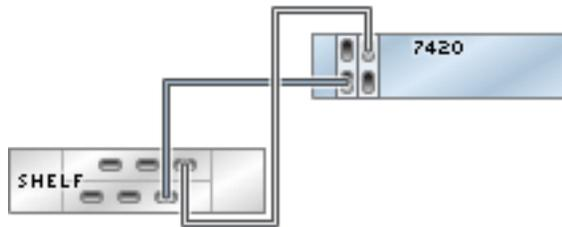
**FIGURE 132** Contrôleur 7420 autonome avec deux HBA connectés à deux étagères de disques DE2-24 dans deux chaînes
