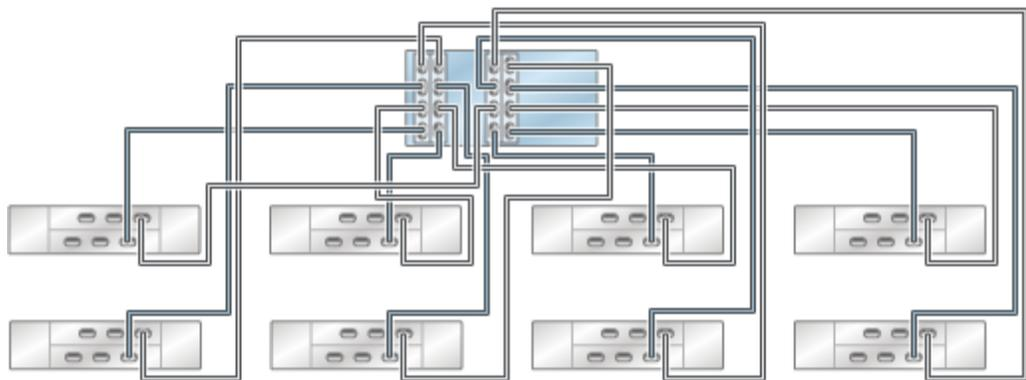
**FIGURE 27** Contrôleur ZS4-4/ZS3-4 autonome avec quatre HBA connectés à plusieurs étagères de disques DE2-24 dans huit chaînes
