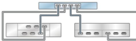
**FIGURE 396** Contrôleur 7320 autonome avec un HBA connecté à plusieurs étagères de disques mixtes dans deux chaînes (DE2-24 affiché à gauche)
