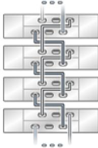
**FIGURE 308** Plusieurs étagères de disques Sun Disk Shelf dans une chaîne unique
