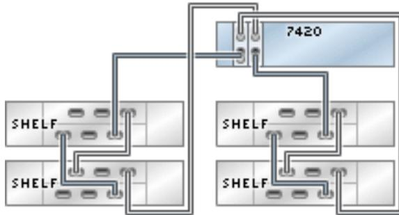
**FIGURE 134** Contrôleur 7420 autonome avec deux HBA connectés à 12 étagères de disques DE2-24 dans deux chaînes
