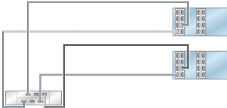
**FIGURE 44** Contrôleurs ZS4-4/ZS3-4 en cluster avec quatre HBA connectés à deux étagères de disques DE2-24 dans deux chaînes
