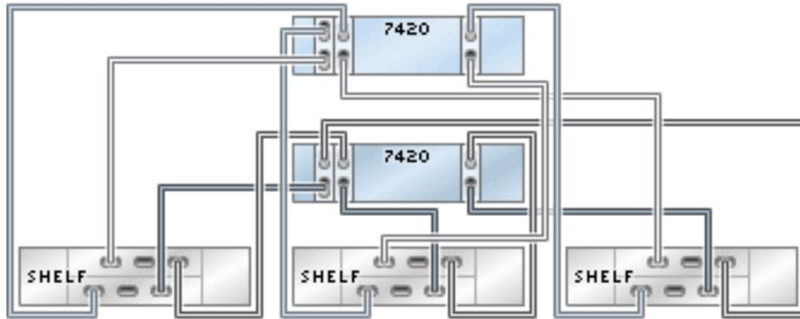
**FIGURE 174** Contrôleurs 7420 en cluster avec trois HBA connectés à six étagères de disques DE2-24 dans trois chaînes
