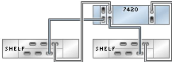
**FIGURE 138** Contrôleur 7420 autonome avec trois HBA connectés à trois étagères de disques DE2-24 dans trois chaînes
