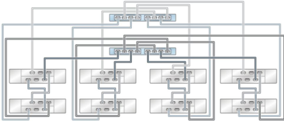
**FIGURE 73** Contrôleurs ZS3-2 en cluster avec deux HBA connectés à seize étagères de disques DE2-24 dans quatre chaînes
