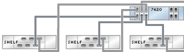
**FIGURE 152** Contrôleur 7420 autonome avec cinq HBA connectés à quatre étagères de disques DE2-24 dans quatre chaînes
