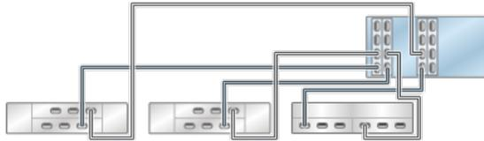
**FIGURE 363** Contrôleurs 7420 autonomes avec quatre HBA connectés à quatre étagères de disques mixtes dans quatre chaînes (DE2-24 affiché à gauche)
