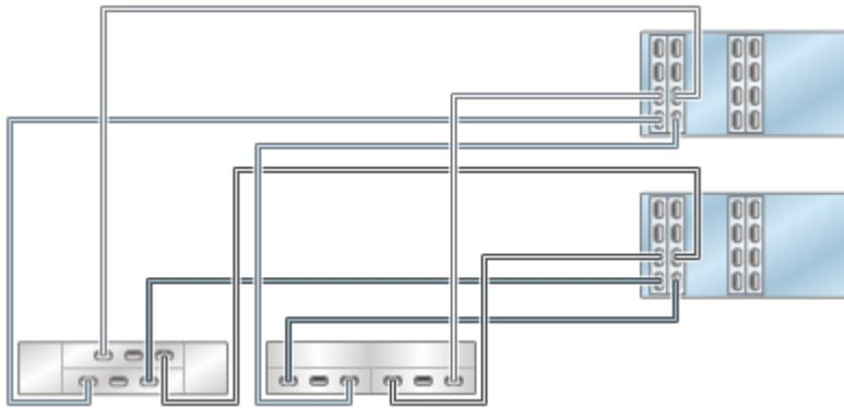
**FIGURE 318** Contrôleurs ZS4-4/ZS3-4 en cluster avec quatre HBA connectés à trois étagères de disques mixtes dans trois chaînes (DE2-24 affiché à gauche)
