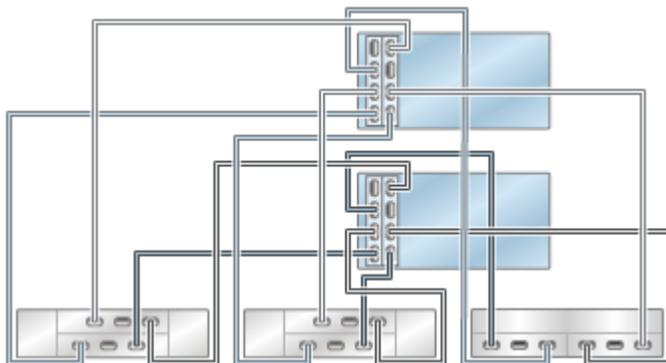
**FIGURE 373** Contrôleurs 7420 en cluster avec deux HBA connectés à quatre étagères de disques mixtes dans quatre chaînes (DE2-24 affiché à gauche)
