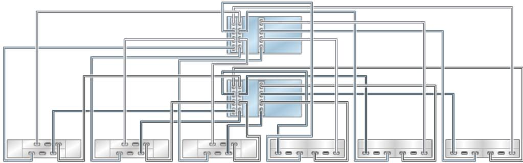
**FIGURE 382** Contrôleurs 7420 en cluster avec trois HBA connectés à plusieurs étagères de disques mixtes dans six chaînes (DE2-24 affiché à gauche)
