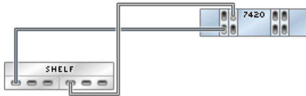
**FIGURE 221** Contrôleur 7420 autonome avec quatre HBA connectés à deux étagères de disques Sun Disk Shelf dans deux chaînes
