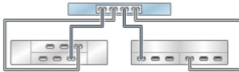
**FIGURE 328** Contrôleur ZS3-2 autonome avec un HBA connecté à plusieurs étagères de disques mixtes dans deux chaînes (DE2-24 affiché à gauche)
