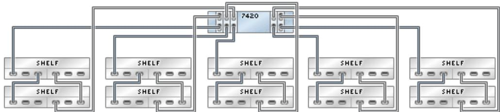
**FIGURE 232** Contrôleur 7420 autonome avec cinq HBA connectés à 30 étagères de disques Sun Disk Shelf dans cinq chaînes
