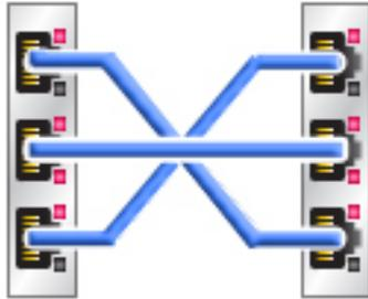
**FIGURE 4** Câblage de cluster de contrôleurs ZS3-2
