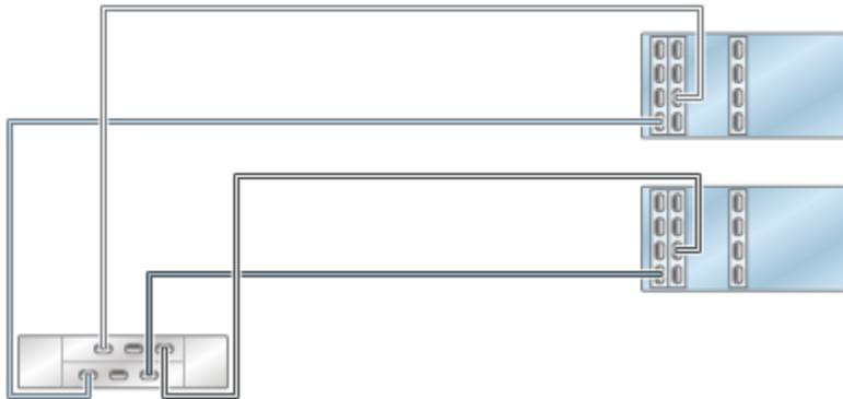
**FIGURE 36** Contrôleurs ZS4-4/ZS3-4 en cluster avec trois HBA connectés à deux étagères de disques DE2-24 dans deux chaînes
