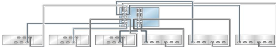
**FIGURE 298** Contrôleurs ZS4-4/ZS3-4 autonomes avec quatre HBA connectés à sept étagères de disques mixtes dans sept chaînes (DE2-24 affiché en haut)
