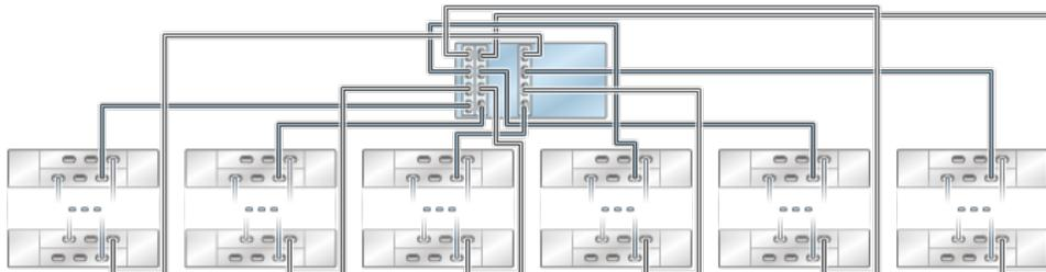
**FIGURE 88** Plusieurs étagères de disques dans une chaîne unique
