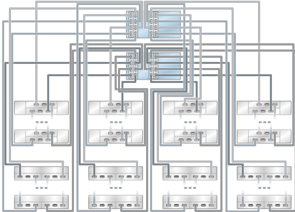
**FIGURE 325** Plusieurs étagères de disques DE2-24 dans une chaîne unique
