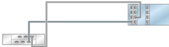
**FIGURE 12** Contrôleur ZS4-4/ZS3-4 autonome avec trois HBA connectés à deux étagères de disques DE2-24 dans deux chaînes
