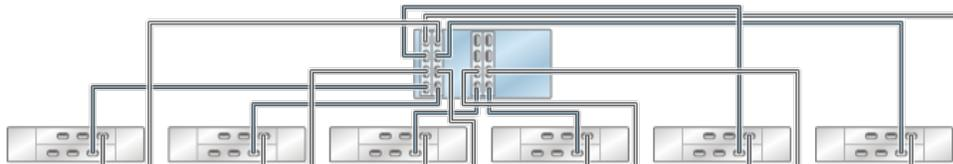
**FIGURE 95** Contrôleur 7420 autonome avec quatre HBA connectés à sept étagères de disques DE2-24 dans sept chaînes
