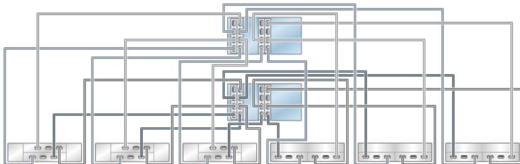
**FIGURE 322** Contrôleurs ZS4-4/ZS3-4 en cluster avec quatre HBA connectés à sept étagères de disques mixtes dans sept chaînes (DE2-24 affiché en haut)
