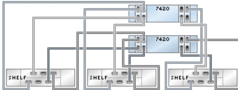
**FIGURE 180** Contrôleurs 7420 en cluster avec quatre HBA connectés à quatre étagères de disques DE2-24 dans quatre chaînes
