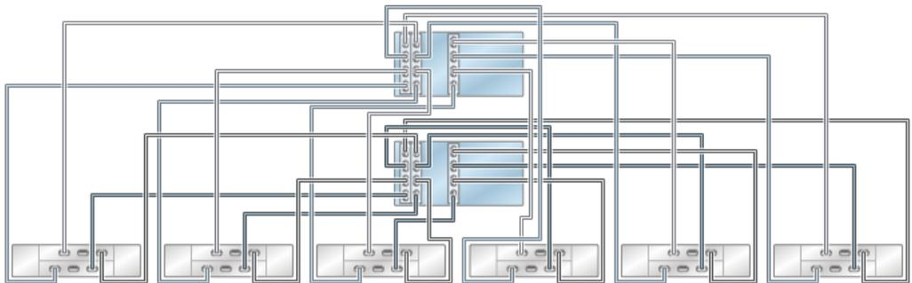
**FIGURE 41** Contrôleurs ZS4-4/ZS3-4 en cluster avec trois HBA connectés à plusieurs étagères de disques DE2-24 dans six chaînes
