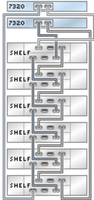
**FIGURE 208** Plusieurs étagères de disques dans une chaîne unique
