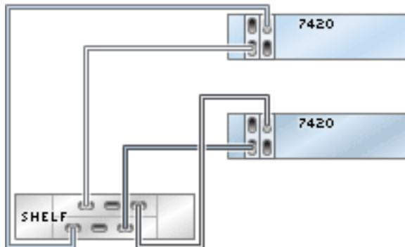
**FIGURE 167** Contrôleurs 7420 en cluster avec deux HBA connectés à deux étagères de disques DE2-24 dans deux chaînes
