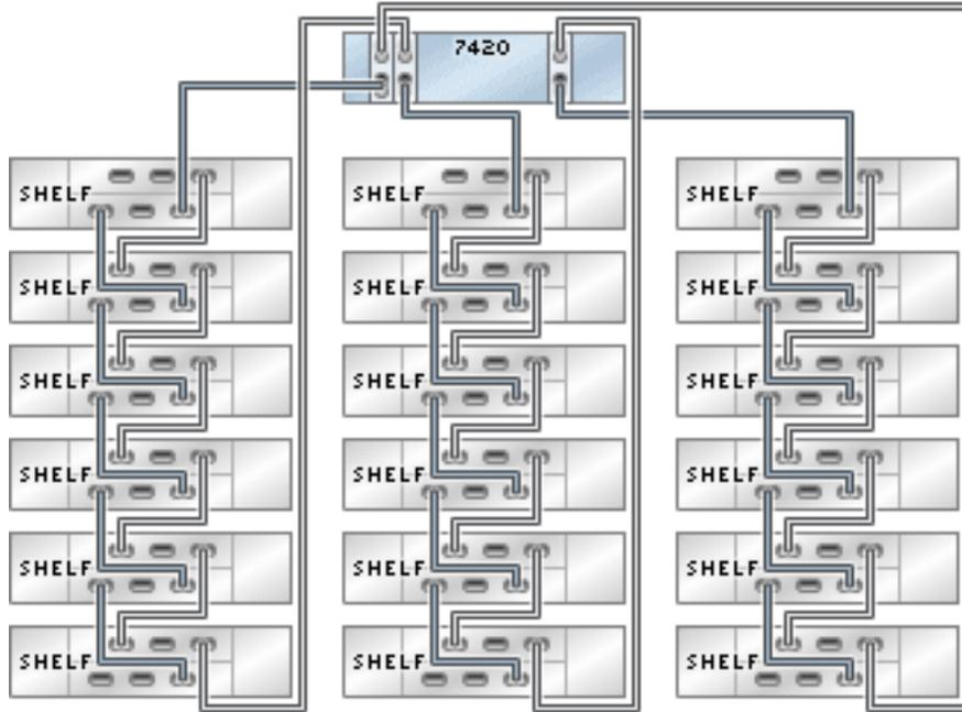
**FIGURE 141** Plusieurs étagères de disques dans une chaîne unique
