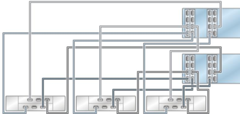
**FIGURE 46** Contrôleurs ZS4-4/ZS3-4 en cluster avec quatre HBA connectés à quatre étagères de disques DE2-24 dans quatre chaînes
