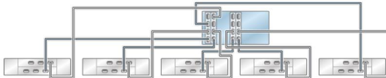
**FIGURE 24** Contrôleur ZS4-4/ZS3-4 autonome avec quatre HBA connectés à six étagères de disques DE2-24 dans six chaînes
