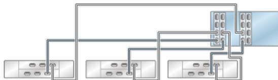
**FIGURE 92** Contrôleur 7420 autonome avec quatre HBA connectés à quatre étagères de disques DE2-24 dans quatre chaînes
