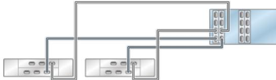
**FIGURE 21** Contrôleur ZS4-4/ZS3-4 autonome avec quatre HBA connectés à trois étagères de disques DE2-24 dans trois chaînes
