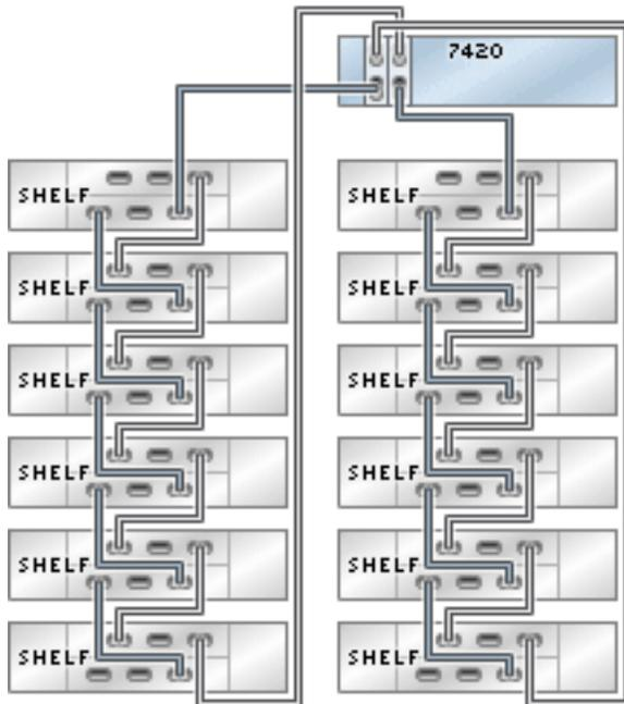
**FIGURE 135** Plusieurs étagères de disques dans une chaîne unique
