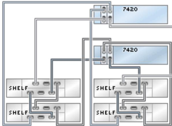
**FIGURE 169** Contrôleurs 7420 en cluster avec deux HBA connectés à 12 étagères de disques DE2-24 dans deux chaînes
