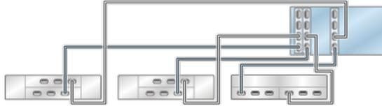
**FIGURE 287** Contrôleurs ZS4-4/ZS3-4 autonomes avec trois HBA connectés à quatre étagères de disques mixtes dans quatre chaînes (DE2-24 affiché à gauche)
