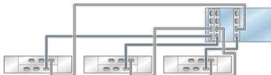
**FIGURE 14** Contrôleur ZS4-4/ZS3-4 autonome avec trois HBA connectés à quatre étagères de disques DE2-24 dans quatre chaînes
