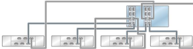
**FIGURE 93** Contrôleur 7420 autonome avec quatre HBA connectés à cinq étagères de disques DE2-24 dans cinq chaînes
