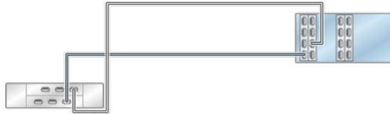
**FIGURE 90** Contrôleur 7420 autonome avec quatre HBA connectés à deux étagères de disques DE2-24 dans deux chaînes
