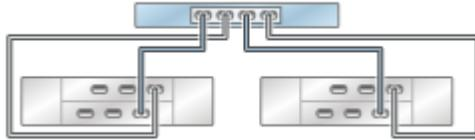
**FIGURE 55** Contrôleur ZS3-2 autonome avec un HBA connecté à six étagères de disques DE2-24 dans deux chaînes
