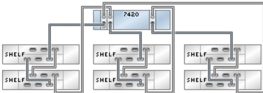
**FIGURE 140** Contrôleur 7420 autonome avec trois HBA connectés à 18 étagères de disques DE2-24 dans trois chaînes
