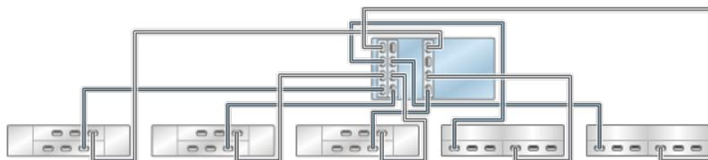
**FIGURE 357** Contrôleurs 7420 autonomes avec trois HBA connectés à six étagères de disques mixtes dans six chaînes (DE2-24 affiché à gauche)
