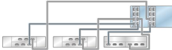
**FIGURE 295** Contrôleurs ZS4-4/ZS3-4 autonomes avec quatre HBA connectés à quatre étagères de disques mixtes dans quatre chaînes (DE2-24 affiché à gauche)
