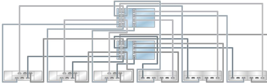
**FIGURE 314** Contrôleurs ZS4-4/ZS3-4 en cluster avec trois HBA connectés à plusieurs étagères de disques mixtes dans six chaînes (DE2-24 affiché à gauche)
