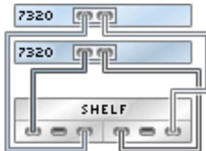
**FIGURE 275** Contrôleurs 7320 en cluster avec un HBA connecté à deux étagères de disques Sun Disk Shelf dans une chaîne unique
