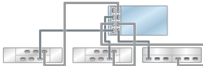
**FIGURE 281** Contrôleurs ZS4-4/ZS3-4 autonomes avec deux HBA connectés à quatre étagères de disques mixtes dans quatre chaînes (DE2-24 affiché à gauche)
