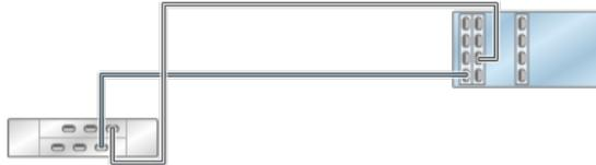
**FIGURE 82** Contrôleur 7420 autonome avec trois HBA connectés à deux étagères de disques DE2-24 dans deux chaînes
