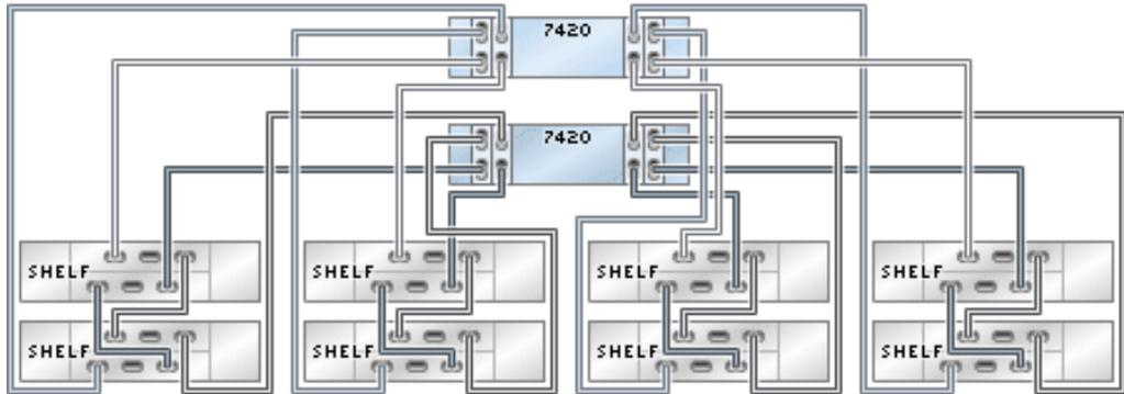
**FIGURE 255** Contrôleurs 7420 en cluster avec quatre HBA connectés à 24 étagères de disques Sun Disk Shelf dans quatre chaînes
