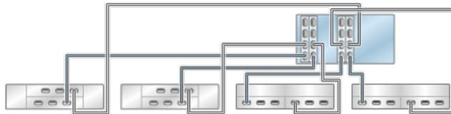
**FIGURE 296** Contrôleurs ZS4-4/ZS3-4 autonomes avec quatre HBA connectés à cinq étagères de disques mixtes dans cinq chaînes (DE2-24 affiché à gauche)
