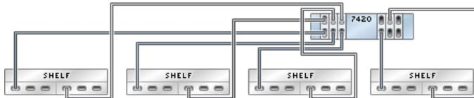
**FIGURE 237** Contrôleur 7420 autonome avec six HBA connectés à cinq étagères de disques Sun Disk Shelf dans cinq chaînes
