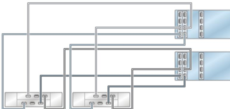
**FIGURE 37** Contrôleurs ZS4-4/ZS3-4 en cluster avec trois HBA connectés à trois étagères de disques DE2-24 dans trois chaînes
