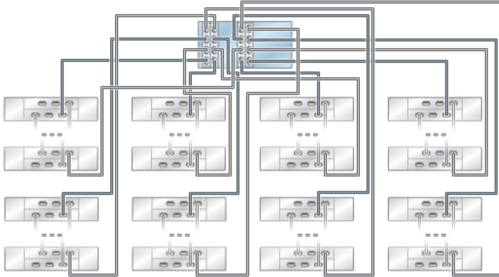
**FIGURE 98** Plusieurs étagères de disques dans une chaîne unique
