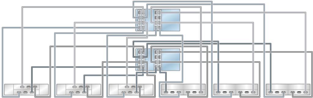
**FIGURE 390** Contrôleurs 7420 en cluster avec quatre HBA connectés à sept étagères de disques mixtes dans sept chaînes (DE2-24 affiché en haut)
