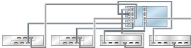
**FIGURE 288** Contrôleurs ZS4-4/ZS3-4 autonomes avec trois HBA connectés à cinq étagères de disques mixtes dans cinq chaînes (DE2-24 affiché à gauche)
