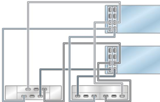
**FIGURE 372** Contrôleurs 7420 en cluster avec deux HBA connectés à trois étagères de disques mixtes dans deux chaînes (DE2-24 affiché à gauche)
