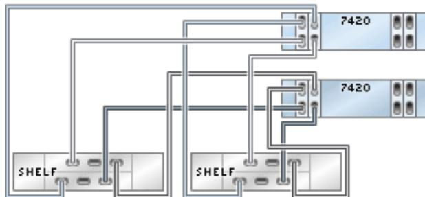
**FIGURE 179** Contrôleurs 7420 en cluster avec quatre HBA connectés à trois étagères de disques DE2-24 dans trois chaînes
