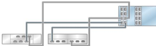
**FIGURE 294** Contrôleurs ZS4-4/ZS3-4 autonomes avec quatre HBA connectés à trois étagères de disques mixtes dans trois chaînes (DE2-24 affiché à gauche)
