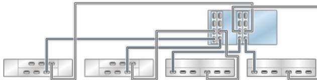
**FIGURE 364** Contrôleurs 7420 autonomes avec quatre HBA connectés à cinq étagères de disques mixtes dans cinq chaînes (DE2-24 affiché à gauche)
