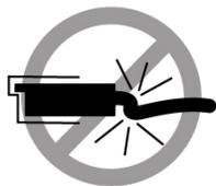
ケーブルを押しつけてケーブルコネクタをソケットに無理に差し込まないでください。抜き差しの際は、コネクタだけに力がかかるようにしてください。
