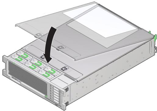
サーバーの上部カバーは冷却サブシステムがサーバー内の圧力領域を維持するうえで役立ちます。また、上部カバーは、内部コンポーネントの損傷や、偶発的な高電圧への暴露からも保護します。このような理由から、サーバーの上部カバーにはサーバー電源の連動スイッチ機能が含まれています。
