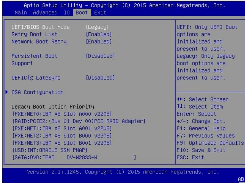
注 - 引导顺序列表中的选项根据存储驱动器配置以及您是否启用了持久性引导支持功能而不同。有关持久性引导支持的更多信息，请参阅《Oracle X5 系列服务器管理指南》，网址为：<http://www.oracle.com/goto/x86AdminDiag/docs>。
