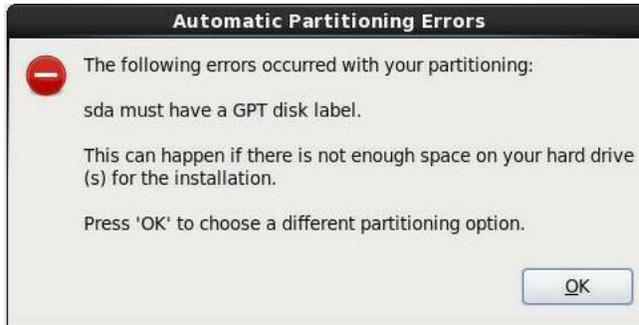
如果显示了上面的屏幕, 则说明您尝试在其中安装 Oracle Linux 的磁盘未正确格式化, 因此需要重新格式化。
