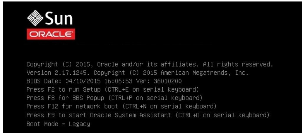
3. 在 BIOS 屏幕中，按 F8 键指定用于安装 Linux OS 的临时引导设备。
