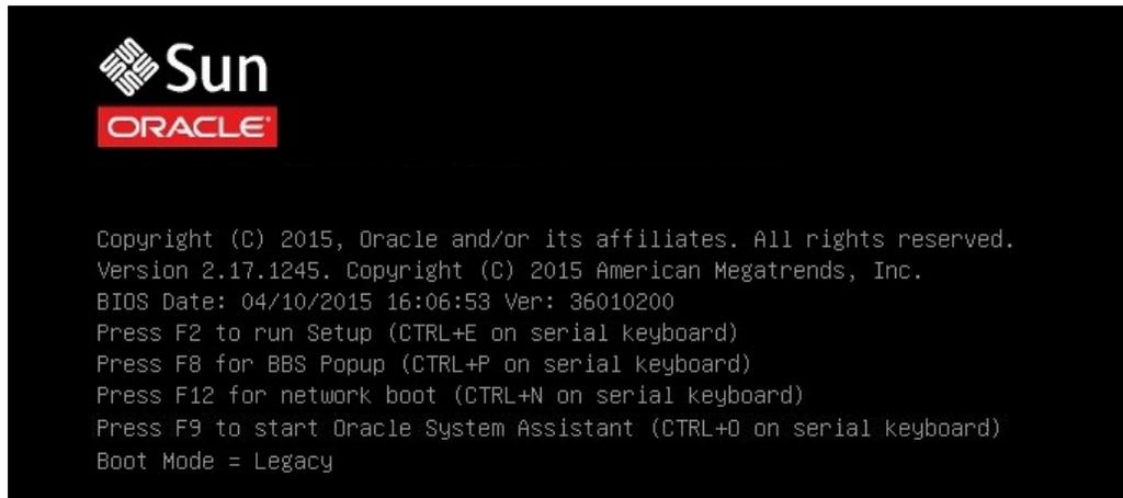
25. 要访问 BIOS 设置实用程序以将服务器设置为从刚安装的操作系统的引导，请按 F2 键。此时将显示 BIOS 设置实用程序屏幕，并且 "Boot Menu" 处于选中状态。此时将显示 BIOS 屏幕并且需要执行操作才能继续安装，具体取决于为 OS 安装选择的 UEFI/BIOS 引导模式。
