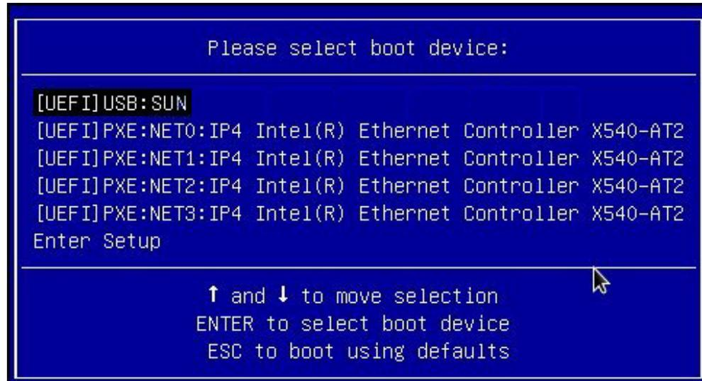
注 - 根据您的服务器中安装的磁盘控制器以及其他硬件（例如 PCIe 网络卡）的类型，在安装期间显示的 "Please Select Boot Device" 菜单可能有所不同。
