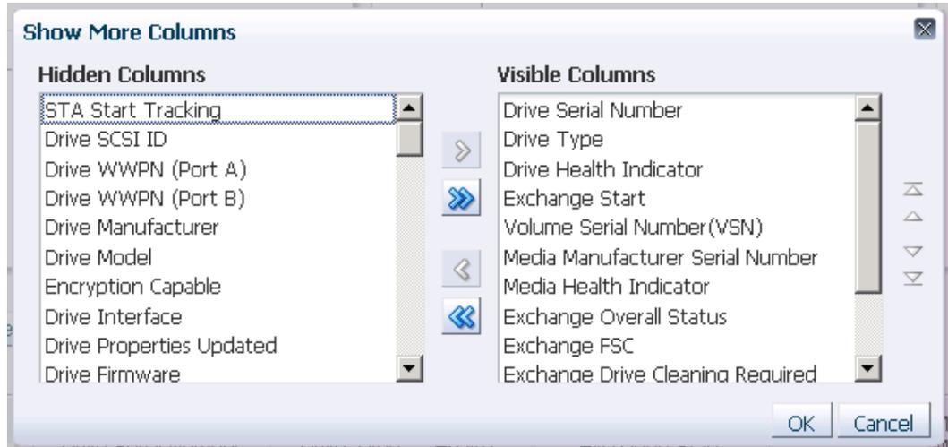
La lista Visible Columns (Columnas visibles) identifica las columnas actualmente incluidas en la tabla y el orden en el que se muestran. La lista Hidden Columns (Columnas ocultas) identifica las columnas que actualmente están ocultas; se las enumera en el orden definido en la plantilla actual.
