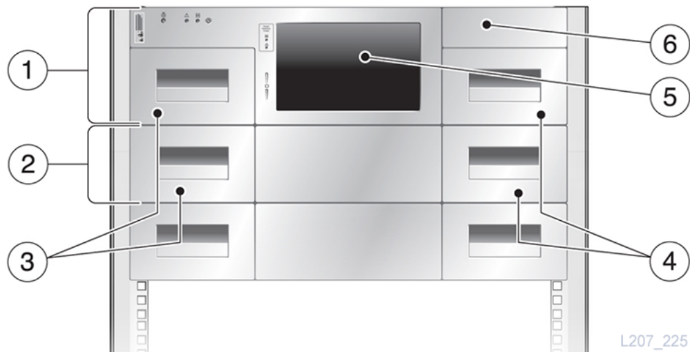
Abbildung 1.1. Grundmodul und Erweiterungsmodule der StorageTek SL150
