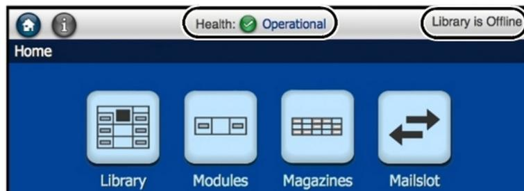
Le panneau opérateur local affiche les mêmes détails relatifs à l'intégrité que l'interface utilisateur à distance, mais sous forme abrégée : un code d'erreur incluant le nom de l'erreur, une liste des composants suspects et l'action recommandée correspondante :
