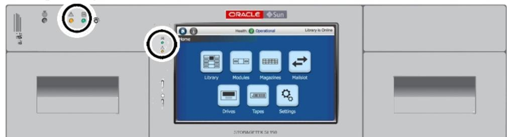
Le panneau arrière de l'unité de base contient également des indicateurs d'intégrité de la bibliothèque. Ils sont situés dans la partie supérieure du panneau arrière un peu à gauche de la partie centrale. D'autres indicateurs affichent le statut des unités remplaçables par l'utilisateur
