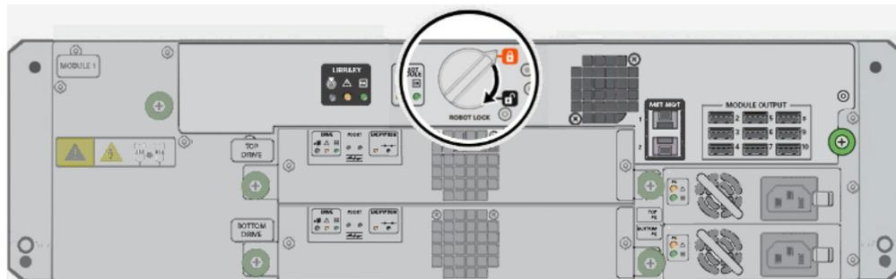
Le robot est déverrouillé lorsque le pointeur du bouton est dirigé vers l'icône noire de cadenas ouvert :
