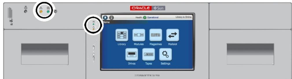
Il pannello posteriore dell'unità di base presenta inoltre indicatori di integrità della libreria posti in alto a sinistra della parte centrale. Altri indicatori mostrano lo stato delle CRU, ad esempio il controller di robot/libreria, gli alimentatori e le unità nastro.
