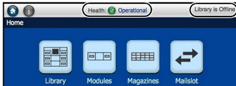
Il pannello operatore locale mostra gli stessi dettagli sull'integrità dell'interfaccia utente remota ma in forma abbreviata, ovvero con un codice di errore che include il nome dell'errore, un elenco di componenti sospetti e l'azione consigliata corrispondente.
