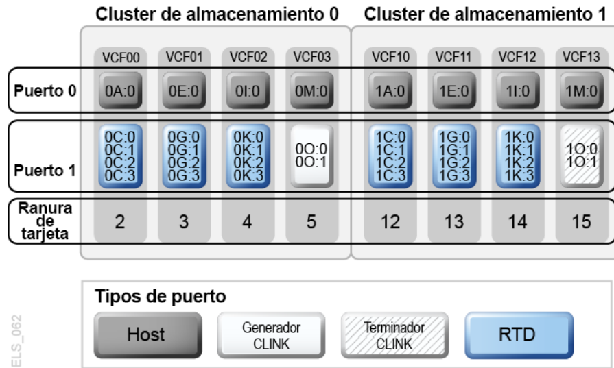
Figura A.4. VSMRP1: VSM5 con 8 tarjetas VCF, 8 puertos de host, directores FICON para 24 RTD, 4 CLINK
