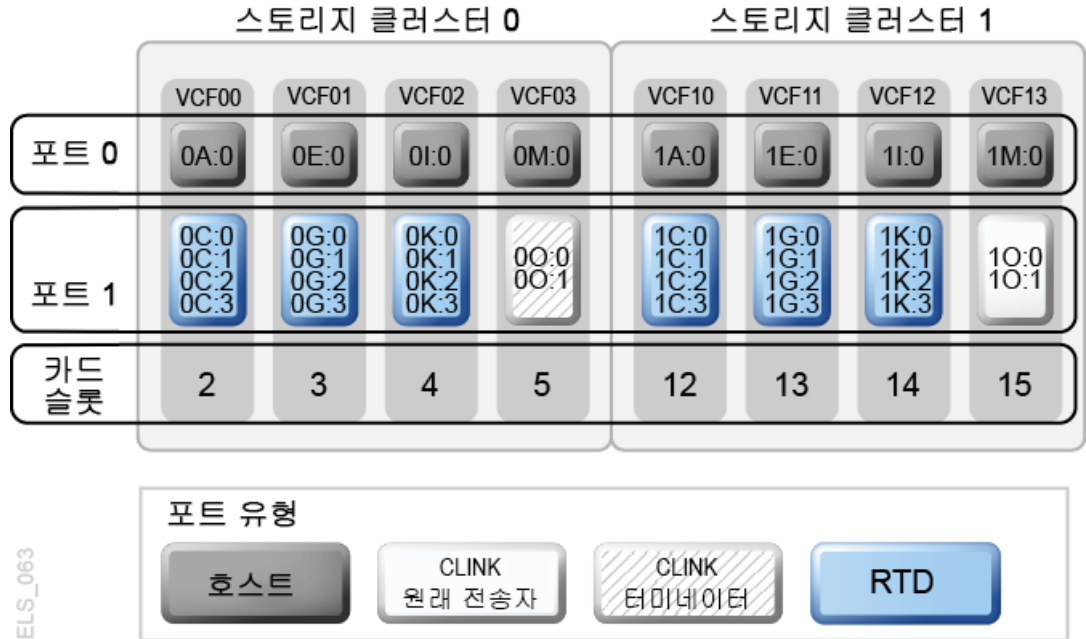
그림 A.5. VSMPR2 - VCF 카드 8개, 호스트 포트 8개, 24개 RTD에 대한 FICON 디렉터, CLINK 4개를 포함하는 VSM5
