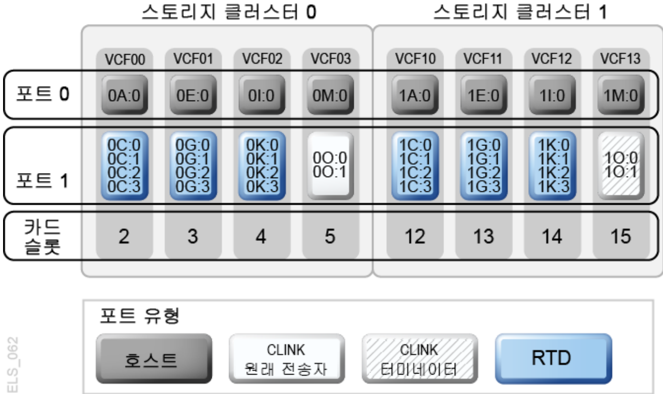
그림 A.5. “VSMPR2 - VCF 카드 8개, 호스트 포트 8개, 24개 RTD에 대한 FICON 디렉터, CLINK 4개를 포함하는 VSM5”에서는 VSMPR1에 대한 CONFIG 채널 인터페이스 식별자, VCF 카드 8개 및 최대 32개의 RTD 기능이 사용으로 설정된 양방향 클러스터의 VSM5를 보여줍니다. 이 구성에서 할당된 항목은 다음과 같습니다.
