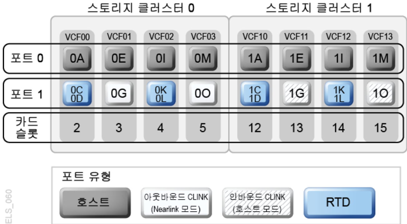
그림 A.2. VCF 카드 8개, 호스트 포트 8개, 8개 RTD에 대한 FICON 디렉터, CLINK 포트 4개를 포함하는 VSM4
