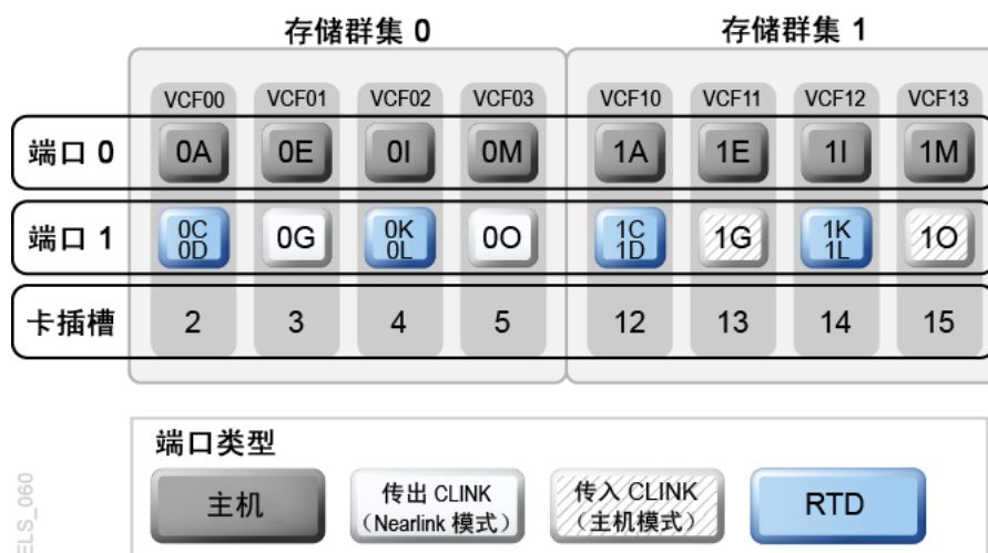
图 A.2. 带有 8 个 VCF 卡、8 个主机端口、8 个 RTD 的 FICON 导向器和 4 个 CLINK 端口的 VSM4
