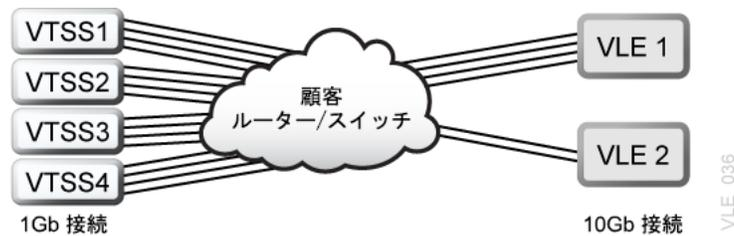
クワッドポート NIC では直接接続が技術的に実現可能でしたが、デュアルポート 10G ビット NIC では不可能になりました。ただし、16 個の 1G ビット接続に必要な帯域幅を 2 つの 10G ビットポートで満たすことができます。そのためには、VLE ポートで 10G ビットのリンク速度と LACP アグリゲーションをサポートするためのネットワークインフラストラクチャーを顧客が用意する必要があります。VTSS 接続と VLE ポートが異なるサブネット上にある場合は適切なルーティングも必要です。
