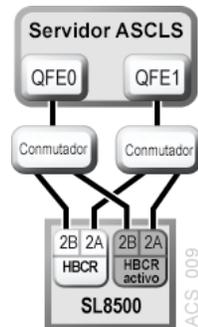
**Figura B.10. RE con TCP/IP dual y TCP/IP múltiple**
