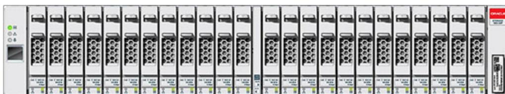
Oracle Storage Drive Enclosure DE2-24P 是支持 24 个 2.5" SAS-2 驱动器的 2U 机箱。高性能 HDD 提供可靠的存储，SSD 提供加速的写入操作。此磁盘机框的主要特征为双冗余 I/O 模块 (I/O Module, IOM) 和具有风扇模块的双电源。
