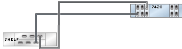
그림 150 독립형 7420 컨트롤러의 HBA 5개가 DE2-24 Disk Shelf 2개에 2줄 체인으로 연결 됨
