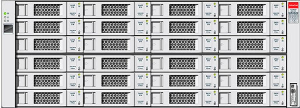
Oracle Storage Drive Enclosure DE2-24C는 24 3.5" SAS-2 드라이브를 지원하는 4U 새시입니다. SSD는 빨라진 쓰기 작업을 제공하며, 고성능 HDD는 안정적인 스토리지를 제공합니다. 이 Disk Shelf는 이중 예비 IOM(I/O 모듈) 및 팬 모듈이 포함된 이중 전원 공급 장치를 제공합니다.
