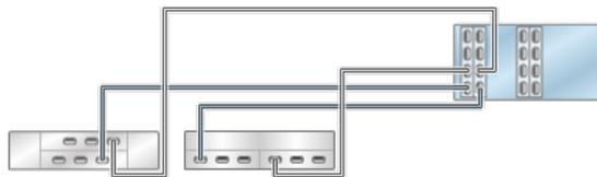
**FIGURE 362** Contrôleurs 7420 autonomes avec quatre HBA connectés à trois étagères de disques mixtes dans trois chaînes (DE2-24 affiché à gauche)
