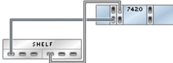
**FIGURE 216** Contrôleur 7420 autonome avec trois HBA connectés à deux étagères de disques Sun Disk Shelf dans deux chaînes
