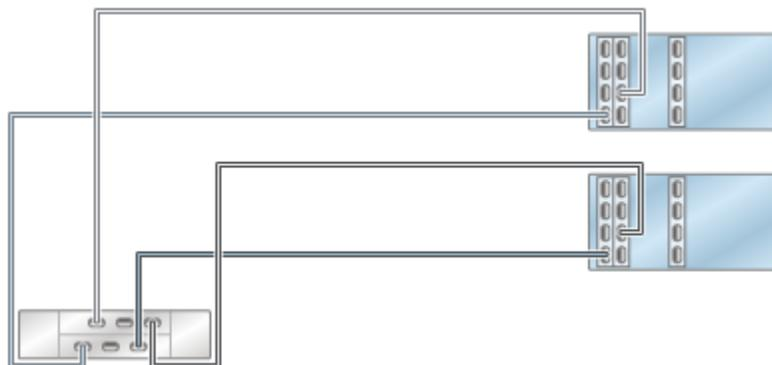
**FIGURE 106** Contrôleurs 7420 en cluster avec trois HBA connectés à deux étagères de disques DE2-24 dans deux chaînes
