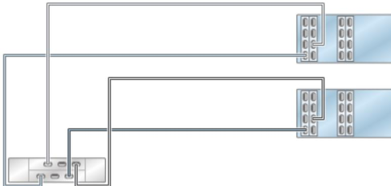
**FIGURE 114** Contrôleurs 7420 en cluster avec quatre HBA connectés à deux étagères de disques DE2-24 dans deux chaînes
