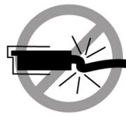
ケーブルを押しつけてケーブルコネクタをソケットに無理に差し込まないでください。抜き差しの際は、コネクタだけに力がかかるようにしてください。
