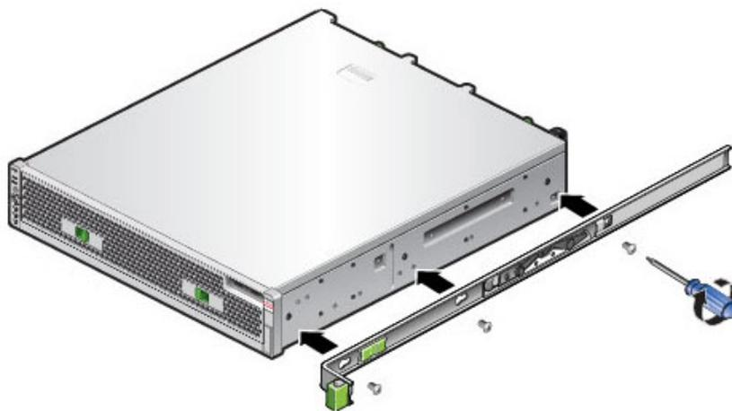
2. 下图显示了如何连接 7x20 装配托架。
