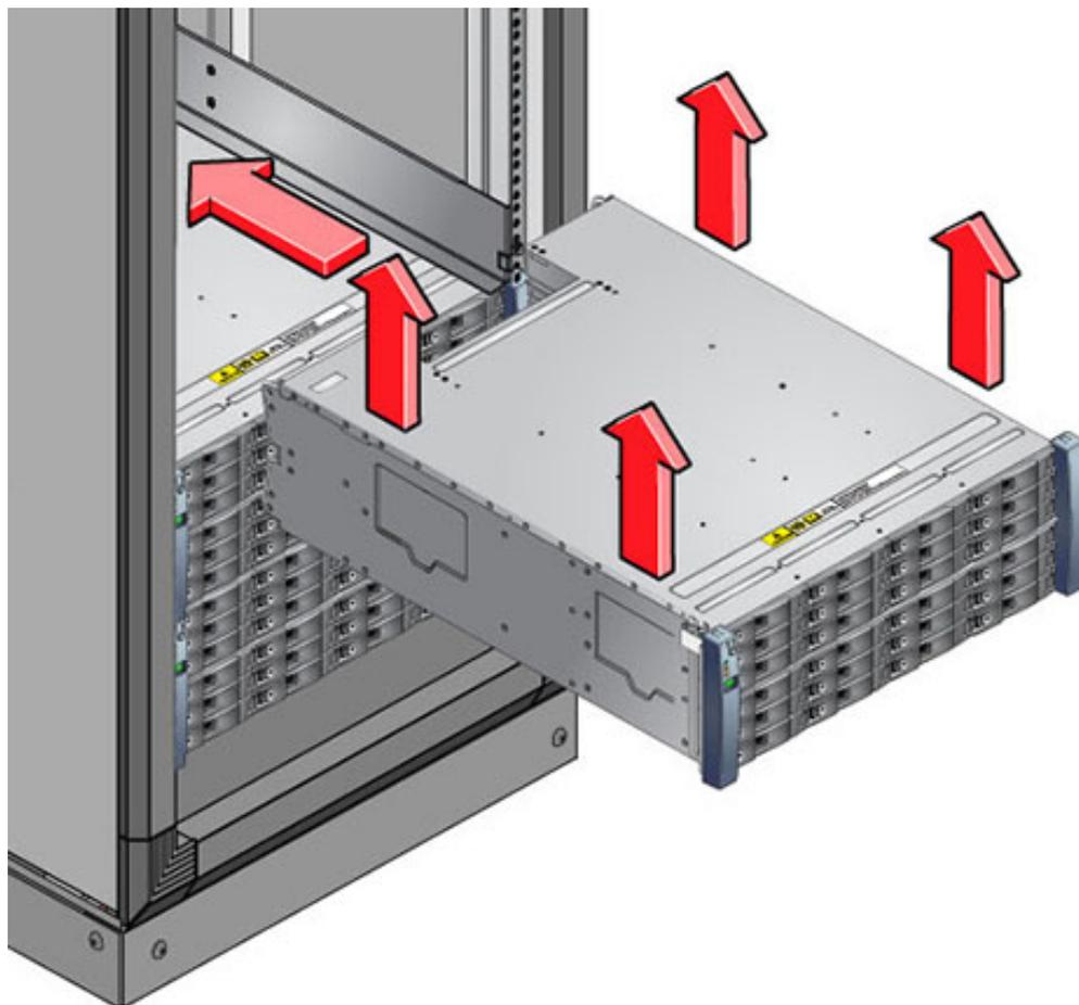
9. 小心地将机框滑入机柜。请确保该机框完全固定在滑轨中。如果要卸下机框，以便于重新安放，请始终托住它。
