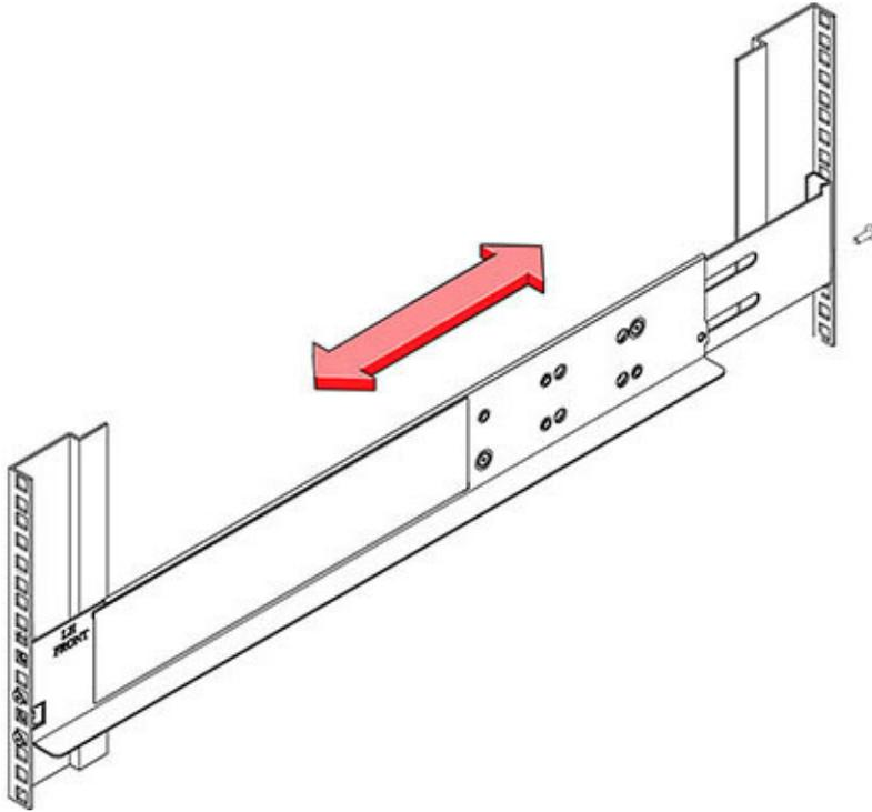
6. 将一颗螺丝穿过机架，安装到每个滑轨的背面。
