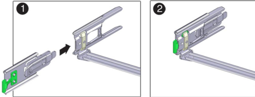
11. 在滑轨锁定托架就位后，将连接器 D 及其关联的滑轨锁定托架插入左侧滑轨，直至连接器 D 在发出“咔嗒”一声后锁定到位（方框 1 和 2）。
