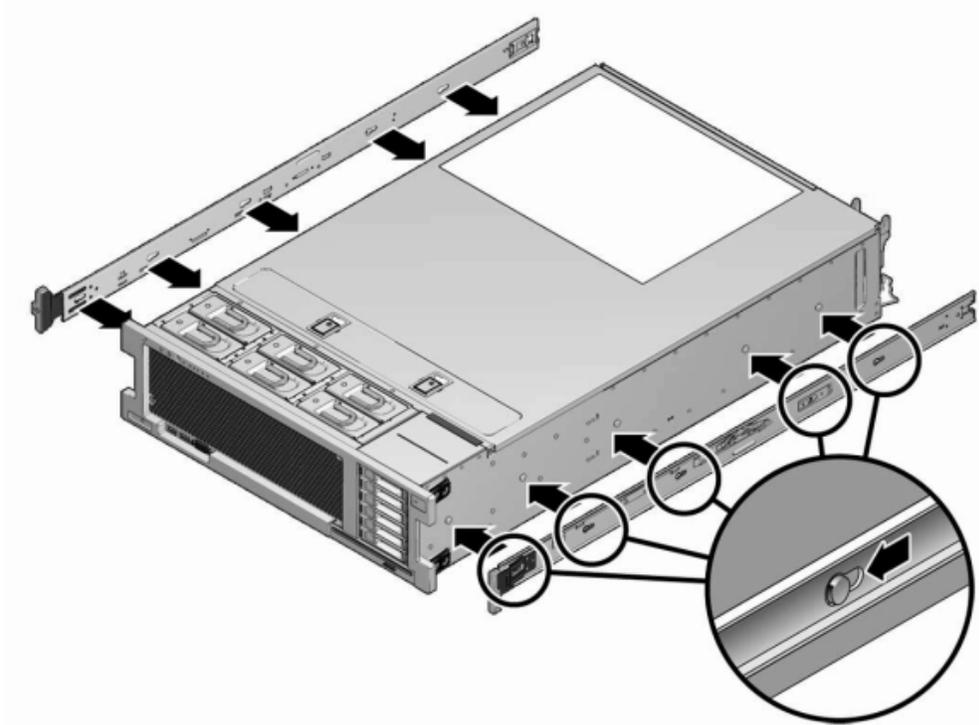
3. 将四个机箱定位销的前端伸出装配托架上的四个锁定开口，然后将装配托架向机箱前部拉，直至装配托架夹发出“咔嚓”一声后锁定到位。
