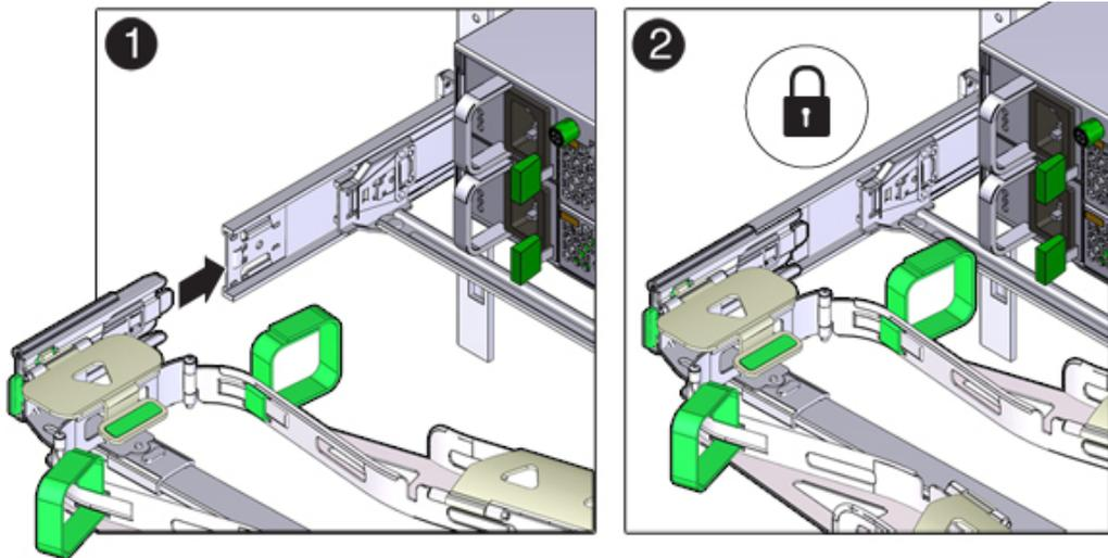
12. 轻轻地拉一下 CMA 后滑杆的左侧边缘，确保连接器 D 已正确固定。
