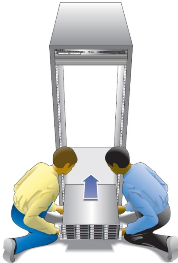
7. 小心地将机框滑入机柜，直到机框的正面外缘接触到机架的垂直面。
