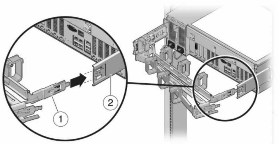
3. 将右侧的 CMA 滑轨连接器 (1) 插入右侧滑轨装置 (2)，直到连接器锁定到位。
