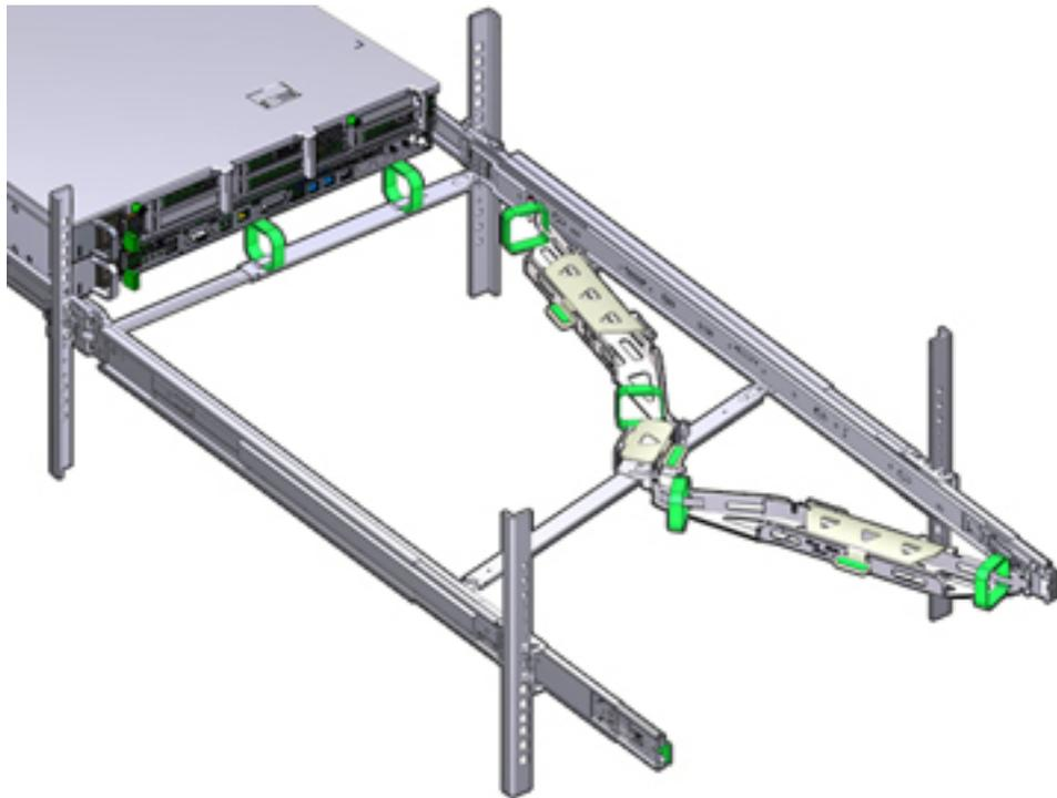
15. 将存储控制器推回机架中。将存储控制器推到机架中时，检验 CMA 是否缩回且无缠绕。
