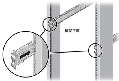
注 - 滑轨可与 9.5-mm 方形或 M6 圆形安装孔机架一起使用。
