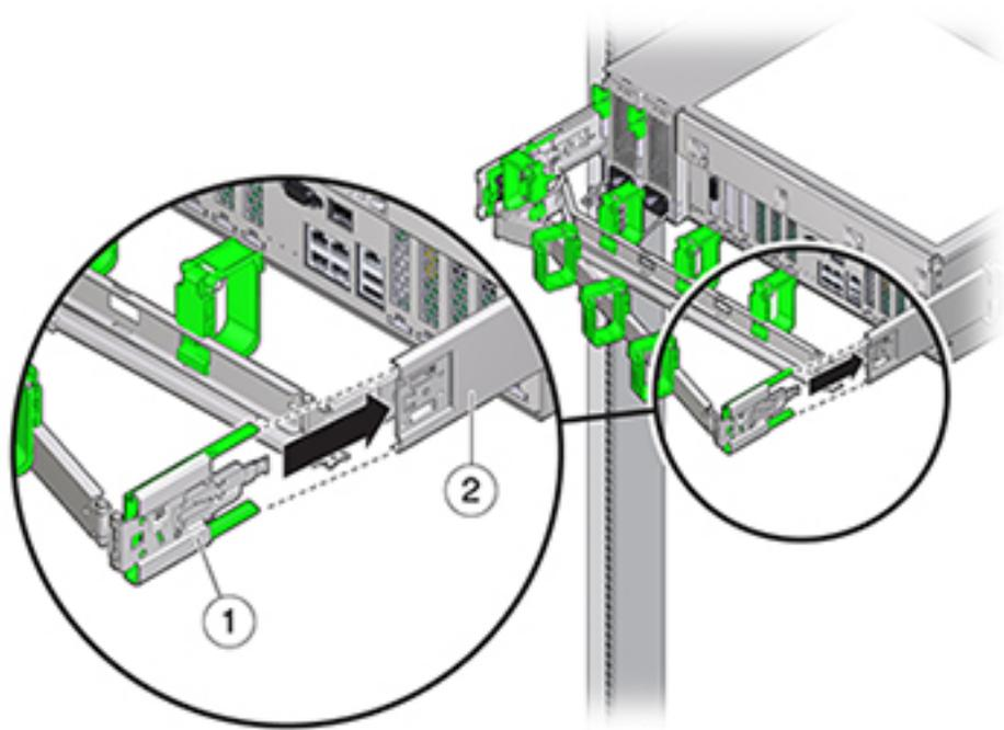
3. 将左侧的 CMA 滑轨连接器插入左侧滑轨装置，直到连接器发出“咔嗒”一声后锁定到位。
