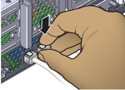
2. 用拇指和中指轻轻向下压，同时将插头从端口中拔出。请勿将插头向上拔或用手指将释放卡舌拧到插头下方，如下所示。
