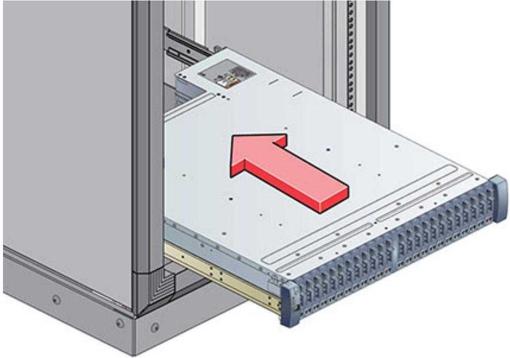
5. 小心地将机框滑入滑轨，直至该机框完全固定在机柜中。观察员应使用手电筒，确保该机框完全固定在滑轨中。如果要卸下机框，以便于重新安放，请始终托住它。
