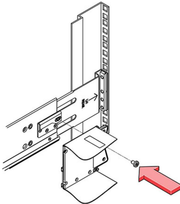
7. 卸下前侧保护套，分别将一颗螺丝安装到前侧每一端，然后重新装上保护套。
