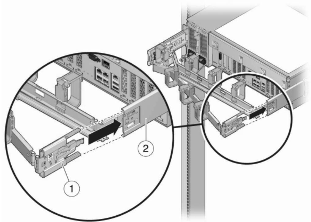
4. 将左侧的 CMA 滑轨连接器 (1) 插入左侧滑轨装置 (2) 中的滑轨延伸杆，直到连接器锁定到位。
