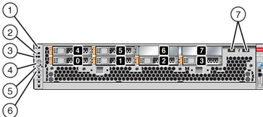
驱动器插槽 0 和 1 有两个镜像的 SAS-2 引导驱动器。最多将四个读高速缓存 SSD 按顺序安装在插槽 2 到插槽 5 中。插槽 6 和插槽 7 为空，且必须包含驱动器填充面板。有关支持的 HDD 和 SSD 的信息，请参见 [Oracle 系统手册](#)。
