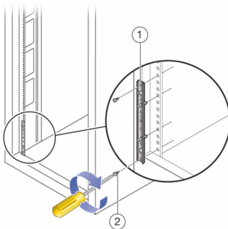
4. 安装每个滑轨，方法是，先将机架转接板的正面定位销与滑轨正面相应的孔对齐，然后调整滑轨使其适合机架尺寸，再将机架转接板上的背面定位销插入到滑轨相应的孔中。
