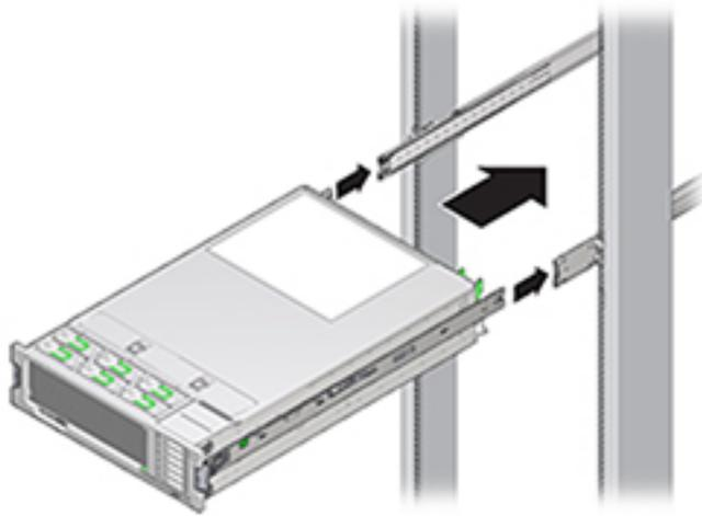
5. 将控制器推入机架时，按住每个装配托架上的绿色滑轨释放按钮。继续推，直至滑轨锁在发出“咔嗒”一声后（在装配托架前面）与滑轨装置啮合。
