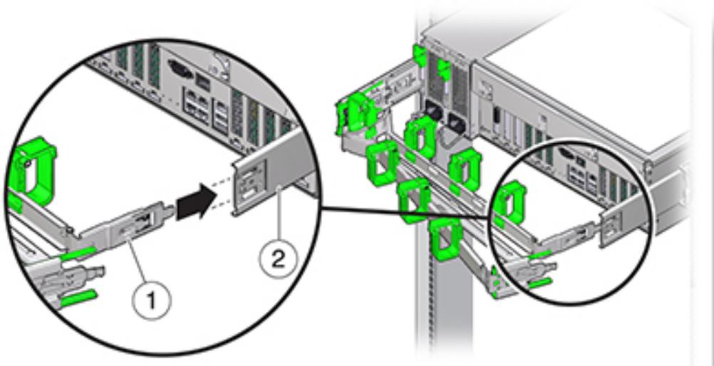
2. 将右侧的 CMA 滑轨连接器 (1) 插入右侧滑轨装置 (2)，直到连接器发出“咔嗒”一声后锁定到位。
