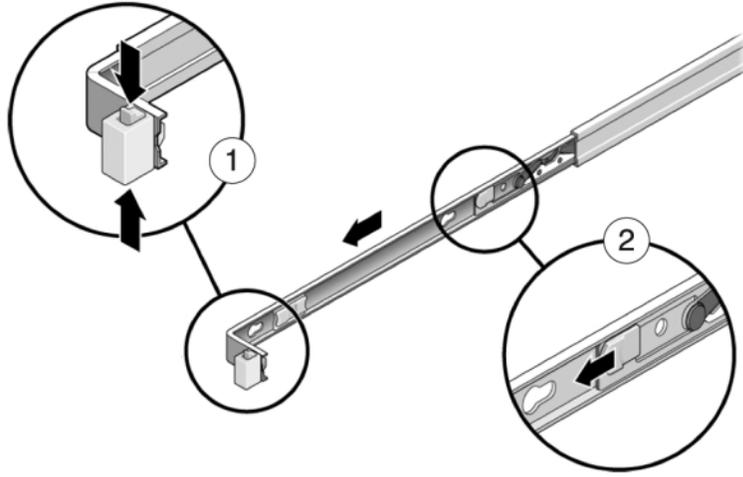
例 2 拆卸 7420 滑轨套件
