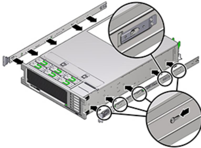
2. 将五个机箱定位销的前端伸出装配托架上的五个锁定开口，然后将装配托架向机箱前部拉，直至装配托架夹发出“咔嗒”一声后锁定到位。
