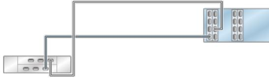
그림 20 독립형 ZS4-4/ZS3-4 컨트롤러의 HBA 4개가 DE2-24 Disk Shelf 2개에 2줄 체인으로 연결됨
