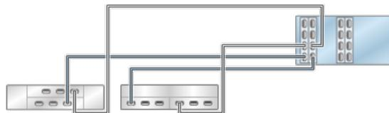
그림 294 독립형 ZS3-4 컨트롤러의 HBA 4개가 혼합 Disk Shelf 3개에 3줄 체인으로 연결됨 (DE2-24가 왼쪽에 표시)
