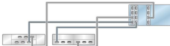
그림 286 독립형 ZS3-4 컨트롤러의 HBA 3개가 혼합 Disk Shelf 3개에 3줄 체인으로 연결됨 (DE2-24가 왼쪽에 표시)
