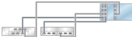
그림 354 독립형 7420 컨트롤러의 HBA 3개가 혼합 Disk Shelf 3개에 3줄 체인으로 연결됨 (DE2-24가 왼쪽에 표시)
