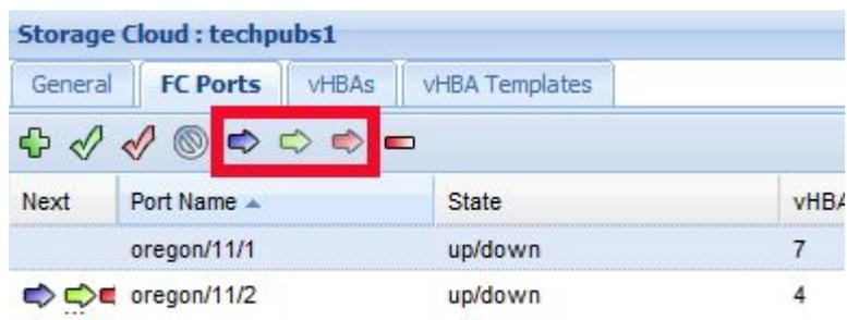
"FC Ports" (FC 端口) 工具栏包含以下用于设置端口优先级的按钮。
