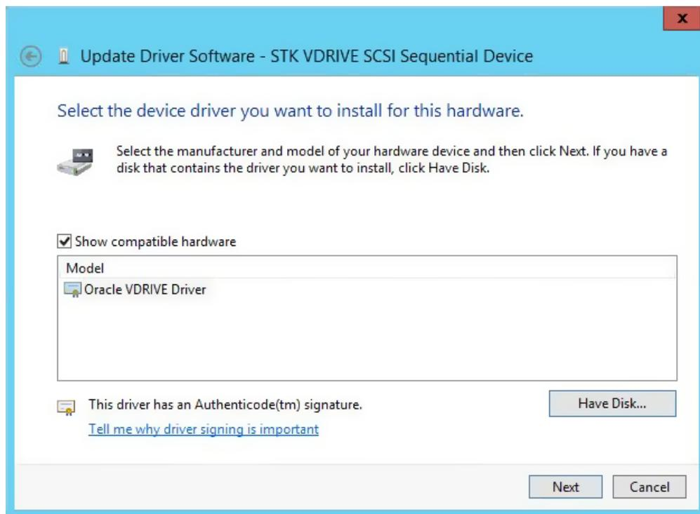
8. 使用设备管理器，单击 *Tape Drives*（磁带机）选项卡并选择下一个驱动器。右键单击该驱动器并选择 *Update Driver*（更新驱动程序）。
