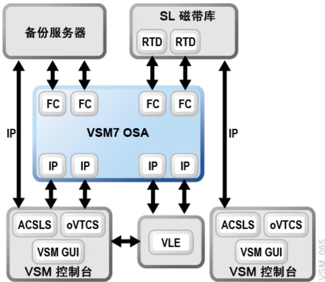
OSA 将 VTV 迁移和撤回到与光纤通道相连的 T10KC 和 T10KD 磁带机。OSA 使用增强复制功能创建在其他 VSM 系统之间同步的 VTV 副本。
