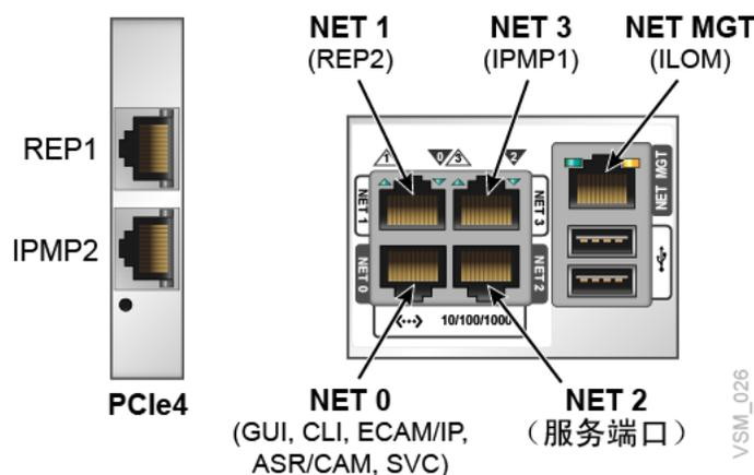
网络端口（NET0、NET1、NET2）通过两台 ES1-24 交换机连接到各种网络：
