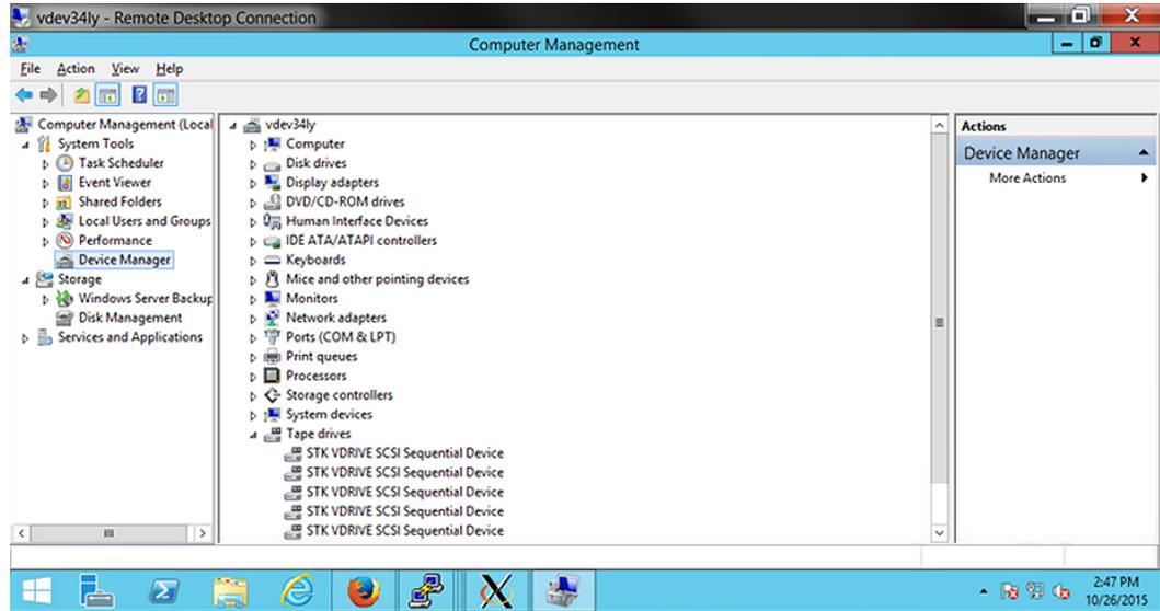
9. 重新引导服务器。启动设备管理器并验证所有的 VDRIVE 是否均列在 *Tape Drives* (磁带机) 下面。
