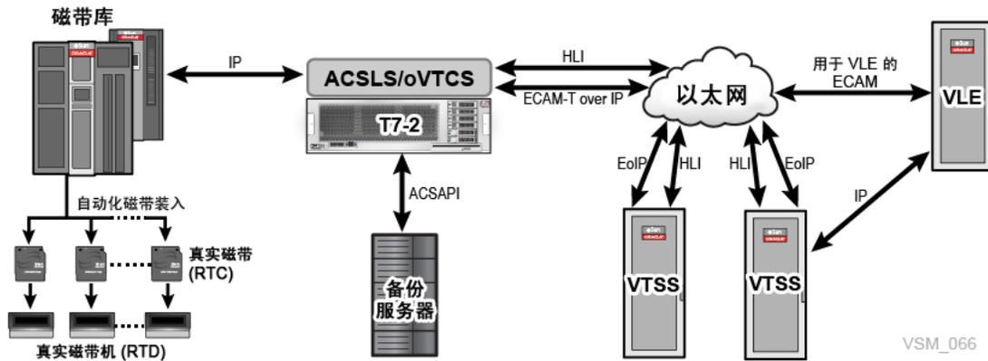
在安装和配置 VSM 7 OSA 之后，备份应用程序的介质服务器和主服务器发现 OSA 的虚拟磁带组件，就如同它们是实际的磁带库、磁带机和磁带一样。备份应用程序服务器与 ACSLS 进行交互，以发现由 VTSS 呈现的虚拟磁带库 (virtual library, VLIB)。备份应用程序随后审计 VLIB 以发现 VLIB 中存在的虚拟磁带机 (virtual tape drive, VTD) 和 VTV。
