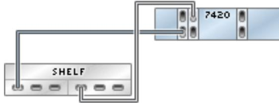
図 336 2つのチェーン内で Sun Disk Shelf 2 台に接続された HBA 3 基を搭載するスタンドアロン 7420 コントローラ
