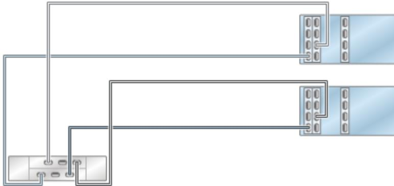
図 226 2つのチェーン内で DE2-24 ディスクシェルフ 2 台に接続された HBA 3 基を搭載するクラスタ化 7420 コントローラ
