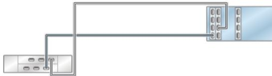
図 202 2つのチェーン内で DE2-24 ディスクシェルフ 2 台に接続された HBA 3 基を搭載するスタンドアロン 7420 コントローラ
