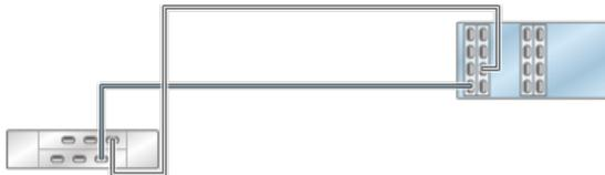
図 210 2つのチェーン内で DE2-24 ディスクシェルフ 2 台に接続された HBA 4 基を搭載するスタンドアロン 7420 コントローラ
