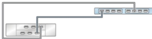
図 178 2つのチェーン内で DE2-24 ディスクシェルフ 2 台に接続された HBA 2 基を搭載するスタンドアロン ZS3-2 コントローラ
