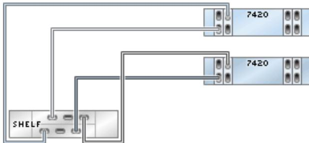
図 298 2つのチェーン内で DE2-24 ディスクシェルフ 2 台に接続された HBA 4 基を搭載するクラスタ化 7420 コントローラ
