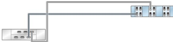
図 278 2つのチェーン内で DE2-24 ディスクシェルフ 2 台に接続された HBA 6 基を搭載するスタンドアロン 7420 コントローラ
