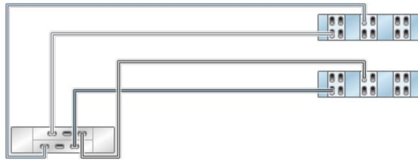
**図 313** 2つのチェーン内で DE2-24 ディスクシェルフ 2 台に接続された HBA 6 基を搭載するクラスタ化 7420 コントローラ
