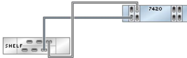
図 263 2つのチェーン内で DE2-24 ディスクシェルフ 2 台に接続された HBA 4 基を搭載するスタンドアロン 7420 コントローラ
