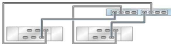
図 179 3つのチェーン内で DE2-24 ディスクシェルフ 3 台に接続された HBA 2 基を搭載するスタンドアロン ZS3-2 コントローラ
