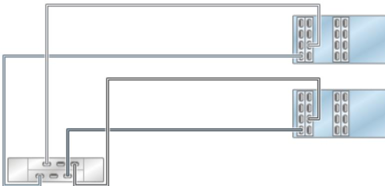
**図 234** 2つのチェーン内で DE2-24 ディスクシェルフ 2 台に接続された HBA 4 基を搭載するクラスタ化 7420 コントローラ
